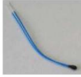
الشكل ( 1 - 13 ) مقاومات نوع P.TC , N.T.C
