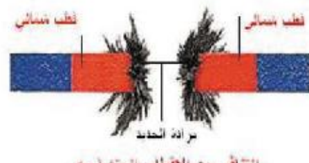
الشكل ( 19 - 2 ) التجاذب والتنافر بين الاقطاب المغناطيسية
