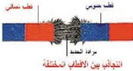
الشكل ( 19 - 2 ) التجاذب والتنافر بين الاقطاب المغناطيسية
