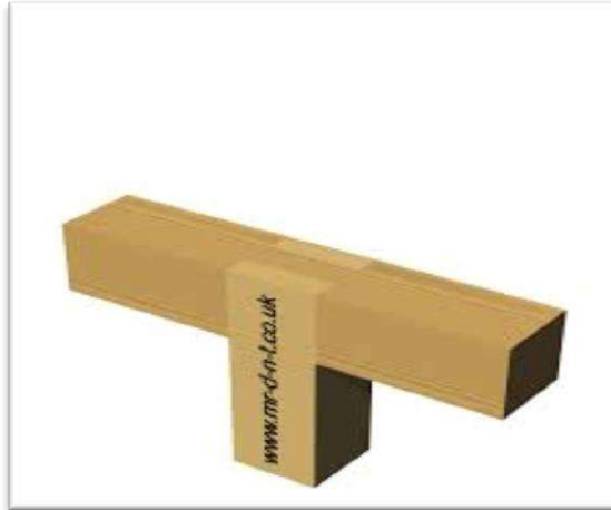
شكل (٣-٣) يوضح تعشيقة نصف على نصف حرف (T)
