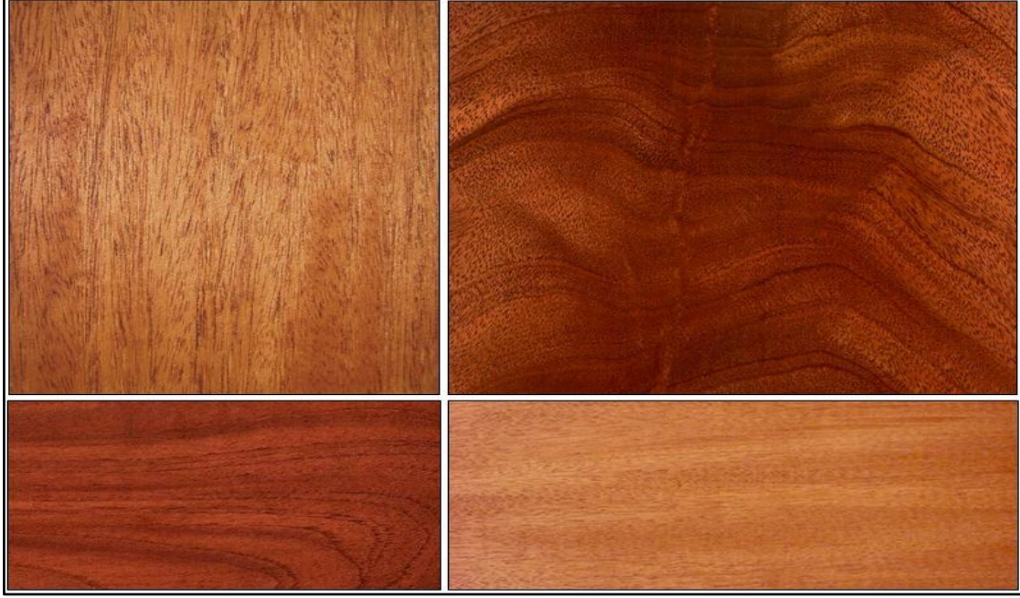
شكل رقم (3-10) مقاطع متنوعة توضح التكوين الشكلي لخشب الماهوجني
