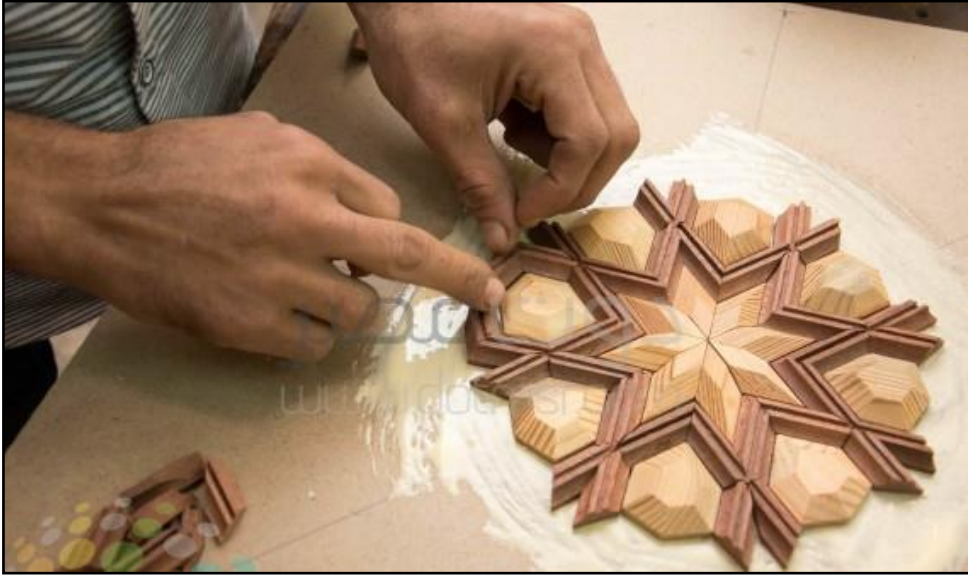
شكل رقم (3-12) يظهر إحدى خطوات تطعيم الخشب
