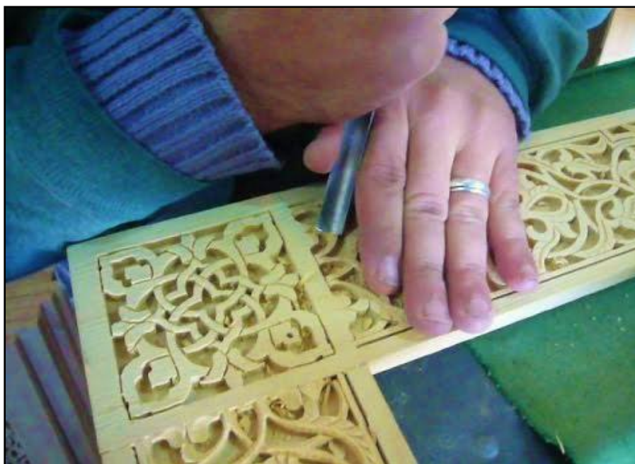
شكل رقم (3-14) يوضح طريقة الحفر على الخشب
