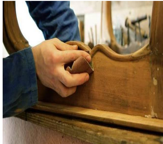
شكل (3-23) يوضح عملية التنعيم والانهاء السطحي لأثاث من مادة الخشب
