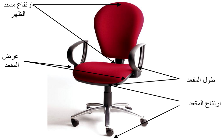
شكل (2-5) يوضح الحسابات الأساسية لتصميم الكرسي
