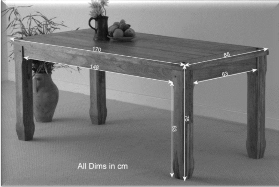
شكل (58-6) يوضح مقاسات منضدة ذات استخدامات مختلفة (طعام-جانبية)
