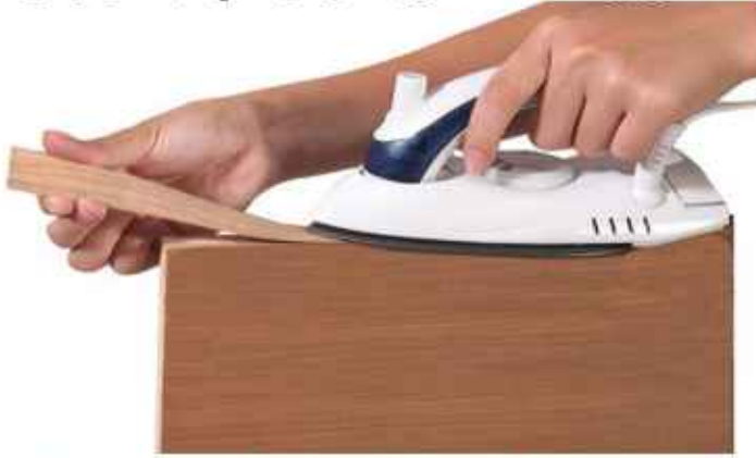
شكل (4 - 17) يبين كيفية لصق القشرة بوساطة المكواة الحرارية
