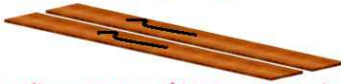
شكل (1 - 41) يوضح كيفية تحديد وجه وجوانب القائمتين
