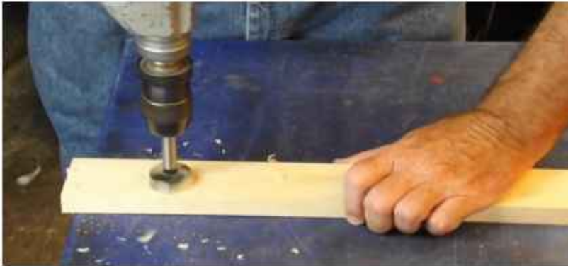
الشكل (5 - 8) يبين لنا كيفية عمل نقب المفصلات
