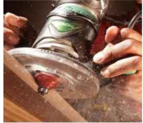
شكل (2 - 14) يبين رأس الحلية وحركة الماكينة
