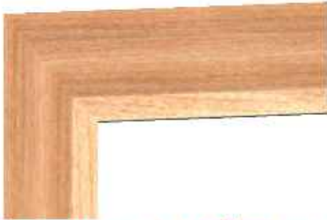
شكل (2 - 3) يبين كيفية اتصال الرؤوس على زاوية 45
