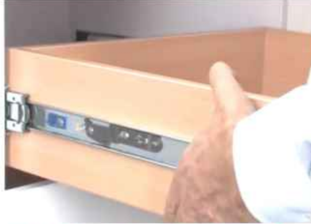
الشكل (3 - 44) يوضح تركيب الجرار التلقائي داخل الكومودي
