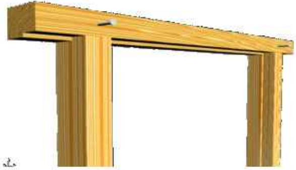
شكل (1 - 11 أ) يبين كيفية تجميع الإطار
