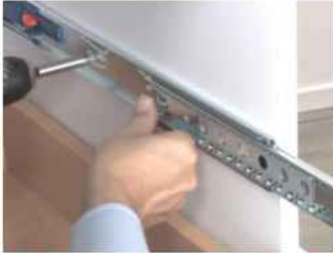
الشكل (3 - 42) يوضح كيفية تركيب جزء السكة المعدنية داخل الكومدي على الجوانب
