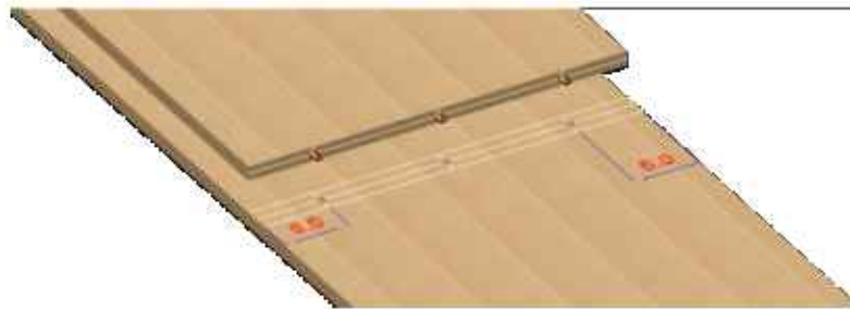
شكل (4 - 6) يبين كيفية تأشير أماكن اللبابيب وتطبيعها
