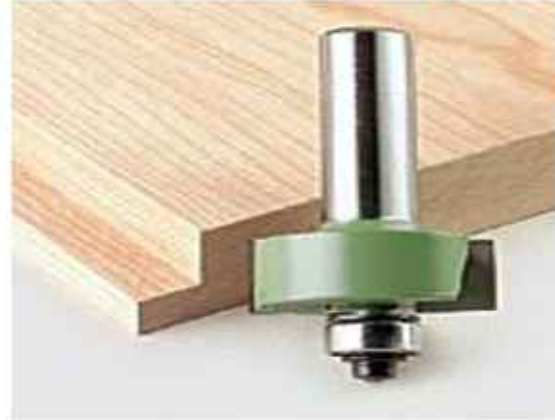
الشكل (5 - 10) يبين لنا رأس التفريز وشكل الفرز الذي يتم بوساطته
