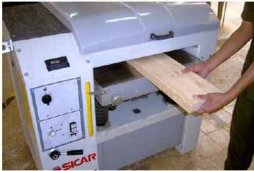
شكل (1 - 4) يبين كيفية ضبط السمك
