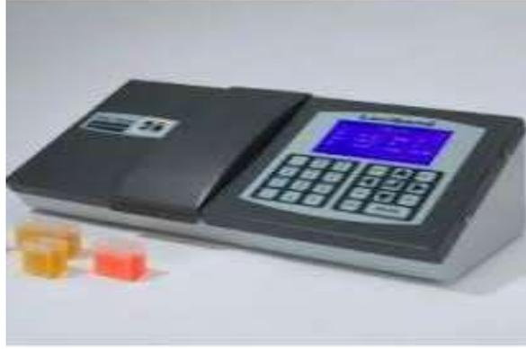
الشكل (7-4) جهاز قياس اللون للمشتقات النفطية
