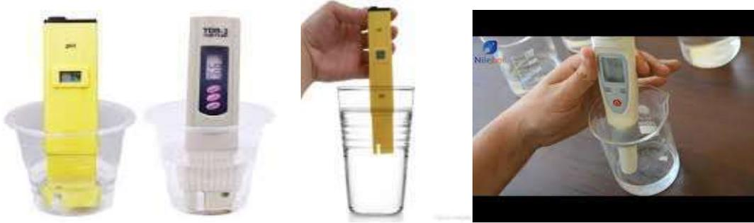
شكل ( 3-7 ) طريقة قياس الحامضية بالجهاز اليدوي
