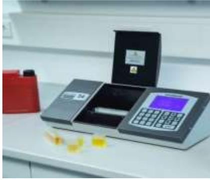
شكل (4-11) جهاز قياس اللون وعلب النماذج
