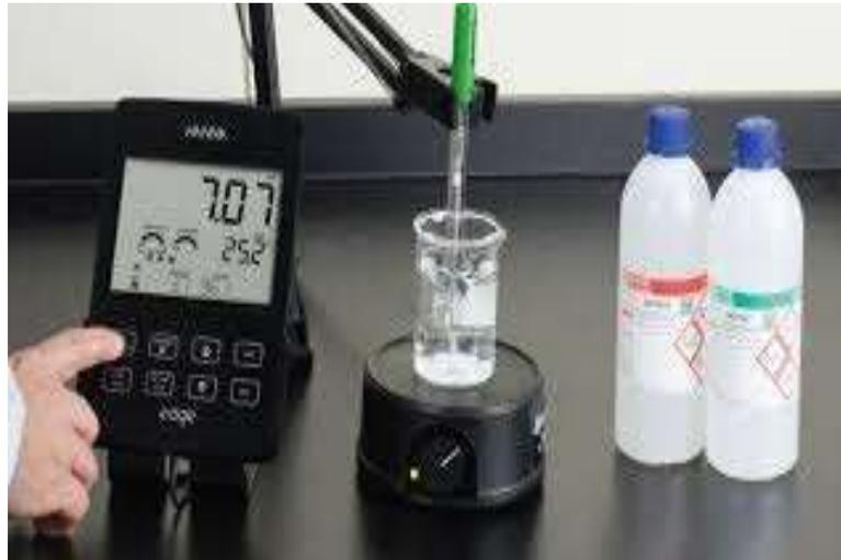
شكل رقم (3-5) قياس محلول البفر (القياسي)
