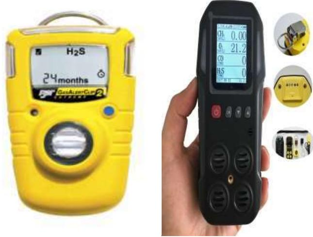
شكل (1-28) أجهزة الكشف عن غاز كبريتيد الهيدروجين
