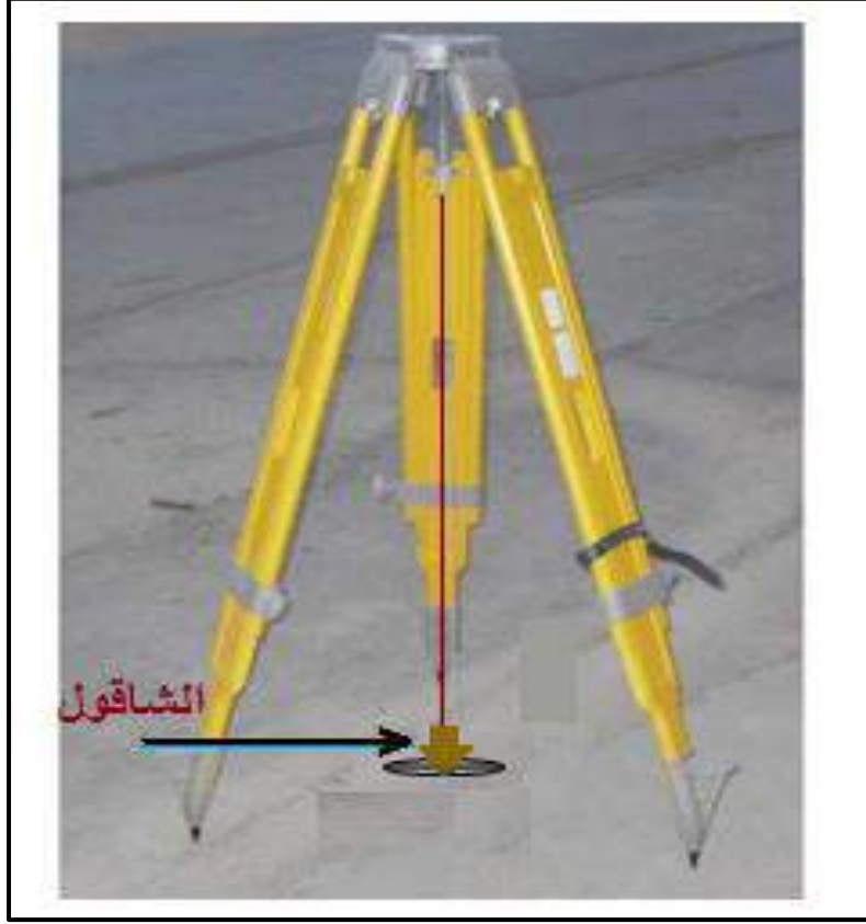
الشكل (6 - 21) نصب الركيزة على نقطة التسامت
