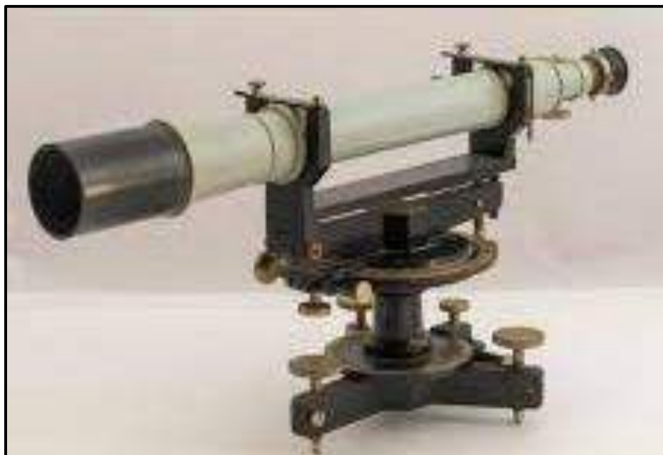
الشكل (3-5) جهاز التسوية نوع واي Wye Level
