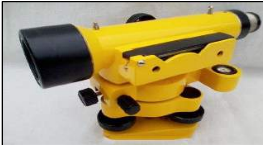
الشكل (6-5) جهاز التسوية الميال Tilting Level
