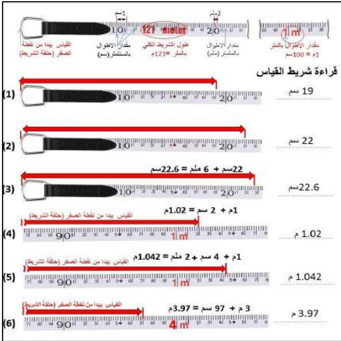
الشكل (10-1) قراءة تقسيمات شريط القياس بالنظام المتري
