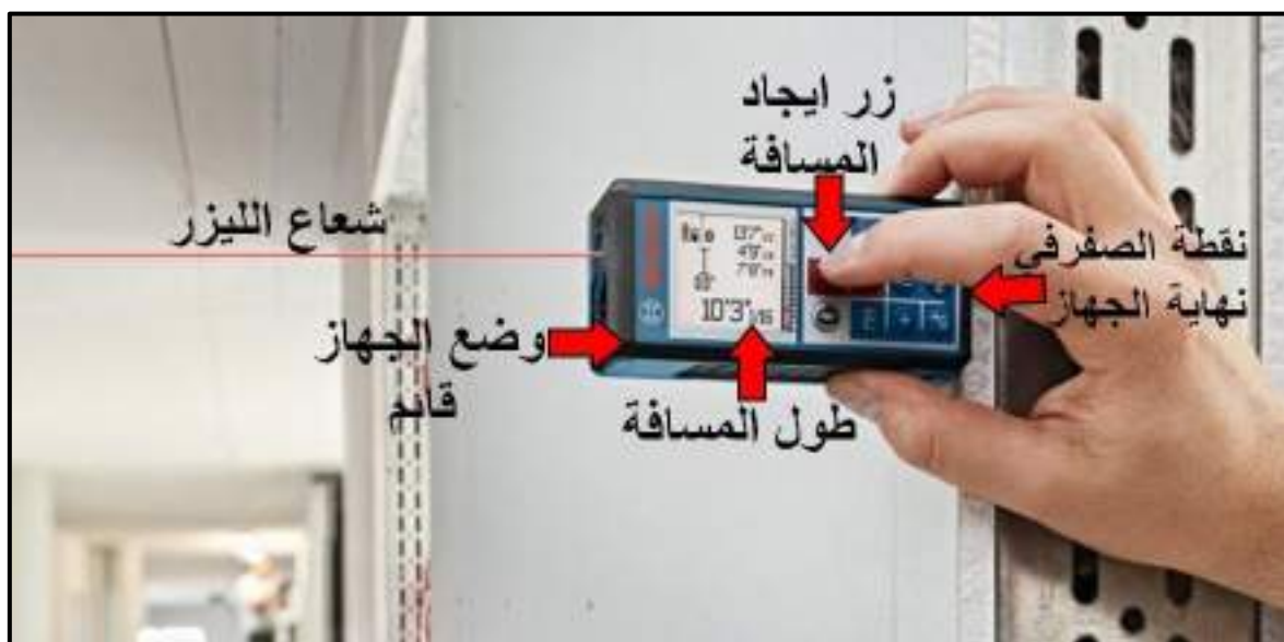
الشكل (27-1) طريقة القياس باستخدام شريط القياس الرقمي الليزري
