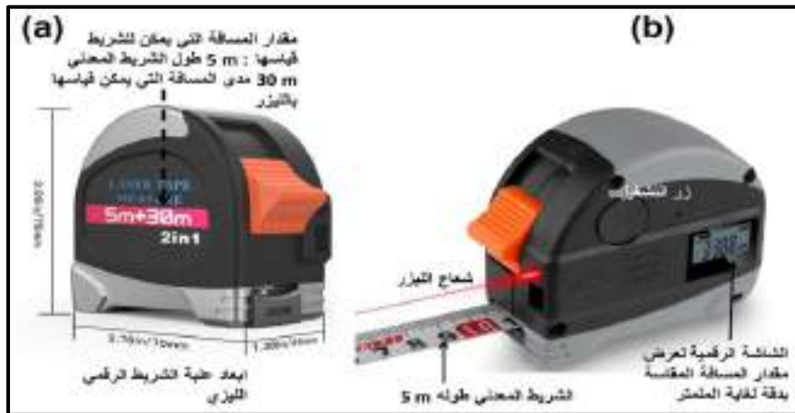
الشكل (6-1) شريط القياس الرقمي : (a) ابعاد علبة الشريط , (b) اجزاء الشريط
