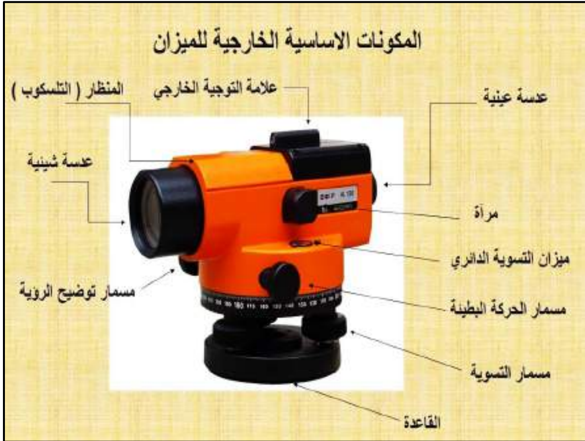
الشكل (9-5) اجزاء التلسكوب وملحقاته لجهاز الميزان
