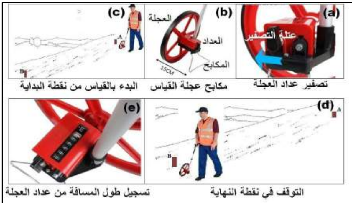
الشكل (1-25) خطوات قياس المسافة باستخدام عجلة القياس
