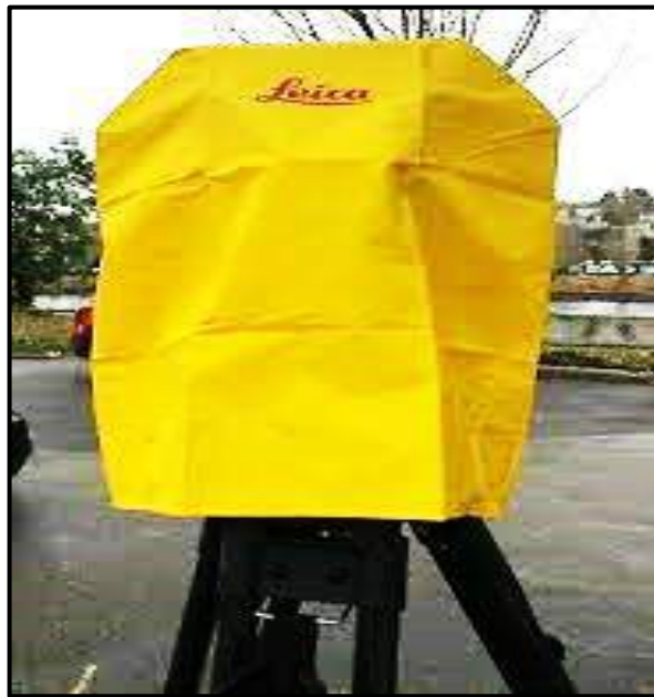
الشكل (2-4) يوضح كيفية استخدام واقي المطر لأجهزة المساحة
