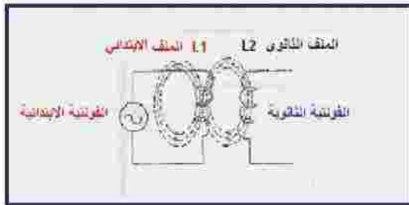
الشكل ( 2 - 25 ) يوضح خاصية الحث المتبادل
