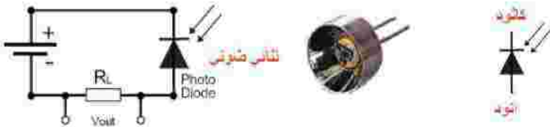
الشكل ( 36 - 4 ) رمز الثنائي الضوئي وشكله واستخدامه في دائرة الكترونية
