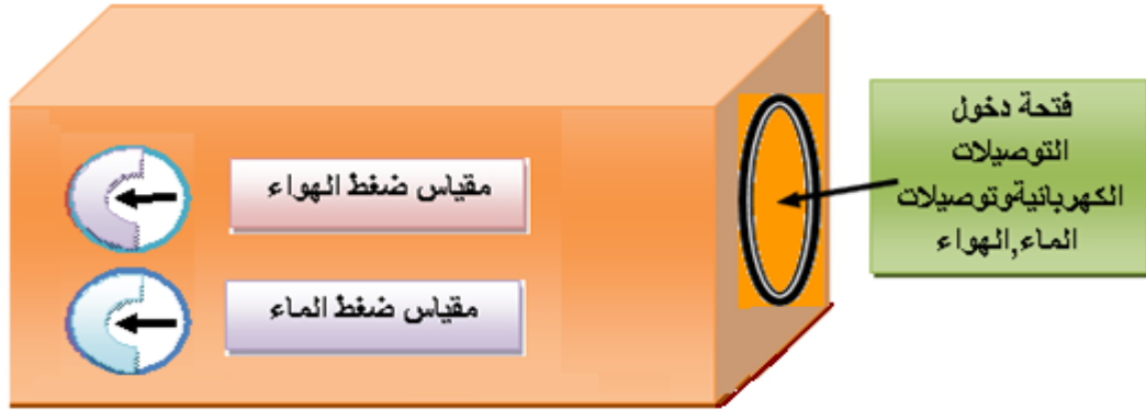
شكل 7 - 28 يوضح الشكل الخارجي لوحدة السيطرة
