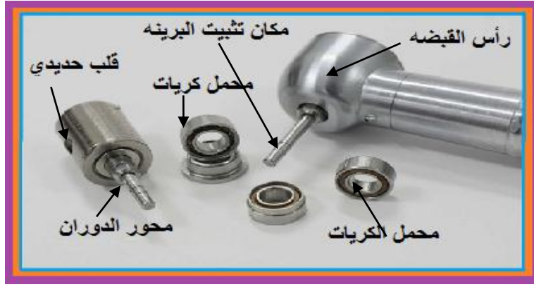
شكل 7 - 20 يوضح اجزاء المحرك مع الزيت
