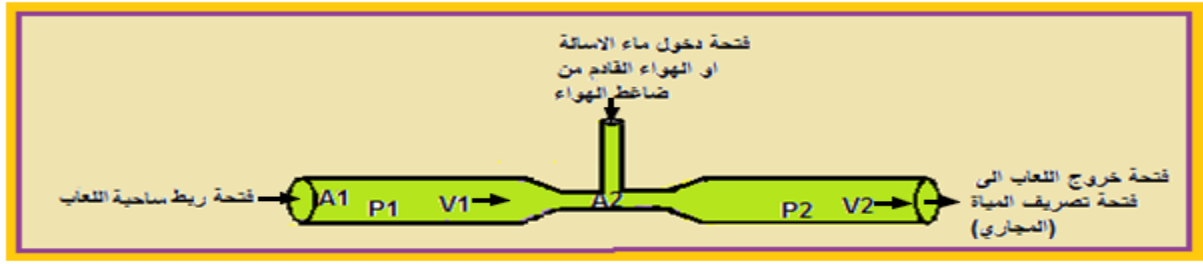
شكل رقم 7 - 24 يوضح الفكرة الاساسية لمبدأ فنجوري
