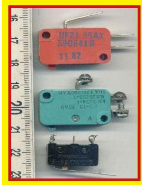
شكل 7 - 13 يوضح المفتاح المحدد (Limit Switch)
