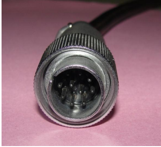
شكل 11-3 الطرف الأول لكييل المريض الذي يربط بجهاز (E.C.G)
