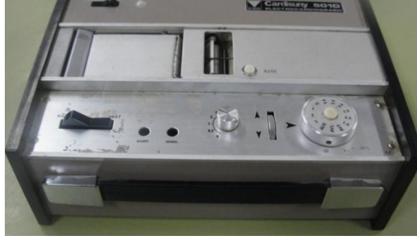
شكل 3-18 يمثل جهاز (ECG) نوع قديم ذو قناة واحدة
