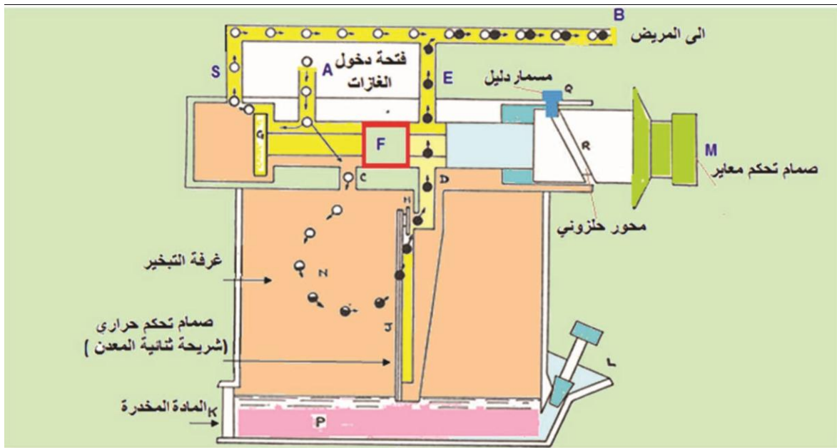
شكل 9-15-ب مبخر التعويض الحراري في وضع مفتوح
