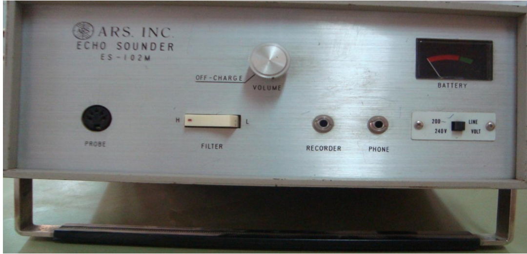
الشكل 2-2 جهاز الصدى الصوتي لسماع نبضات الجنين باستخدام الموجات فوق صوتية
