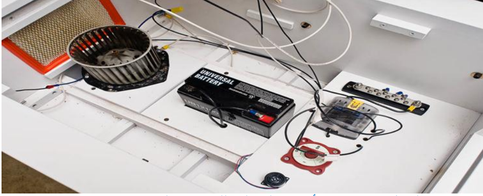
الشكل 5-6 ، b الأجزاء الداخلية للحاضنة الحديثة
