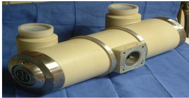
شكل 4-1 الغلاف المعدني لأنبوبة الأشعة السينية (المظهر الخارجي)
