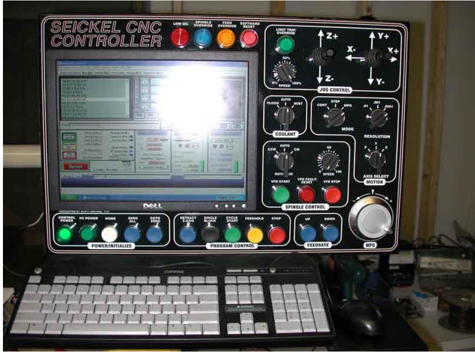
شكل (4 - 3) الأقسام الثلاثة للوحة التحكم
