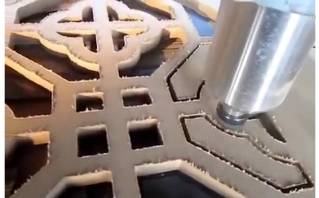
شكل (2 - 4) خشب MDF أثناء عمل ماكينة التحكم الرقمي عليه
