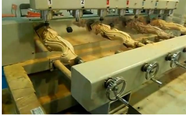
شكل (4 - 9) المخرطة الرقمية ذات الرؤوس المتعددة
