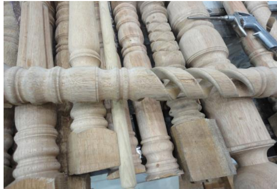
شكل (4 - 10) الأعمدة ذات التفريغ اللولبي
