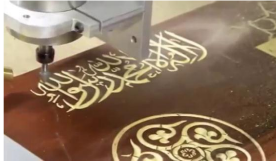
شكل (4 - 6) تنفيذ الكتابة الغائرة على ماكينة CNC
