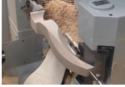
شكل (4 - 8) المخرطة الرقمية ذات الحامل الواحد
