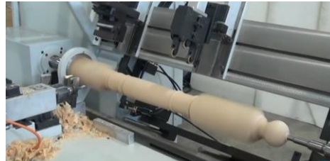
شكل (4 - 7) تنفيذ عصا اسطوانية على المخرطة الرقمية
