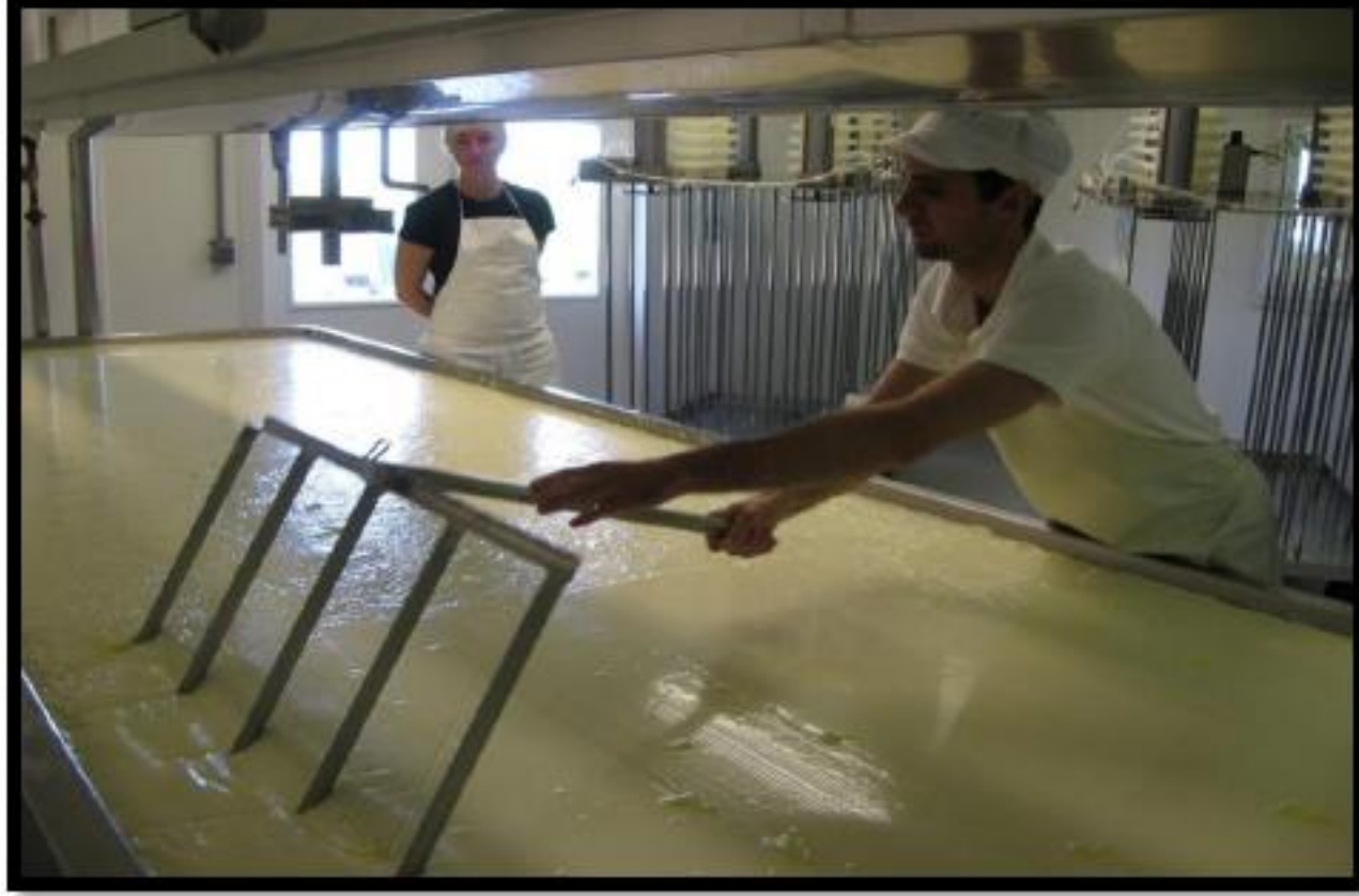
الشكل (3-9) تقطيع الخثرة بالسكاكين الطولية
