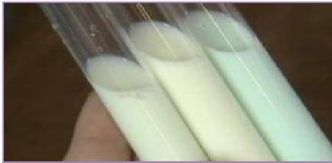
الشكل (ع-4-1) الفرق بين نماذج الحليب في إختزال صبغة المثيلين الأزرق
