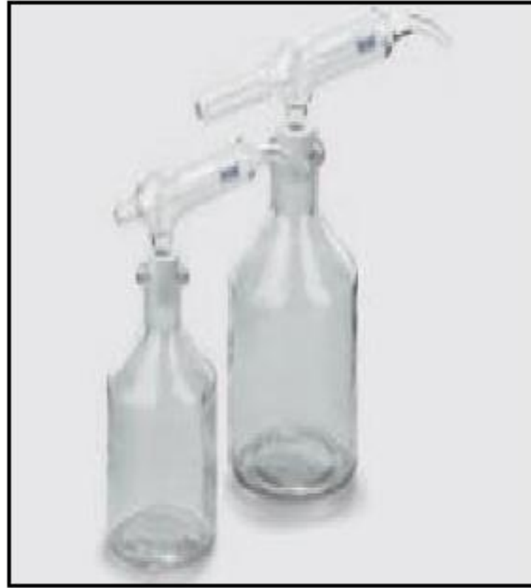
الشكل (ع-2-3) قنينة قياسية لإضافة كمية قياسية من الحامض أو الكحول الأميلي
