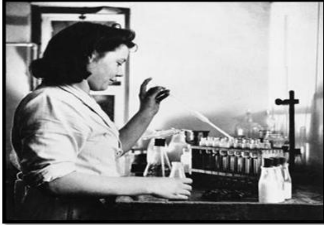
الشكل (ع-2-4) طريقة إضافة الحليب في قنينة كيربر
