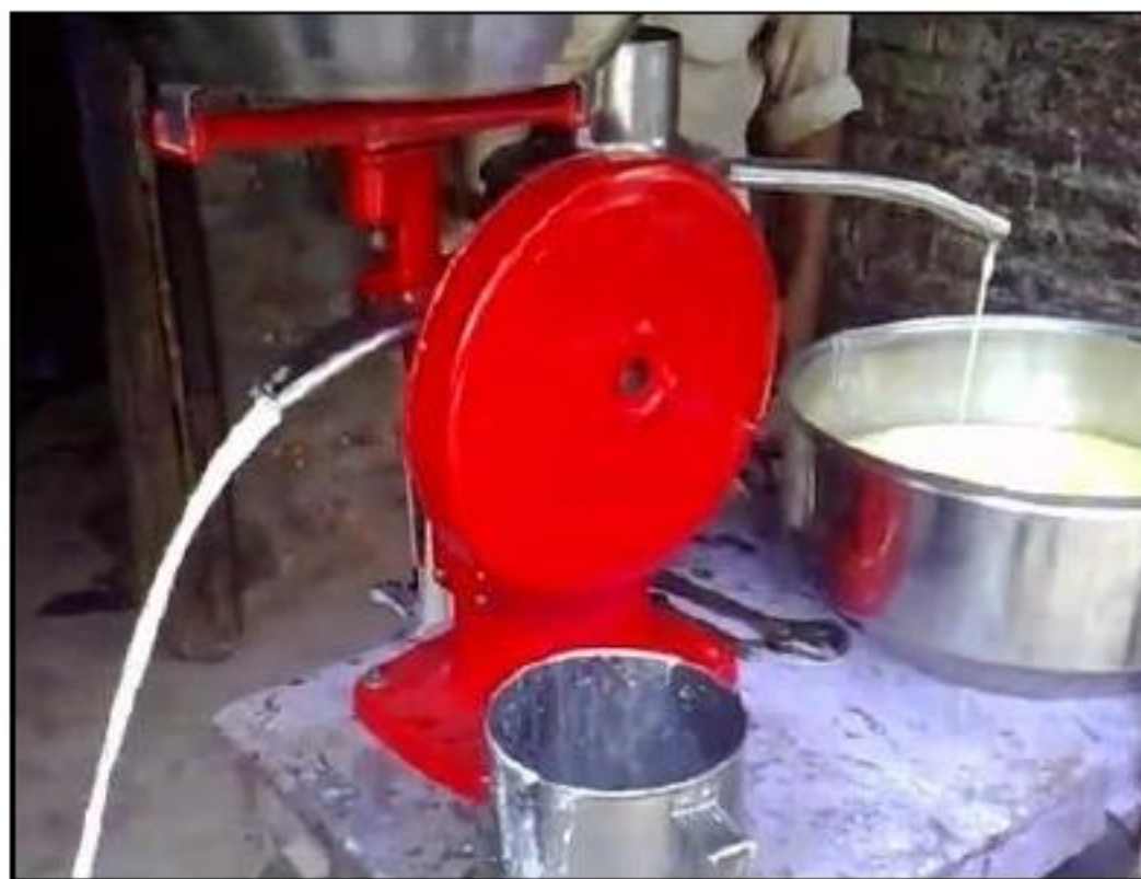
الشكل (ع-6-2) كيفية إجراء عملية الفرز
