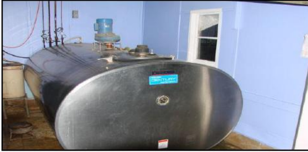
الشكل (2-7) خزان مصنوع من الحديد غير قابل للصدأ مزود بمحرك من الأعلى لتقليب الحليب
