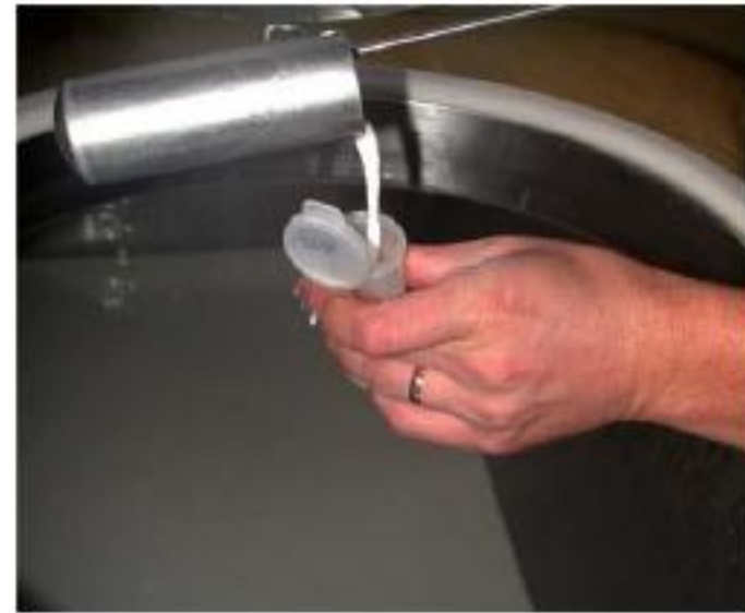
الشكل (ع-1-4) عملية أخذ عينة الحليب وحفظها في صندوق مبرد
