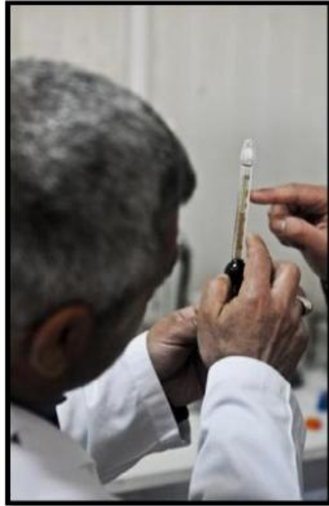
الشكل (ع-2-6) طريقة قراءة عمود ابلدهن
