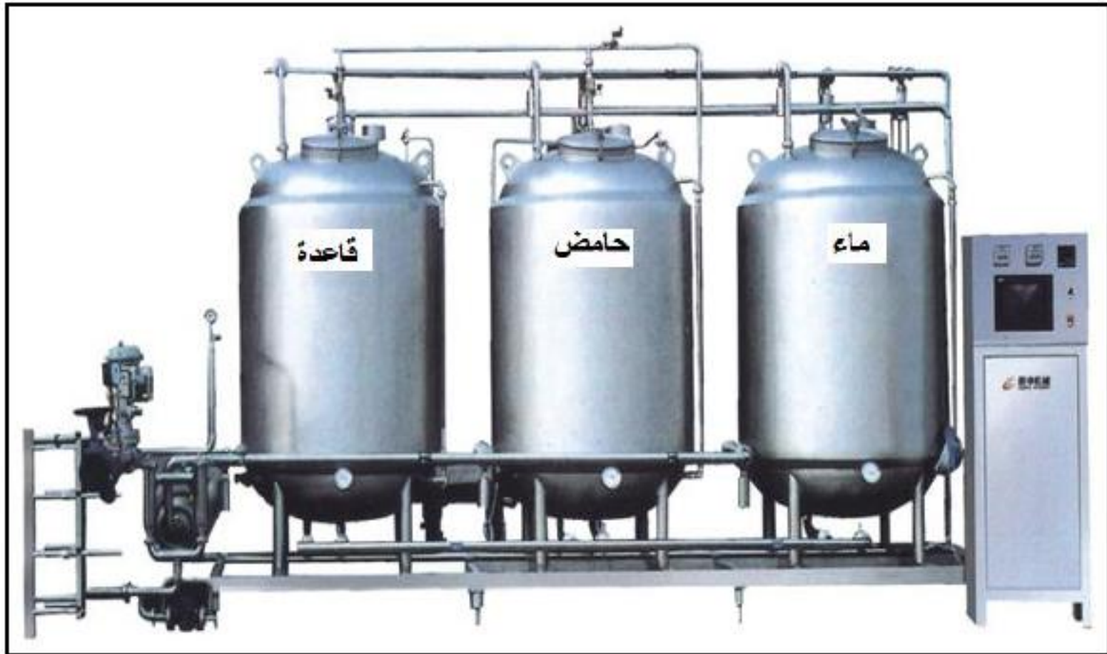
الشكل (1-6) وحدة التنظيف الموقعي في مصانع الأغذية
