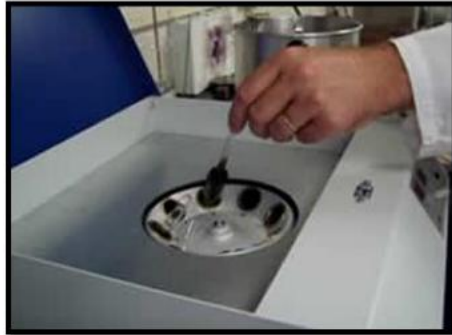
الشكل (ع-2-5) وضع النماذج في جهاز الطرد المركزي
