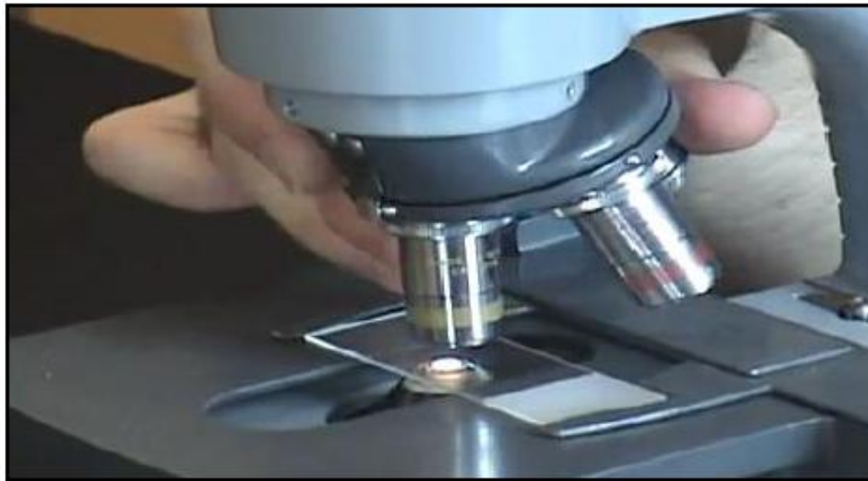
الشكل (ع-3-3) كيفية إستخدام المجهر
