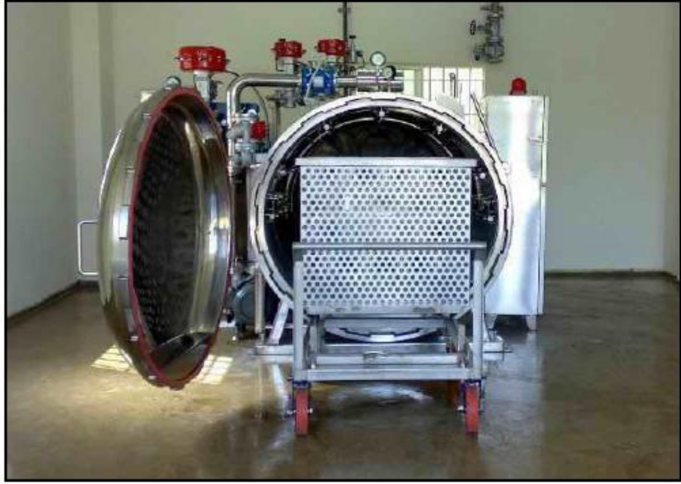
الشكل (4-8) جهاز الموصدة (الأوتوكليف) المستخدم في تعقيم الحليب بالزجاجات
