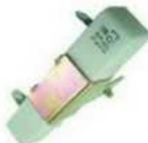
الشكل ( 2 - 1 ) مقاومة  $10\Omega/20W$  مكتوب عليها قيمة المقاومة
