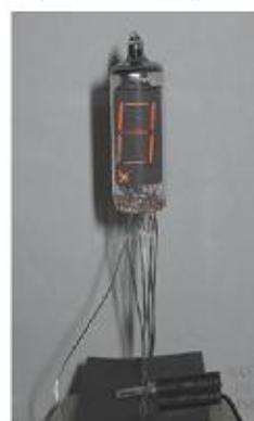
وتعد أنبوبة التفريغ الغازي نوعاً آخر من أنواع عرض الأرقام و تعمل بفولتيات عالية وتبعث هذه الوحدة وهجا برتفاليا بينما تبعث أنبوبة ( الفلوريسنت ) وهجا مائلًا إلى الخضراء و تعمل بالفولتيات المنخفضة ، والطريقة الحديثة باستخدام البلورات السائلة وتدعى ( LCD ) liquid Crystal ( LCD ) فإنها تظهر الإعداد باللون الرمادي أو الفضي وتعطي الرفقة ( LED ) وهجا مميزاً قريراً للون الأحمر والشكل ( 2 - 6 ) يوضح أنواعاً مختلفة لشاشات العرض
