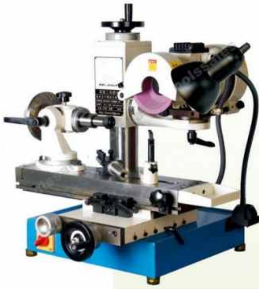
الشكل (2-7) آلة تجليخ أداة القطع
