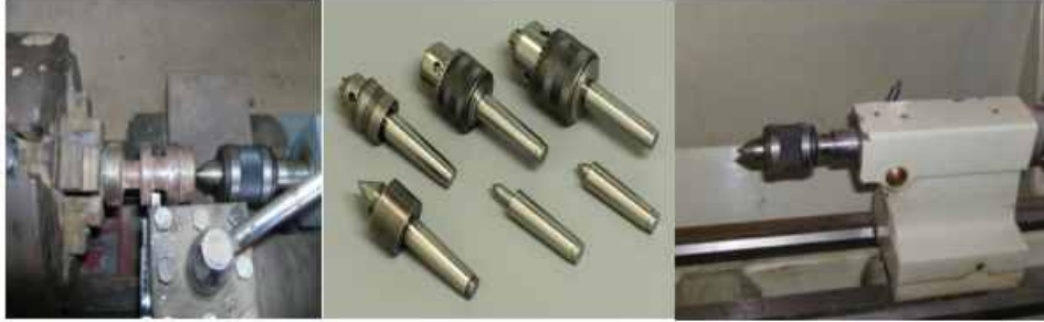
الشكل (1-7) أجزاء الغراب المتحرك وطريقة الإسناد
