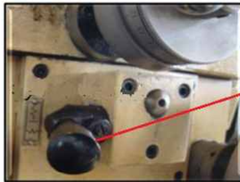
الشكل (1-4) الخراطة الطولية بإستعمال الحركة الآلية للعربة.
