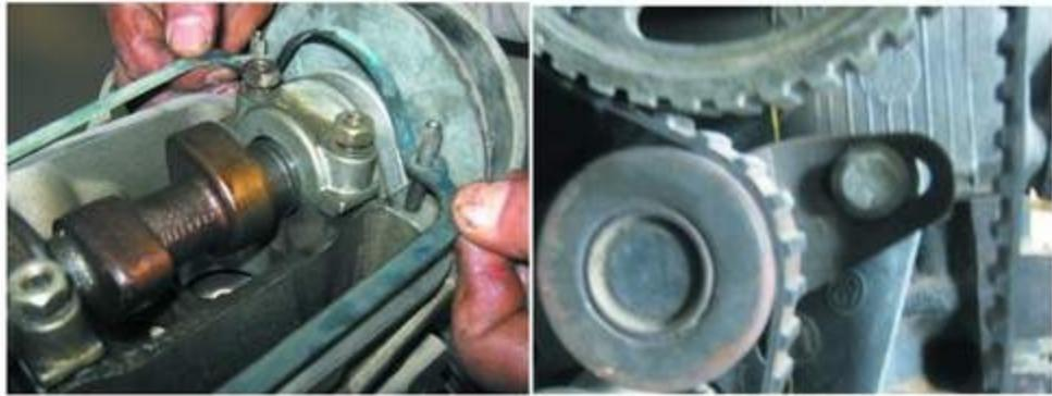
شكل (115-1) ربط لوالب (براغي) قطعة الضغط      شكل (116-1) تركيب حشوة جديدة
