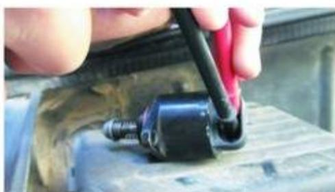
شكل(2-127) وضع الأسلالك الاوفوميتر على صمام التحكم بالهواء عند سرعة الحيداد
