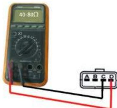
شكل (2-129) قراءة مقاومة صمام التحكم بالهواء عند سرعة الحيداد عند C.D
