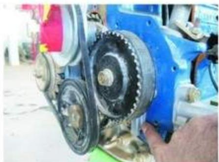
شكل (30-3) كشف تسرب الزيت من الجلب المطاطية لعمود المرفق و عمود الحدبات
