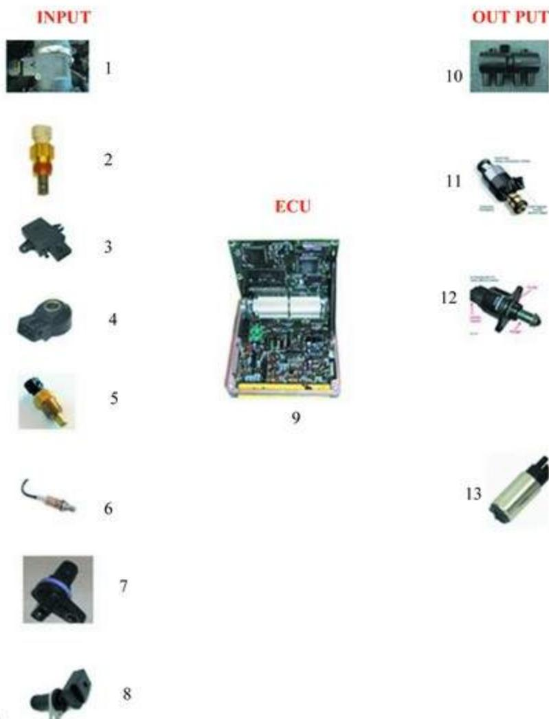
1- حساس تدفق الهواء 2- حساس درجة حرارة الهواء الداخل 3- حساس الضغط المطلق 4- حساس الصفع
