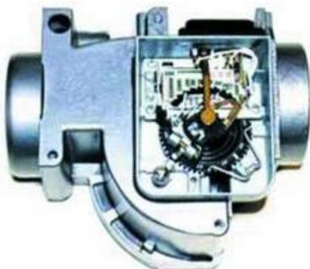
شكل (108-2) حساس تدفق الهواء الحجمي
