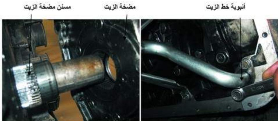
شكل (1-81) فتح أنبوبة خط الزيت بين المضخة والزيت      شكل (1-82) فك المضخة
