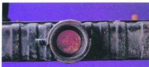
تسرب الزيت: ظهير آثار للزيت في سائل التبريد. يمكن أن يكون بسبب ضرر في المحرك أو علىة السرعة.
