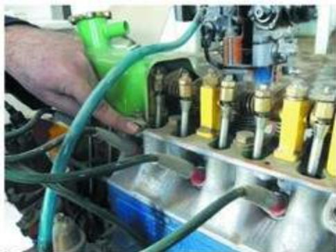
شكل (32-3) كشف تسرب الزيت من غطاء المحرك
