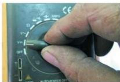
شكل (57-2) وضع جهاز الاوفوميتر لقراءة الفولتية
