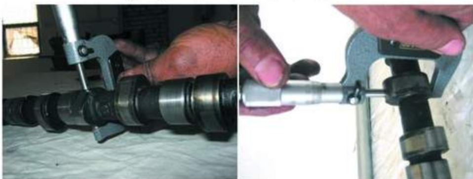
شكل (62-1) قياس ارتفاع الحدية بالمايكرومتر      شكل (63-1) قياس عرض الحدية بالمايكرومتر
