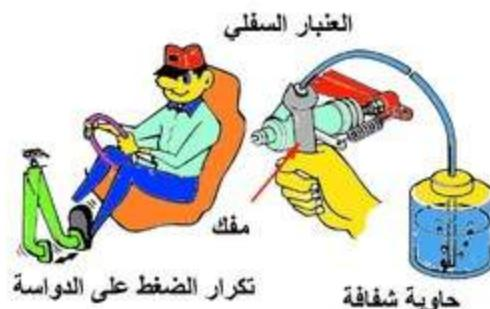
شكل (25-5) مخطط استنزاف الهواء
