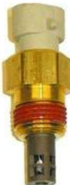
شكل (2-110) حساس درجة حرارة الهواء الداخلة
