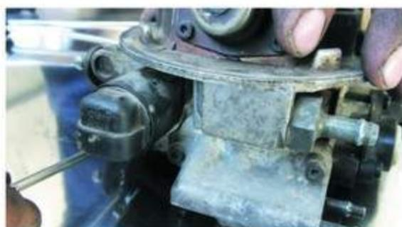
شكل (95-2) فتح برغي تثبيت صمام التحكم بالهواء عند سرعة الحياد
