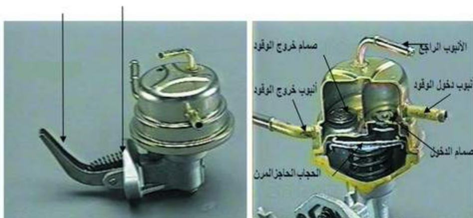
شكل (2-90-أ) مقطع لمضخة الوقود الميكانيكية      شكل (2-90-ب) مضخة الوقود الميكانيكية
