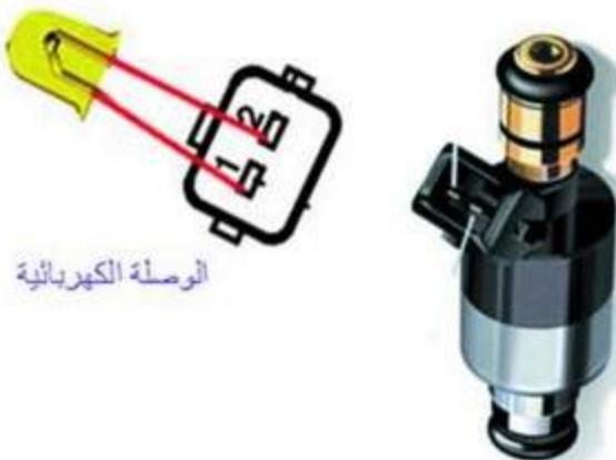
شكل (85-2) ضع باعث الضوء led بين قطبي الوصلة الكهربائية للبخاخ
