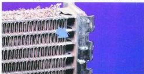
التحلل الكهربائي: تيار كهربائي ينبع من التفاعل الكيميائي بين سائل التبريد ومعدنين مختلفين. يؤدي إلى ظهور فجوات في الأنابيب.
