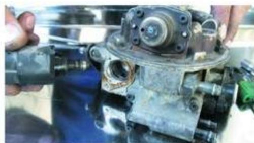
شكل (96-2) إخراج صمام التحكم بالهواء عند سرعة الحياد
