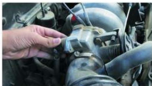
شكل (125-2) فصل الوصلة عن صمام التحكم بالهواء عند سرعة الحياد
