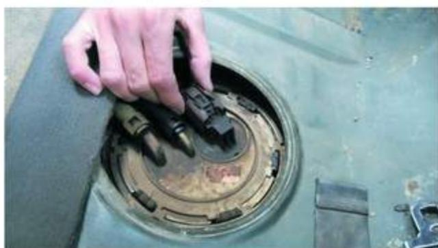
شكل (43-2) فصل الوصلة الكهربائية من مضخة الوقود
