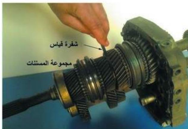
شكل (38-5) فحص الملعب الطرفي للمسننات بواسطة شفرة قياس
