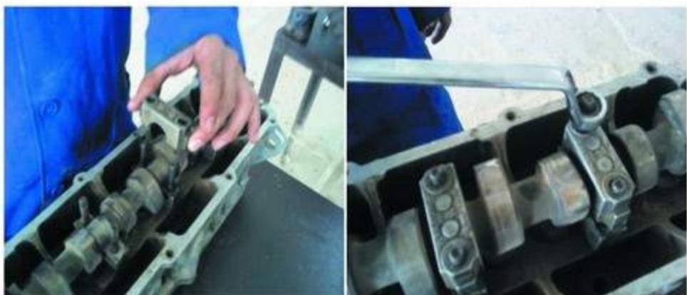
شكل (1-59) فتح لوالب (برااغي) تثبيت عمود الحدبات      شكل (1-60 ) رفع أغطية الكراسي
