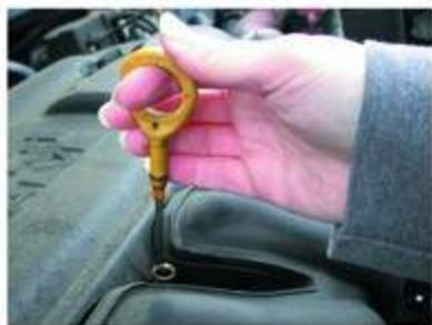
شكل(8-3) عصا قياس مستوى الزيت
