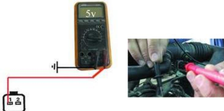
شكل (133-2) قياس الفولت للوصلة الكهربائية لحساس درجة حرارة الهواء الداخلة
