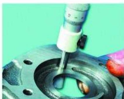
شكل (19-3) فحص عمق جسم المضخة
