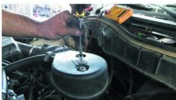
شكل (87-2) فتح برااغي تثبيت فلتر الهواء
