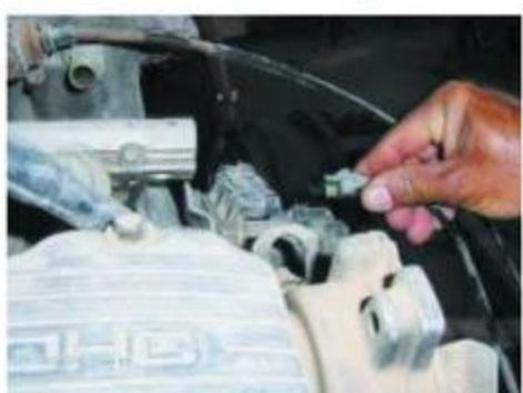
شكل ( 28-1 ) رفع الوصلات الكهربائية
