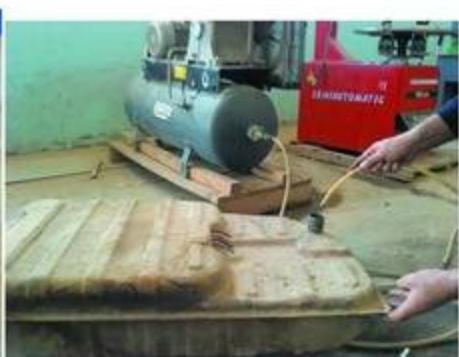
شكل (7-2) نفخ الخزان بالهواء المضغوط
