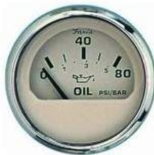
شكل(9-3) جهاز قياس لبيان ضغط الزيت
