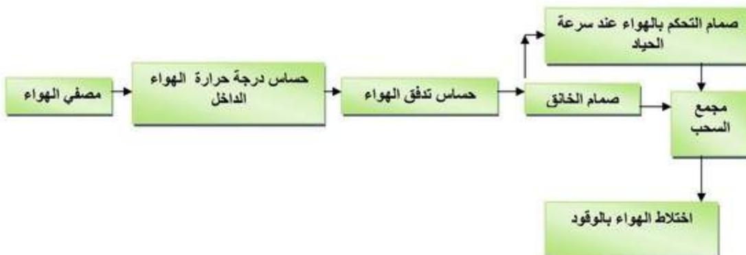
شكل (2) (105-2) مخطط منظومة التحكم بالهواء بواسطة مقياس تدفق الهواء
