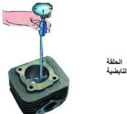
شكل ( 24-1 ) قياس القطر الداخلي للأسطوانة
