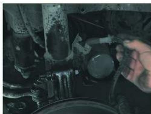
شكل (9-6) فصل أنبوب التوصيل الهيدروليكي
