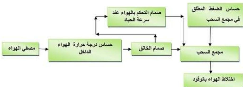
شكل(2) (106-2) مخطط منظومة التحكم بالهواء بواسطة حساس الضغط
