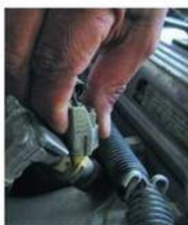
شكل (69-2) فصل الوصلة الكهربائية من البخاخ
