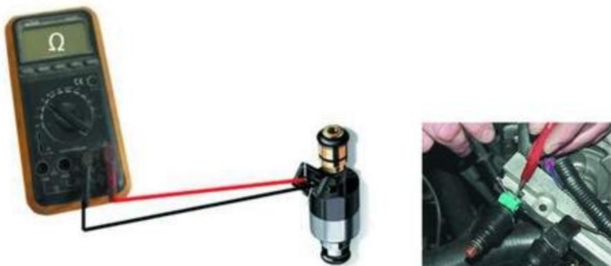
شكل (2-84) فحص المقاومة بين نقاط التوصيل الكهربائية للبخار
