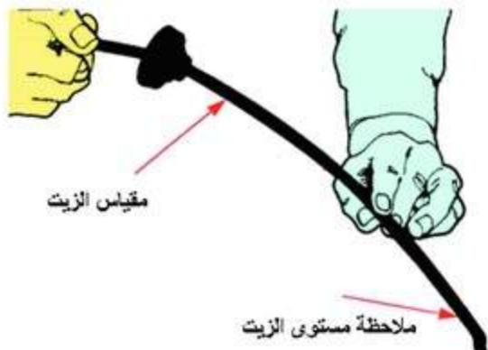
شكل (85-5) قياس مستوى الزيت لصناديق سرع أوتوماتيكي
