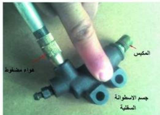
شكل (20-5) إخراج المكبس بواسطة هواء مضغوط
