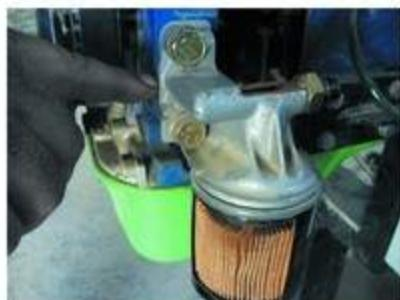
شكل (28-3) كشف تسرب الزيت من واشر قاعدة تثبيت مصفى الزيت
