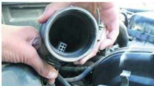
شكل (2-130) فصل الوصلة الكهربائية عن حساس درجة حرارة الهواء الداخلة
