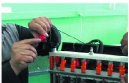
شكل (79-2) توصيل الوصلة الكهربائية للجهاز مع نقاط التوصيل الكهربائية للبخاخ
