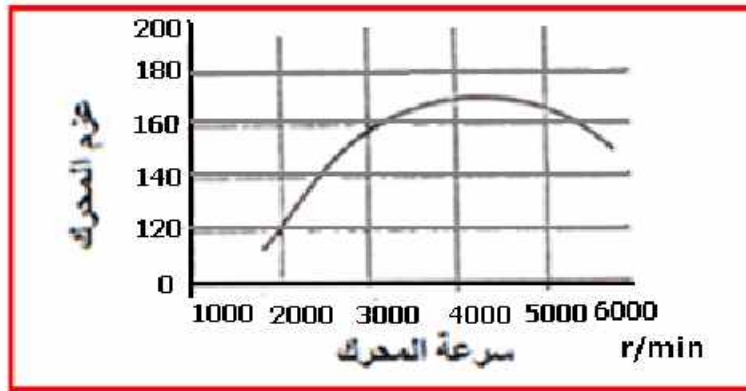
شكل 1-9 العلاقة بين عزم المحرك وسرعة المحرك
