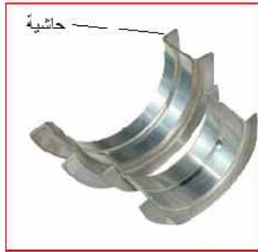
شكل 13-4 الكراسي الرئيسية التي تمتص الدفع الجانبي
