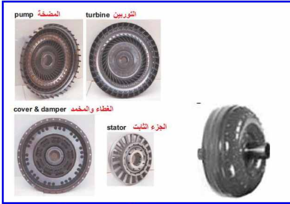
الشكل (٩-٢) شكل محول العزم وأجزائه الداخلية
