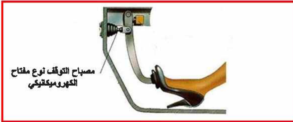
شكل (٣-٣) مصباح التوقف نوع كهروميكانيكي
