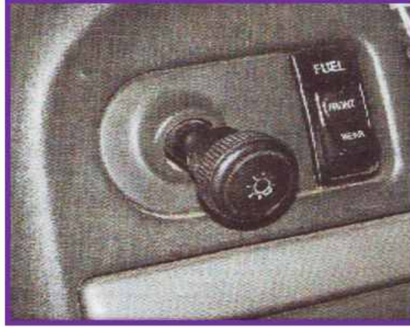
شكل (١٩-٥) مفاتيح الإنارة من النوع المنزلق
