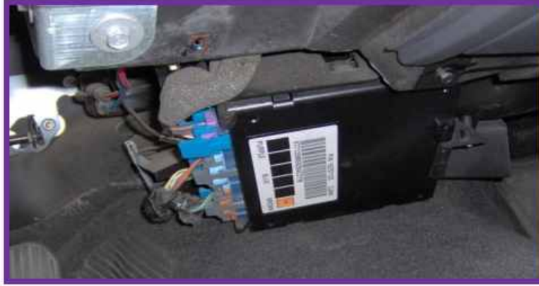
شكل (٤٢-٥) وحدة التحكم الإلكتروني بلوحة أجهزة القياس ومنظومة الإنارة
