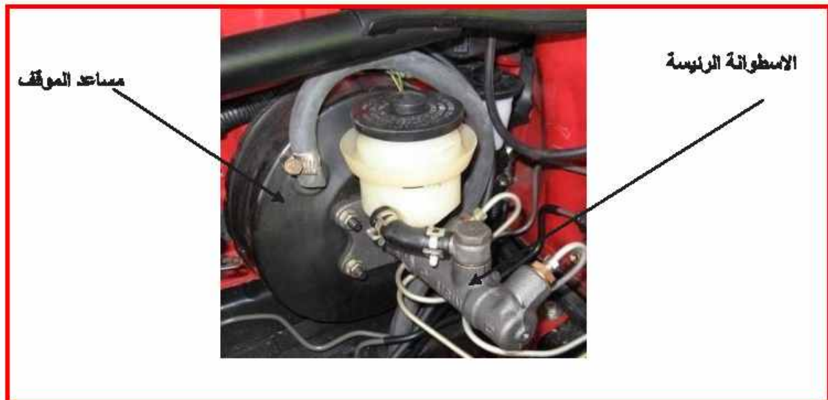
شكل (٩-٣) ربط الاسطوانة الرئيسية للموقف
