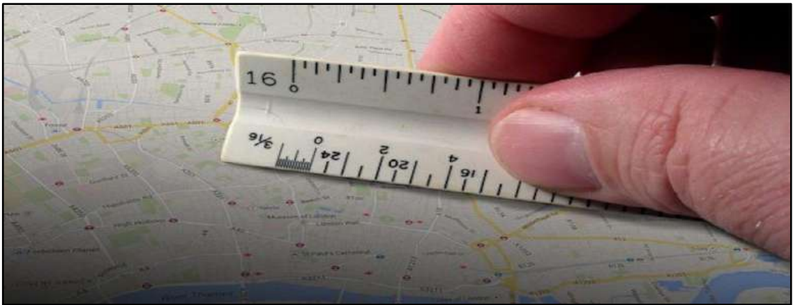
الشكل (9-4) يمثل قياس المسافة المستقيمة من الخريطة باستخدام المسطرة.
