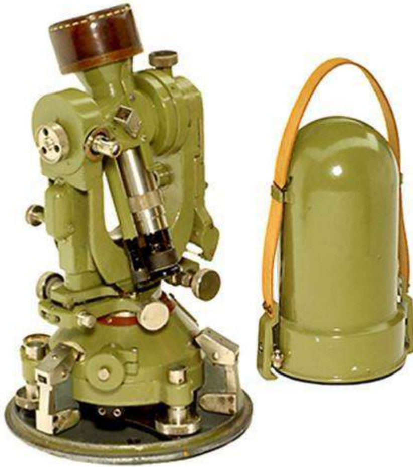
الشكل (5-11) جهاز ثيودولايت نوع T2 الشهير من شركة Wild السويسرية.
