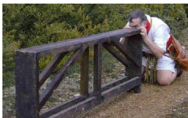
الشكل (2-1) جهاز الكوروبيتس (chorobates).
