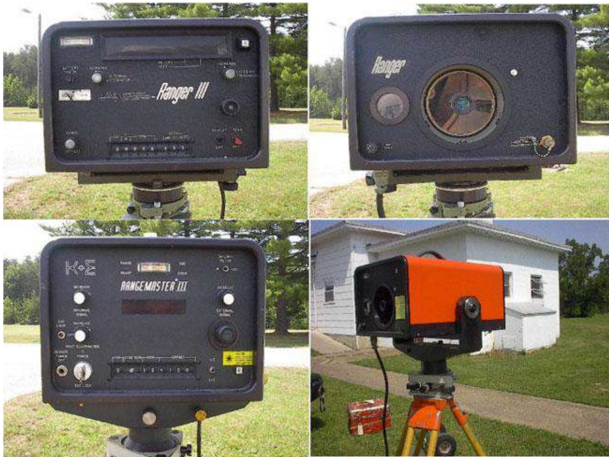
الشكل (5-15) جهاز قياس المسافات الالكتروني والمستعمل في فترة السبعينيات من القرن العشرين.
