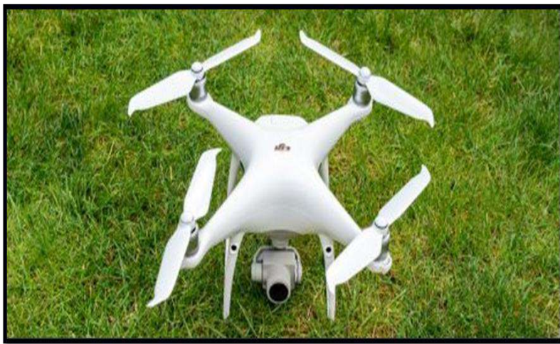
الشكل (2-2) طائرة مسيرة تستخدم في المسح التصويري في مراقبة المنشآت.
