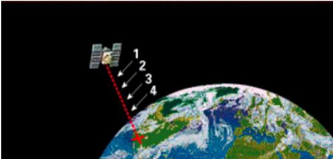
الشكل (14-2) قياس المسافة من القمر الصناعي
