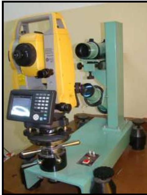
الشكل (12-1) طريقة تثبيت جهاز المحطة المتكاملة على جهاز المعايرة (الكولوميتير)
