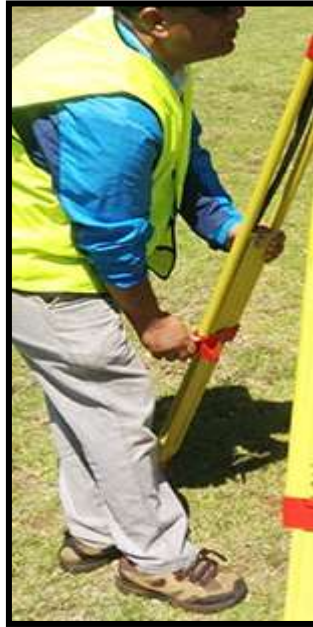
الشكل (8-1) تغيير ارتفاع الارجل لضبط الفقاعة بشكل تقريبي
