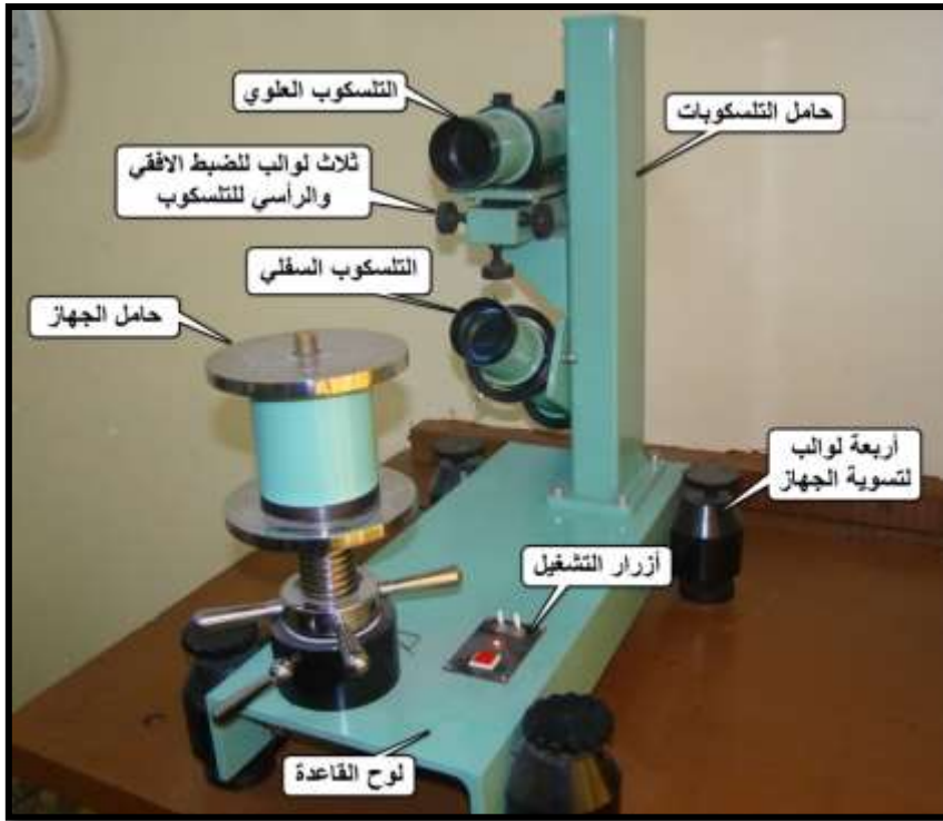
الشكل (10-1) أجزاء جهاز الكولوميتر
