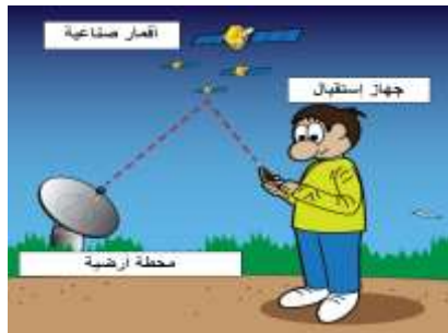
الشكل (1-2) الفكرة الأساسية لنظام التموضع العالمي (GPS)
