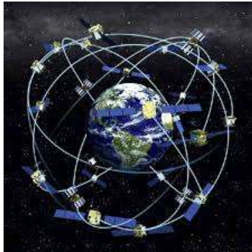
الشكل (2-5) قسم الفضاء لنظام التموضع العالمي GPS Space Segment
