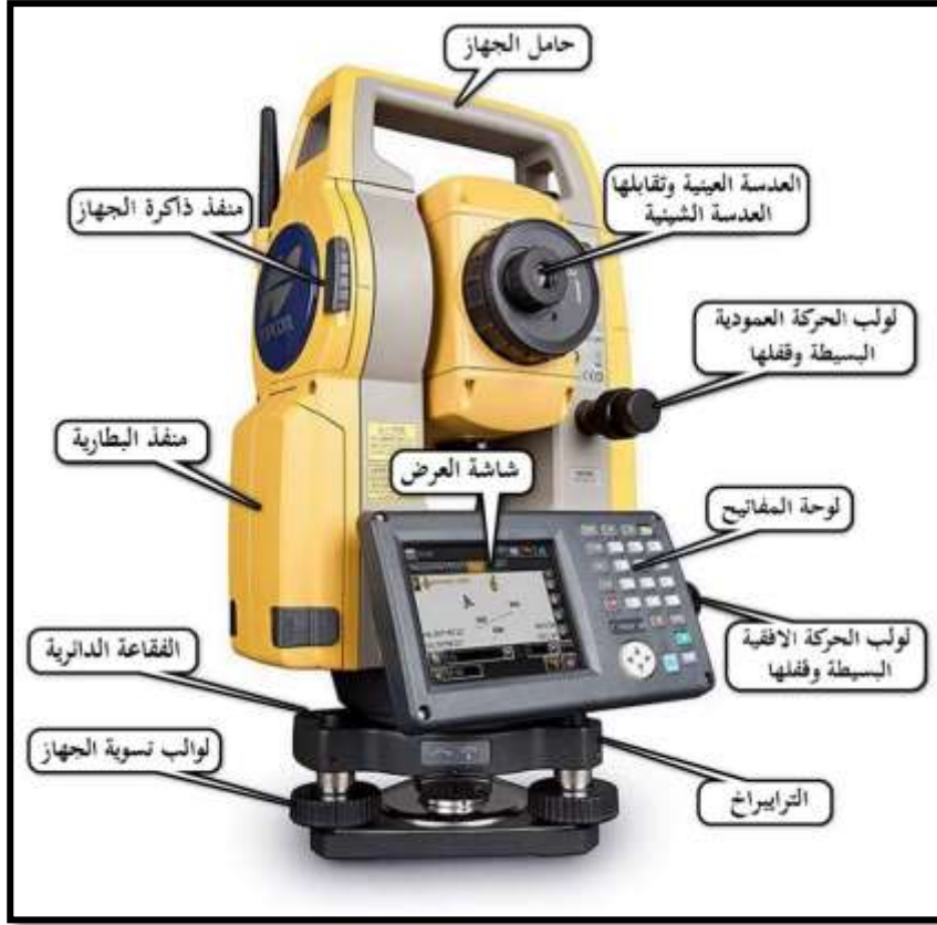
الشكل (1-1) يوضح الأجزاء الخارجية لجهاز المحطة المتكاملة
