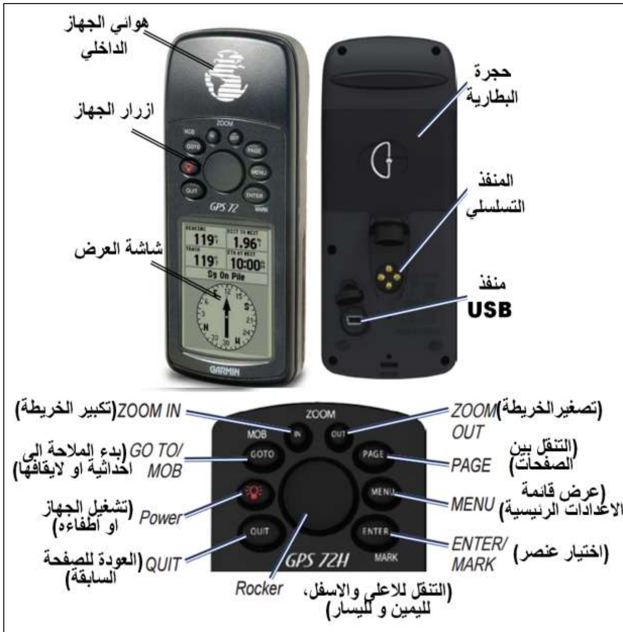
الشكل (18-2) الاجزاء والازرار الرئيسية لجهاز الكارمن 72 (GPS Garmin 72)
