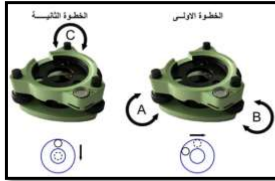
الشكل (9-1) الضبط الدقيق للفقاعة الدائرية من خلال براغي ضبط الأفقية
