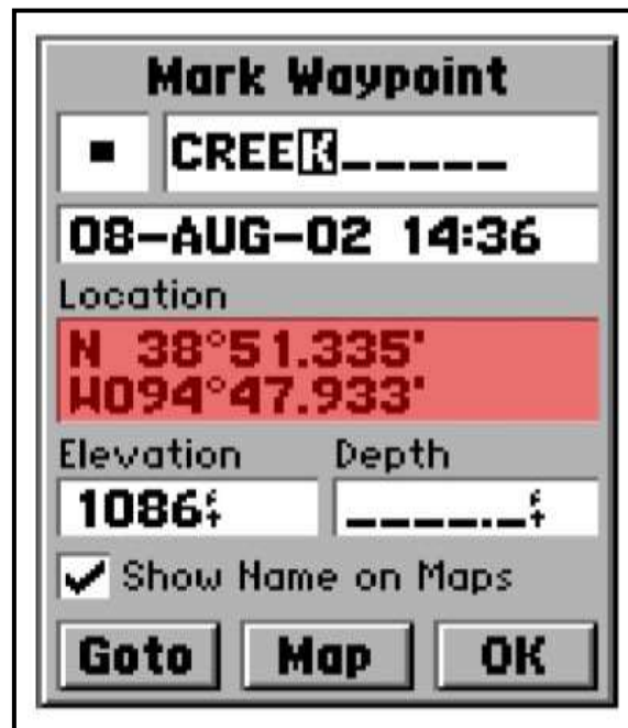
الشكل (2-30) يوضح طريقة تثبيت النقطة على خارطة الجهاز.
