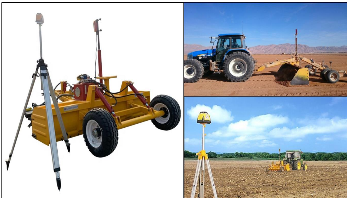
الشكل (3 – 2) تسوية الاراضي الزراعية بواسطة الجهاز الليزري
