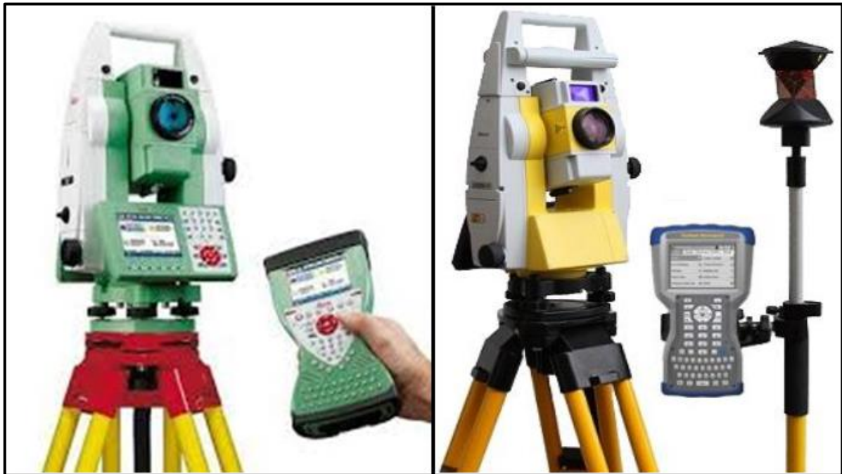
الشكل (1 - 18) جهاز المحطة المتكاملة ذاتي الحركة والتوجيه
