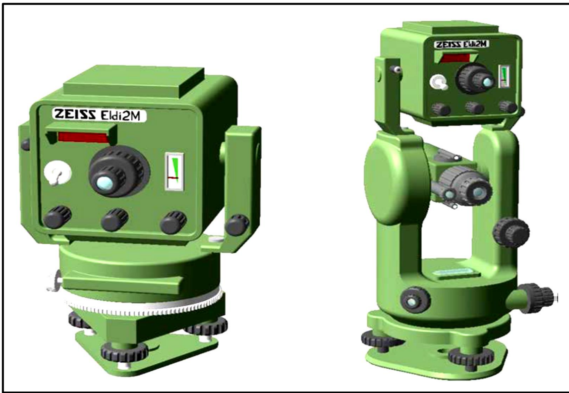
الشكل (1 - 2) احد انواع أجهزة EDM مثبت على قاعدة أو فوق جهاز الثيودولايت
