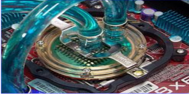
شكل 2-14 تبريد المعالج بالماء
