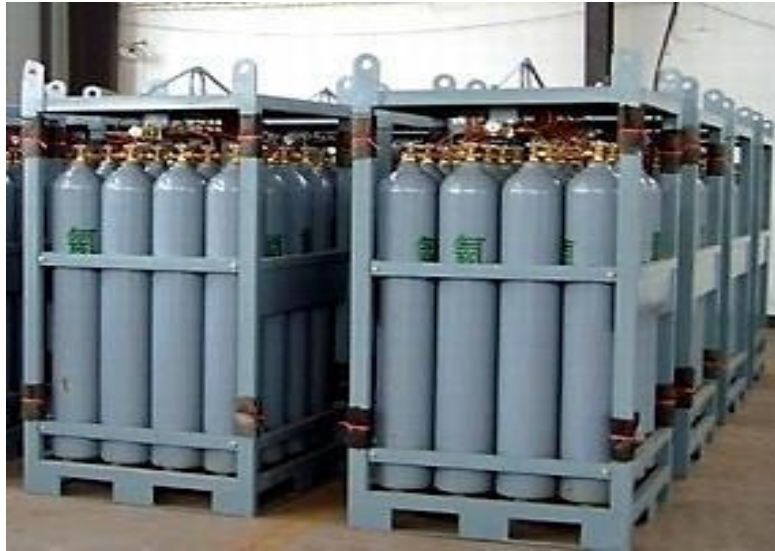
الشكل 1-6 حفظ الغازات المضغوطة
