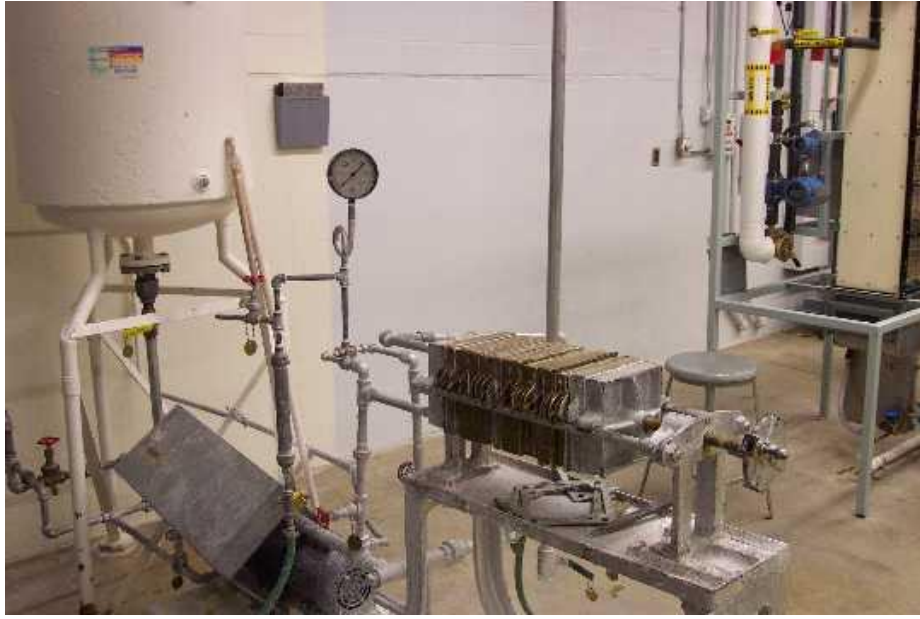
الشكل 2-7 المنظومة الكاملة لجهاز الترشيح ذي الألواح
