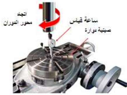
الشكل (1 - 24) ضبط محور الدوران مع مركز المنضدة الدوارة
