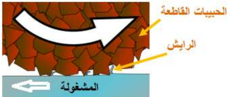
شكل 8 - 1 إزالة الرايش بحجر التجليخ
