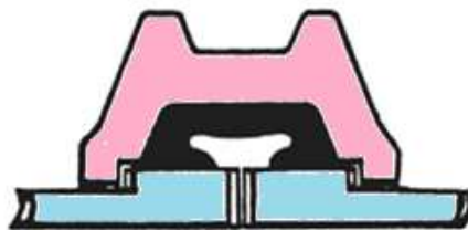
الشكل (2 - 12) يبين قطع في انبوبين مربوطين ويوضح آلية الربط
