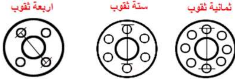
الشكل ( 2 - 49 ) يوضح قياس دائرة التنقيب ( لفلنجة مزدوجة الثقوب )
