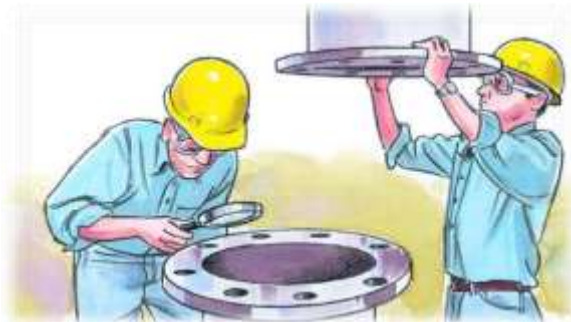
الشكل ( 2 – 53 ) يوضح فحص الفلنجات قبل الربط
