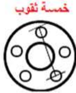
الشكل ( 2 - 50 ) يوضح قياس دائرة التنقيب ( لفلنجة مفردة الثقوب )
