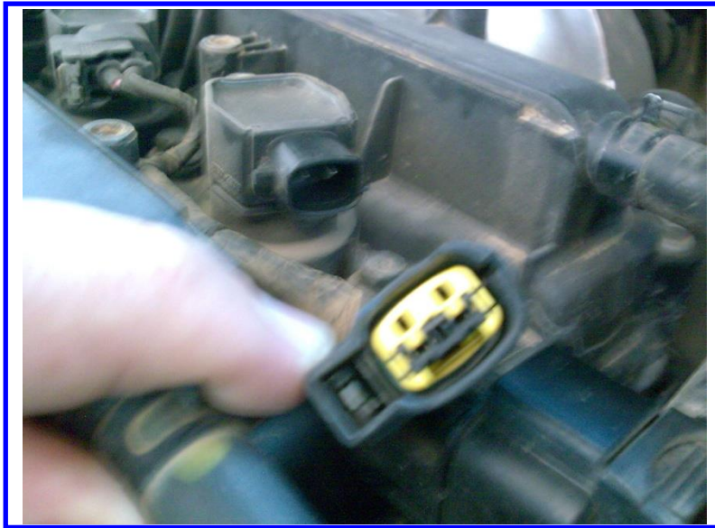
الشكل (3-6) فصل التوصيل الكهربائي
