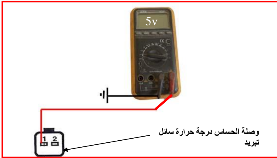
شكل (2-59) توصيل إطراف الفحص الى الوصلة الكهربائية لحساس درجة حرارة سائل تبريد
