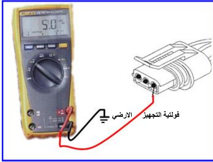
الشكل (20-3) فحص فولتية التجهيز
