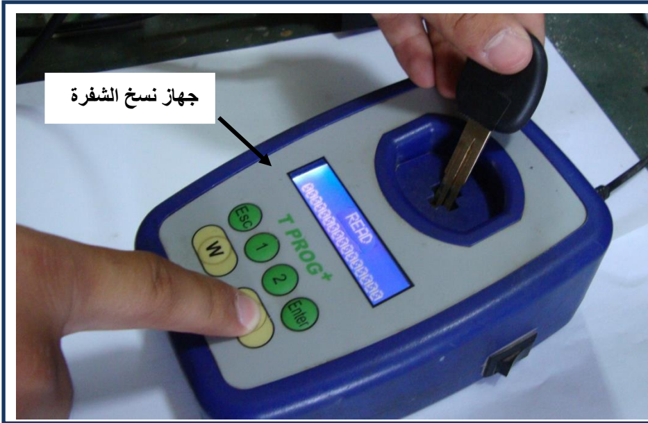
الشكل (15-1) قراءت شفرة المفتاح الاصلي
