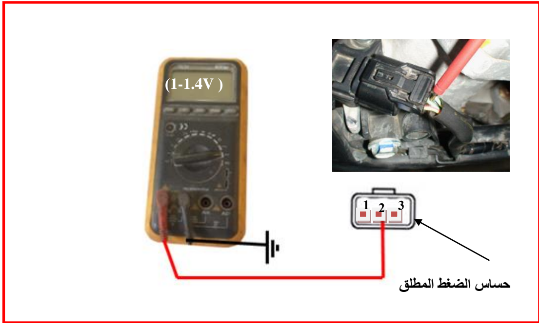
شكل (2-53) وضع أسلاك الفحص لجهاز اوفوميتر عند النقطة 2 والأرضي لحساس
