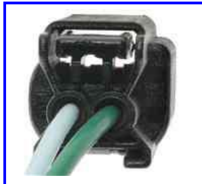
الشكل (3-15) رفع التوصيل الكهربائي عن الحساس
