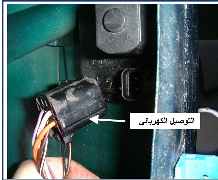
الشكل (8-1) فصل التوصيل الكهربائي
