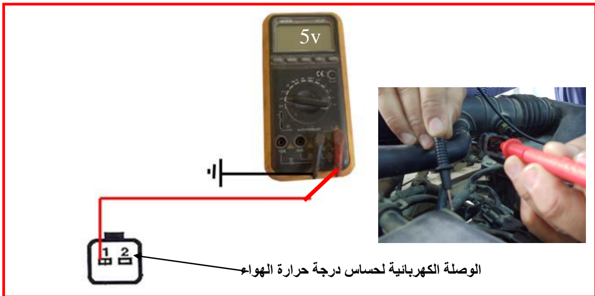
شكل (2-38) قياس فولتية الوصلة الكهربائية لحساس درجة حرارة الهواء الداخلة
