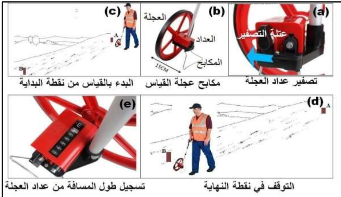
الشكل (1-25) خطوات قياس المسافة باستخدام عجلة القياس
