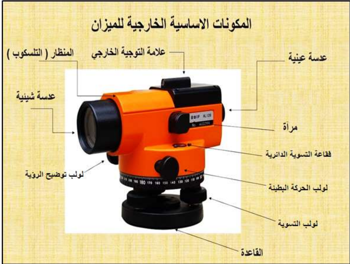
الشكل (5-9) اجزاء التلسكوب وملحقاته لجهاز الميزان
