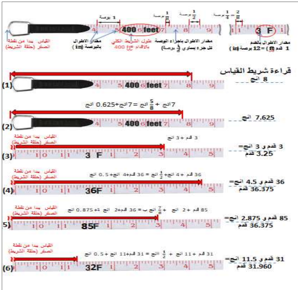
الشكل (11-1) قراءة تقسيمات شريط القياس بالنظام الانكليزي
