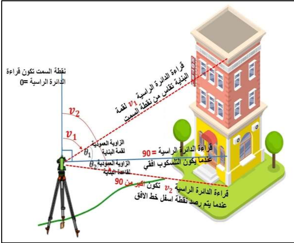
الشكل (6 - 34) الزاوية العمودية المقاسة بجهاز الثيودولايت
