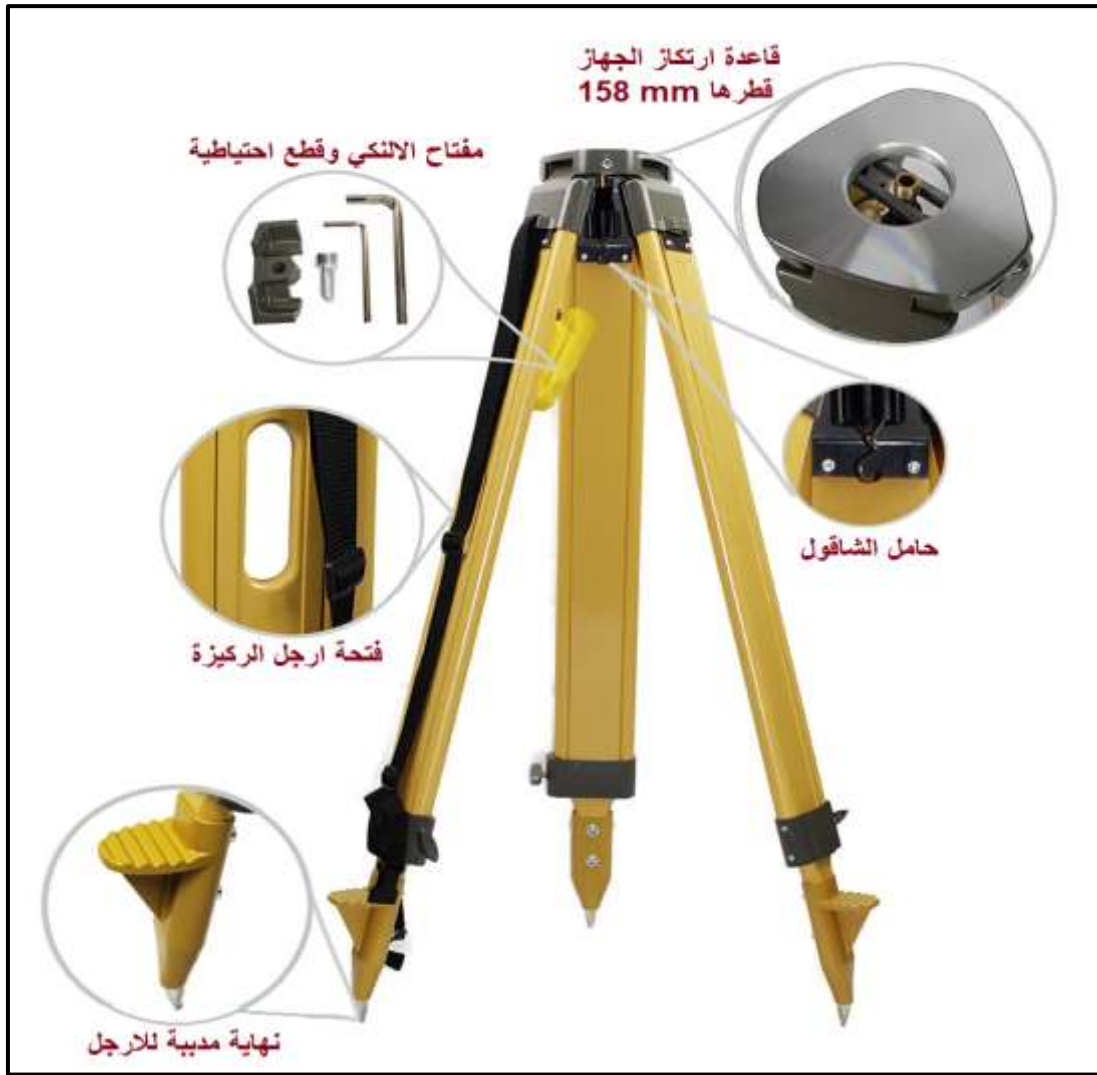
الشكل (6 - 12) اجزاء الركيزة
