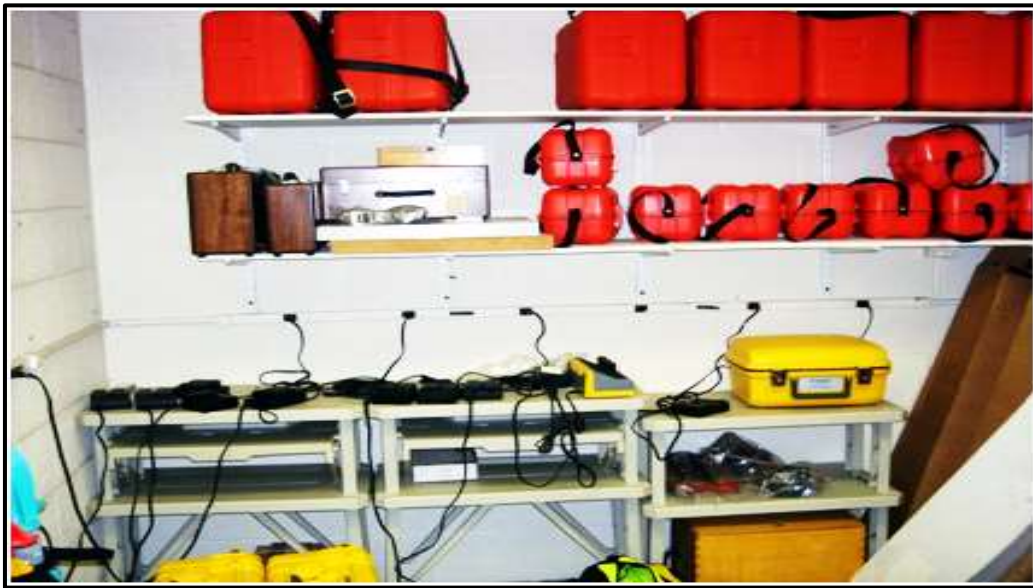
الشكل (3-4) يوضح كيفية اعادة شحن بطاريات الاجهزة المساحية
