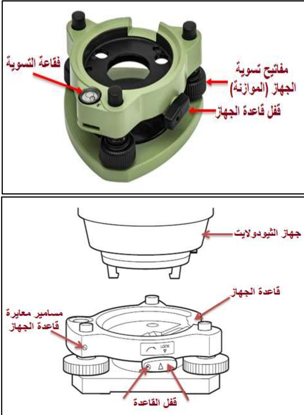
الشكل (6 - 11) قاعدة الجهاز (الترابريك)
