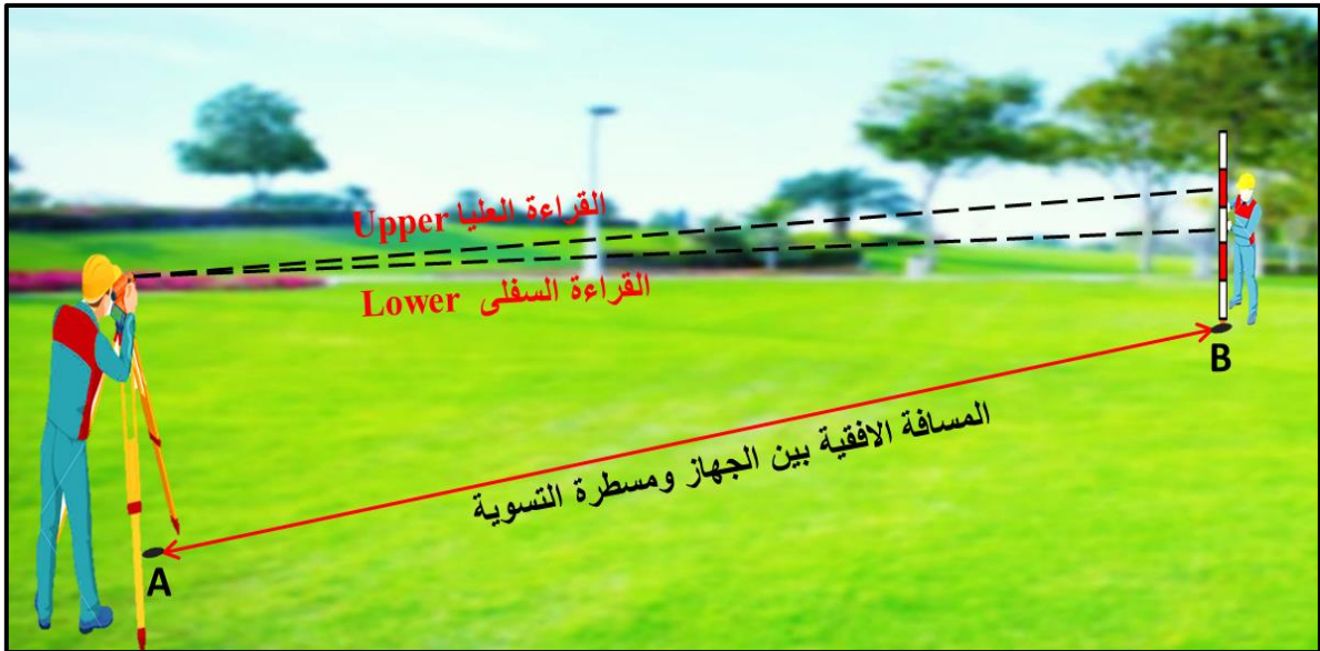
الشكل (16-2) قياس المسافة بين الجهاز والمسطرة
