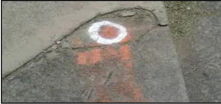
الشكل (2-6) راقم التسوية نوع المعيار المؤقت
