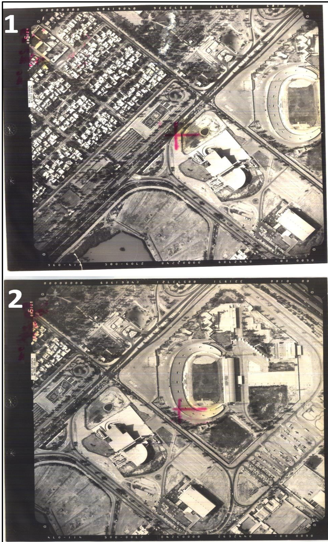
الشكل (22-5) صور جوية عمودية متداخلة (الصورة اليسرى (1) واليمنى (2))
