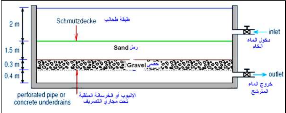
الشكل 3-4 : مقطع طولي أمامي لمرشح رملي بطيء (لوحة للرسم)
