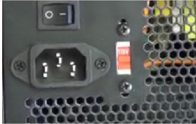
الشكل (5-15) جهاز القدرة للحاسوب مع مفتاح الاختيار
