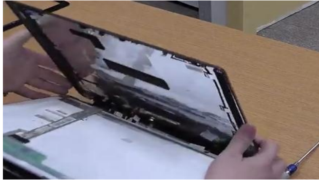
8- افصل كيبيل LCD كما موضح بالشكل الآتي:
