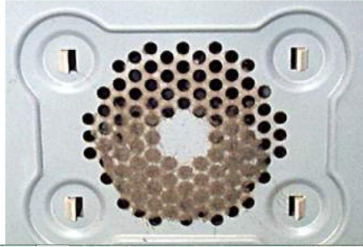
الشكل (24-5) تنظيف فتحات التهوية لمجهاز القدرة
