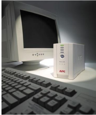
شكل (2-5) جهاز UPS
