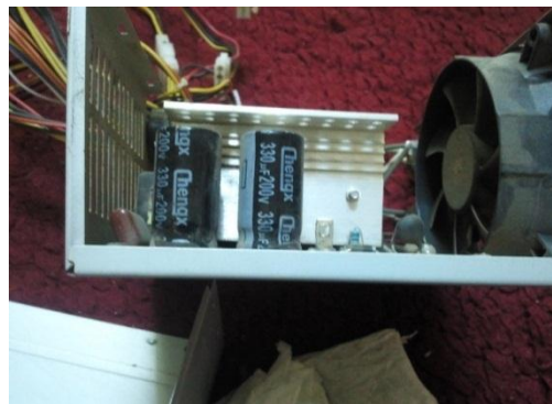
الشكل ( 5-19 ) انواع المكثفات داخل مجهز القدرة للحاسوب
