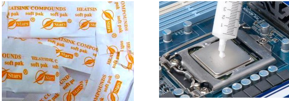
الشكل (7-3) العجينة الحرارية نوع سيلكون
