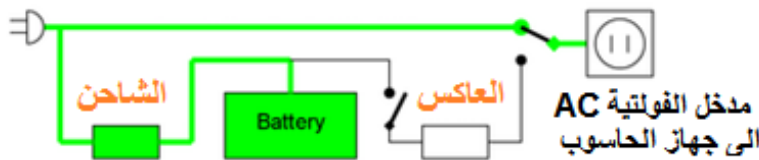
الشكل (3-5) تشغيل جهاز الحاسوب بوجود الكهرباء الوطنية
