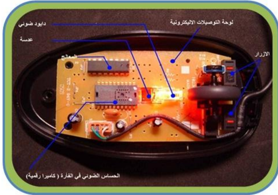
الشكل رقم (4 - 31) يوضح المكونات الداخلية للفأرة الضوئية
