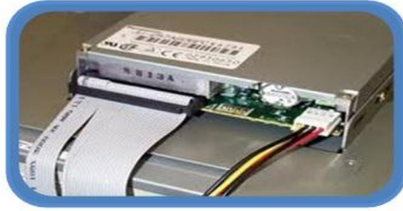
الشكل رقم (1 - 51) يوضح موصلات التغذية والبيانات
