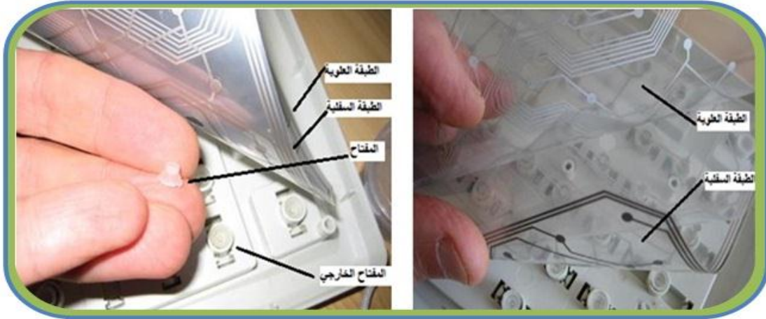
الشكل رقم (4 - 11) المفاتيح الغشائية للوحة المفاتيح
