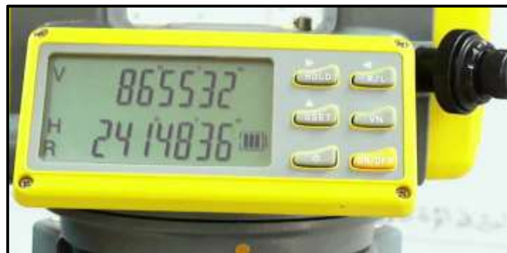
الشكل (4 - 27) قراءة الزاوية الأفقية والرأسية في شاشة جهاز التيودولايت
