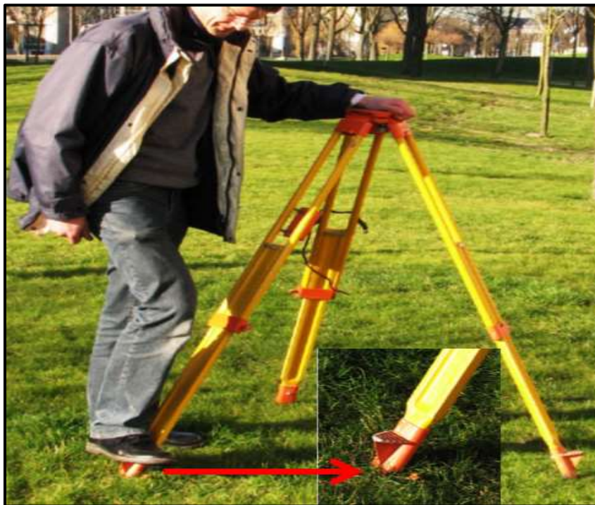
الشكل (2 - 9) تثبيت الركيزة في الأرض وغرسها بالقدم
