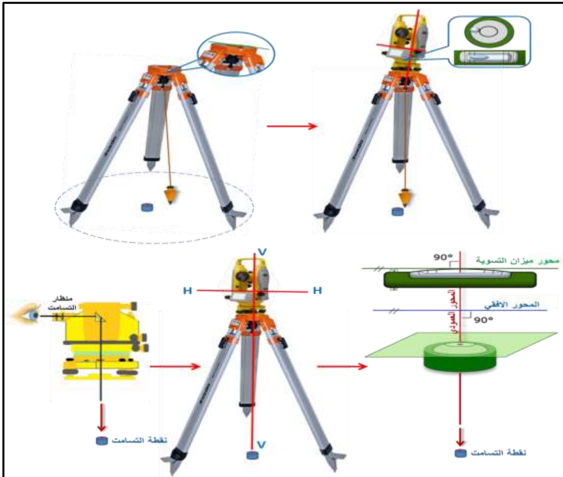
الشكل (4 - 12) خطوات تمرکز (تسامت) جهاز الثيودولايت وضبطه
