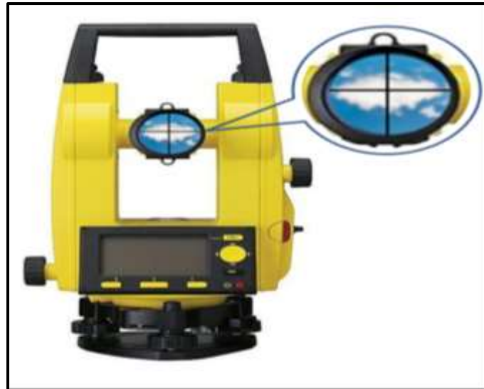
الشكل (4 - 18) توجيه التلسكوب نحو السماء وتوضيح الشعيرات
