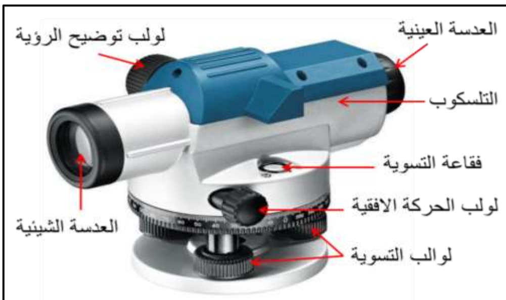
الشكل (2 - 3) أجزاء جهاز التسوية
