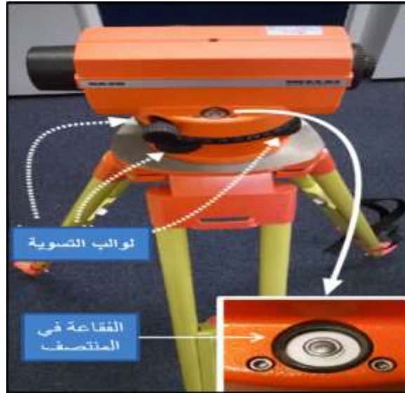
الشكل (2 - 12) موازنة جهاز التسوية والفقاعة في المنتصف
