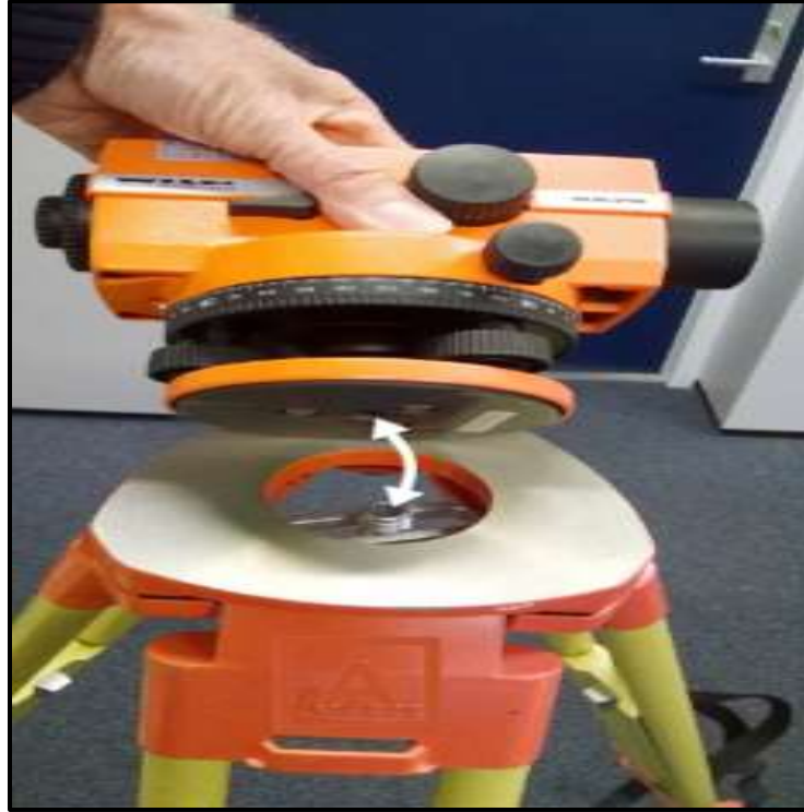
الشكل (2 - 10) تركيب وتثبيت الجهاز فوق الركيزة
