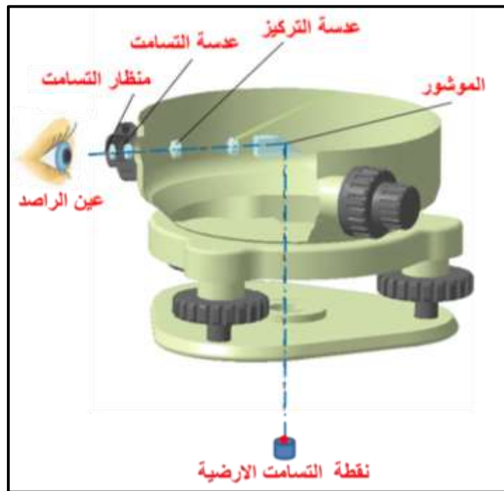
الشكل (4 - 11) عملية ضبط التسامت من خلال منظار التسامت
