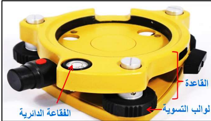
الشكل (4 - 13) الفقاعة الدائرية في قاعدة جهاز الثيودولايت
