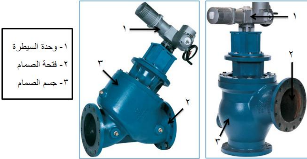
شكل رقم (6-2) يبين نوعين من صمامات سيطرة الضخ الكهربائي
