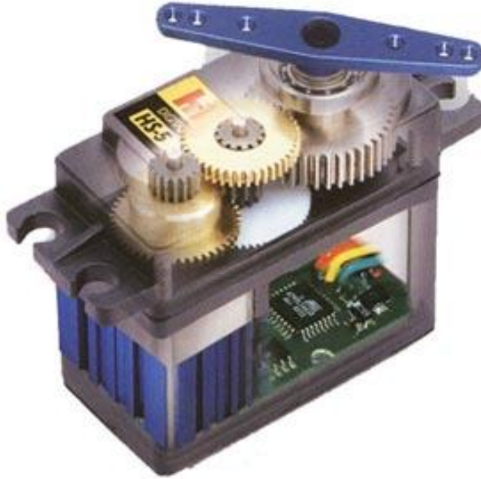
شكل رقم (2-31) محرك الموازنة ( السيرفو )
