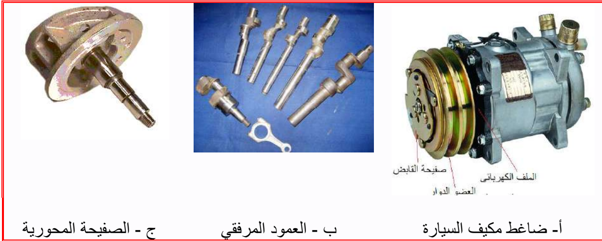
شكل 5-15 الضاغط الترددي في السيارة
