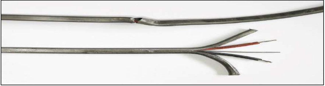
الشكل (5-1) تلف الموصل الكهربائي الناجم عن الحرارة
