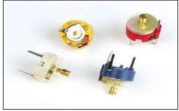
شكل (53-2) المكثفات الكهربائية
