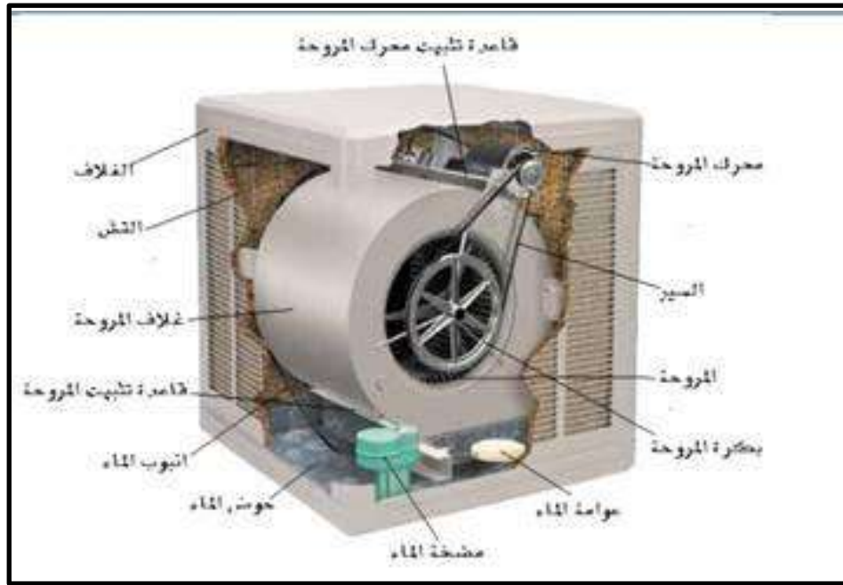
شكل (5-22) الاجزاء الرئيسية للمكيف الصحراوي
