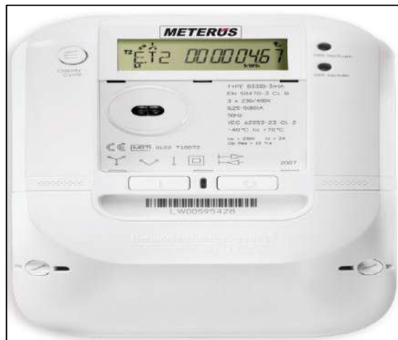
شكل (3-4) العداد الكهربائي الالكتروني
