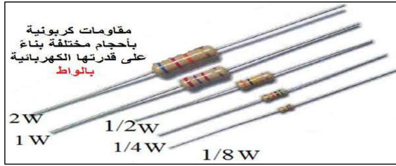
شكل (73-2) مقدار القدرة في المقاومات المختلفة الحجم
