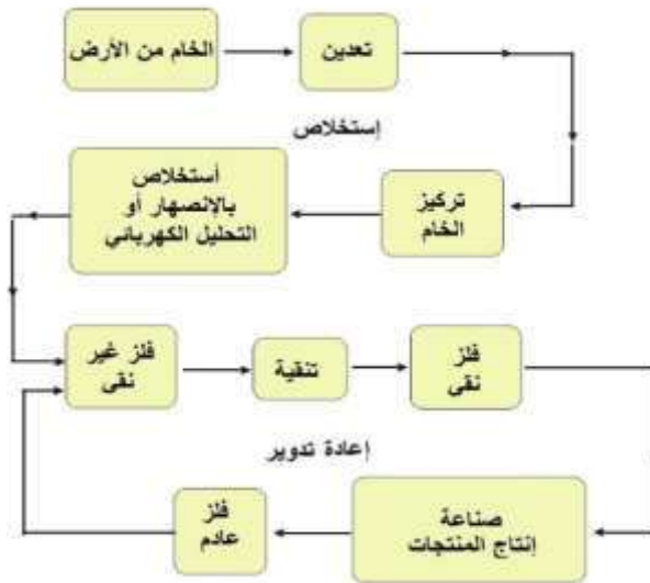
الشكل 8-9 مخطط كيفية استخلاص الفلزات وإعادة تدويرها
