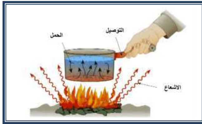
شكل 7-7 الانواع الثلاثة لانتقال الحرارة.
