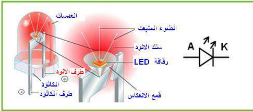
الشكل (2-1) تركيب ورمز ثنائي الانبعاث الضوئي
