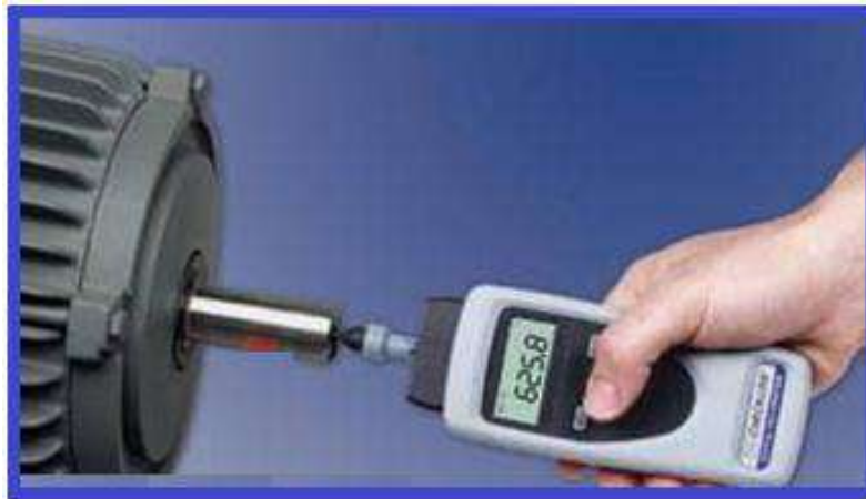
شكل (32-2) جهاز قياس السرعة الدورانية الرقمي ذو التماس الدوار
