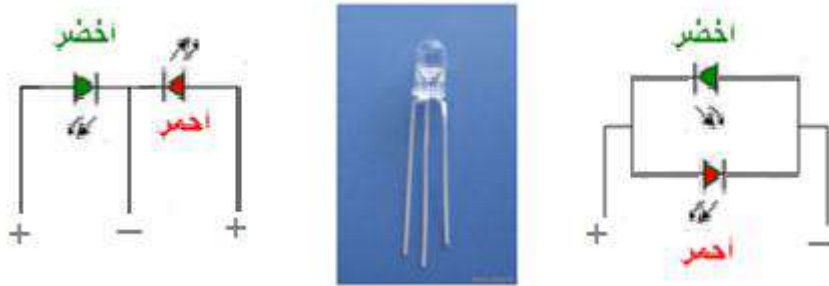
الشكل (3-1) ثنائيات الانبعاث الضوئي مزدوج الألوان
