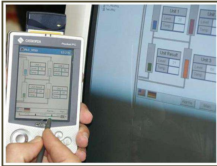
الشكل (1-34) شاشة عرض لنظام Scada
