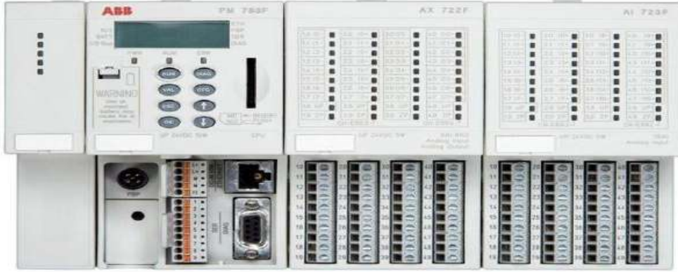
شكل (9-1) أجهزة (PLC) نوع الهجينة
