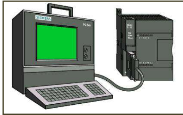
الشكل (3-5) جهاز البرمجة مع جهاز PLC
