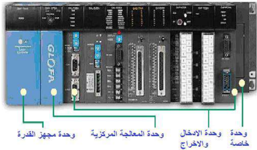
شكل (8-1) أجهزة (PLC) نوع التركيبية
