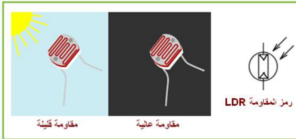
الشكل (5-1) شكل المقاومة LDR ورمزها
