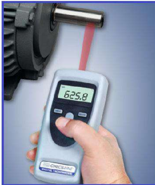
شكل (2-35) مقياس سرعة ضوئي يعتمد على استخدام اشعة الليزر
