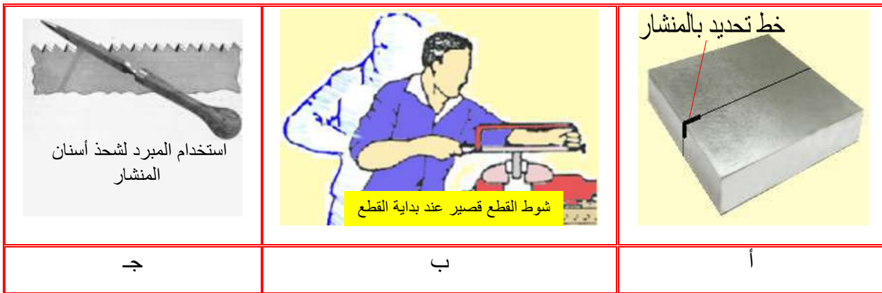
شكل 1-24 بداية عملية النشر وحد أسنان سلاح المنشار
