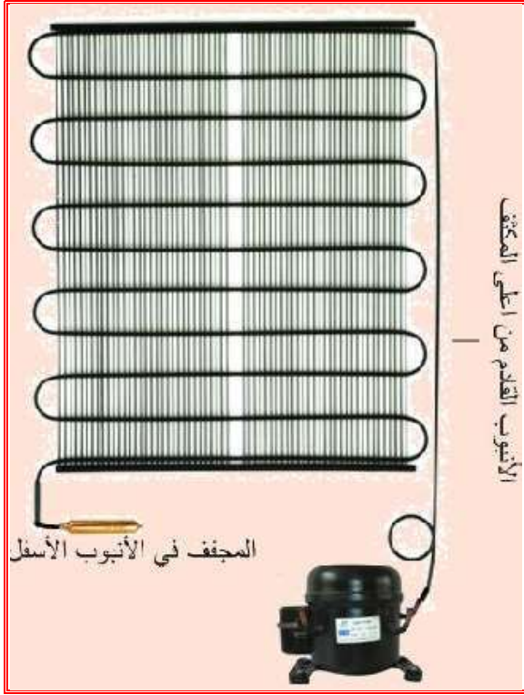
شكل 7-15 ب طريقة تثبيت المكثف الجديد في الثلاجة
