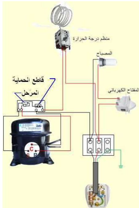
شكل 1-8 الدائرة الكهربائية للثلاجة المنزلية
