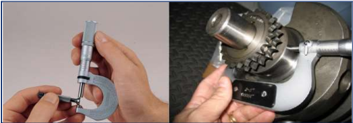
شكل 15-1 قياس الأقطار الكبيرة والصغيرة بواسطة المايكرومتر
