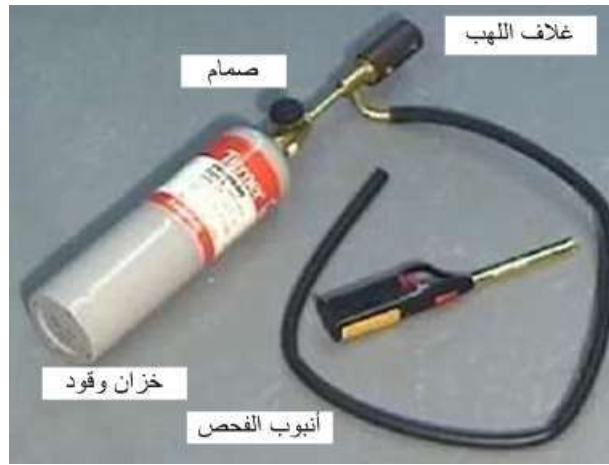
شكل 3-4 مشعل الهاليد لفحص تسرب موائع التثليج الهالوكاربونية
