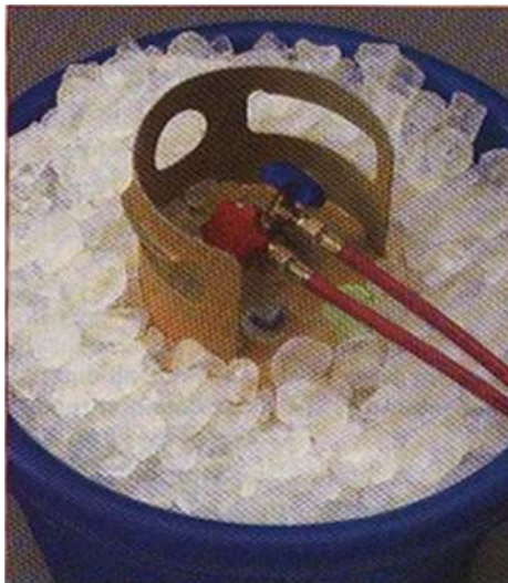
عملية إعادة تأهيل بخار مانع التثليج غمر أسطوانة إعادة تأهيل البخار في الثلج شكل 7- 27 طريقة إعادة تأهيل بخار مانع التثليج
