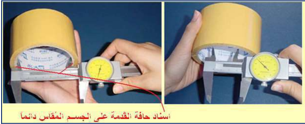
شكل 11-1 قياس الأقطار الداخلية بواسطة القدمة
