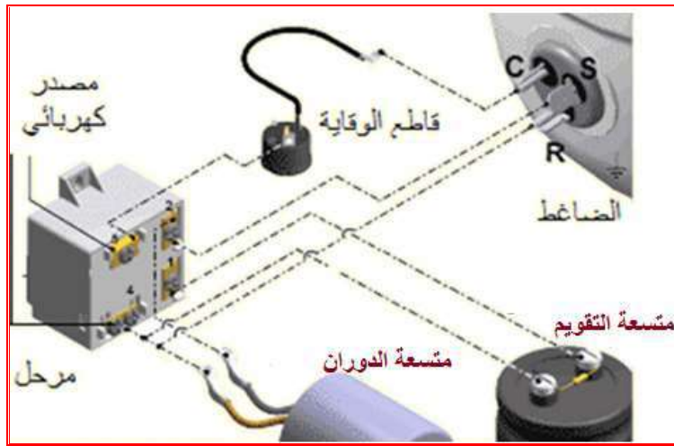
شكل 8-11 الربط الكهربائي لمتسعة التقويم والدوران
