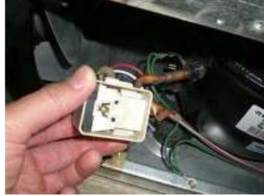
ت- ارفع المنظومة الكهربائية الصلبة
