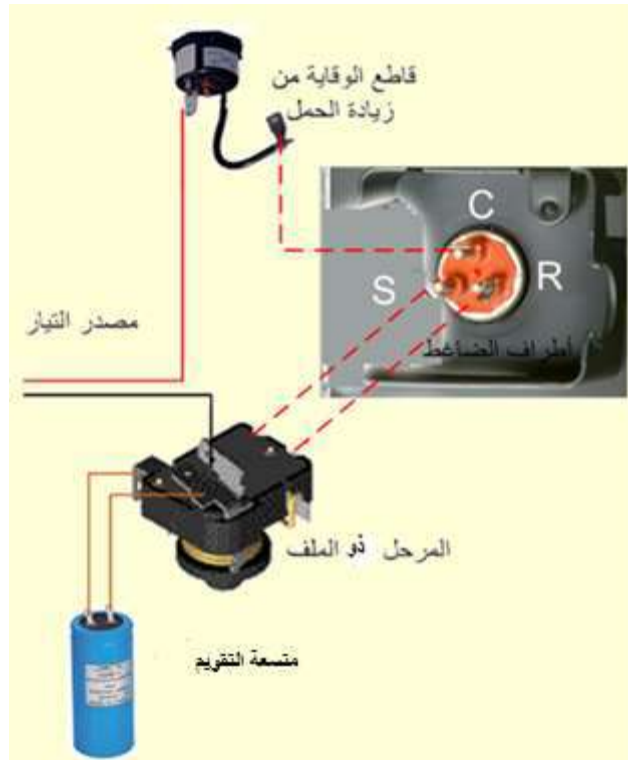
شكل 10-8 الربط الكهربائي لمتسعة التقويم في الضاغط المغلق
