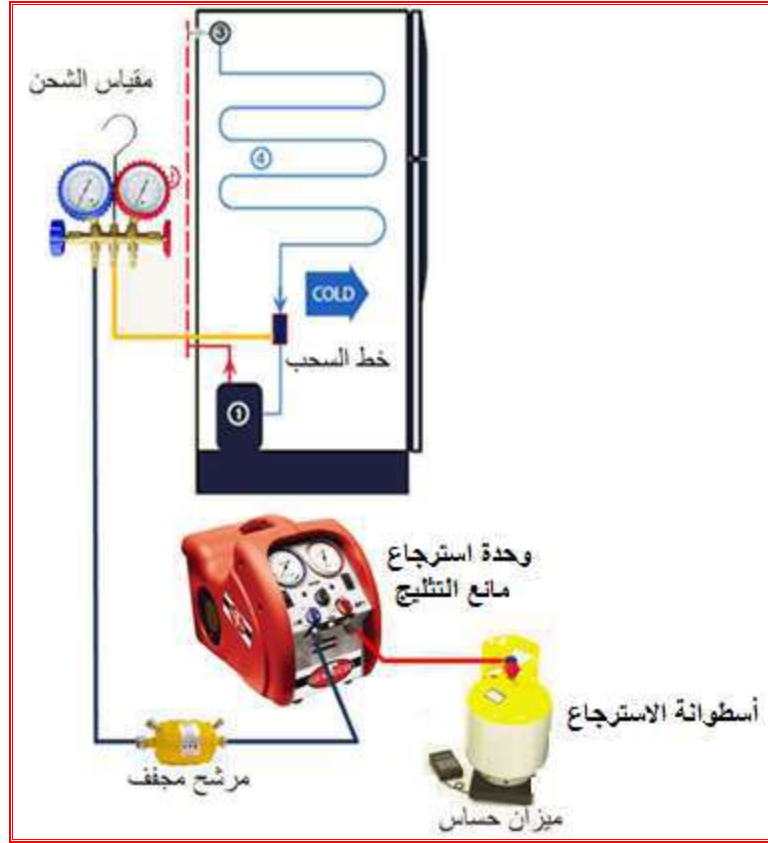
شكل 7- 26 ربط وحدة استرجاع بخار مانع التثليج
