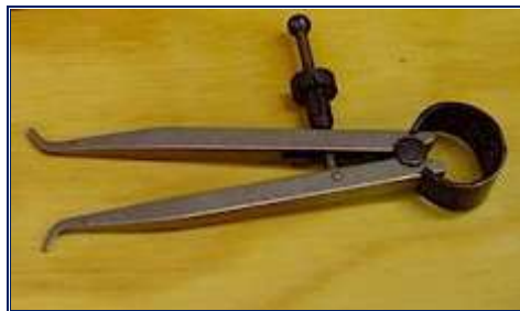
شكل 1-5 الفرجال الداخلي، يستعمل لنقل الأبعاد الداخلية
