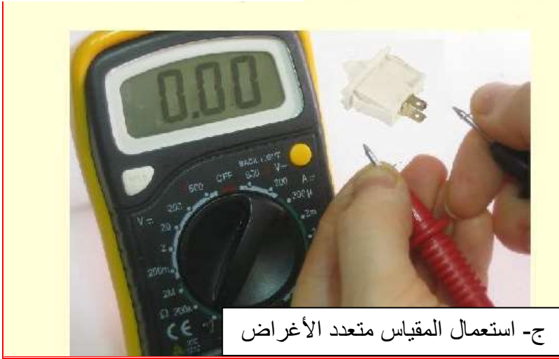
شكل 3-8 رفع وفحص مفتاح الإنارة الداخلية لمصباح ثلاجة
