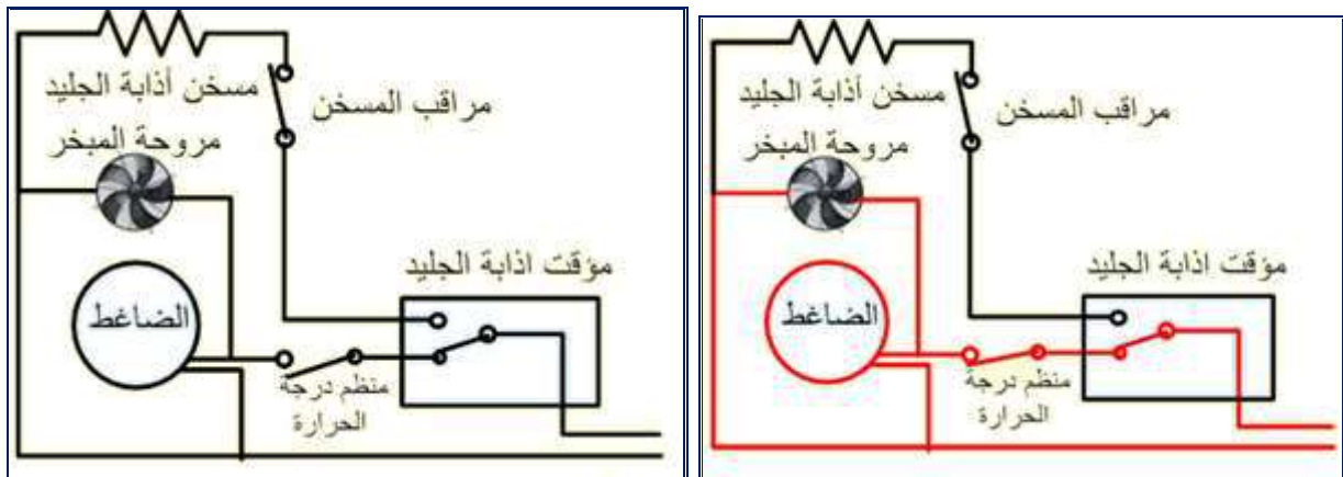
شكل 8-15 عمل الضاغط ومروحة المبخر ومؤقت إذابة الجليد
