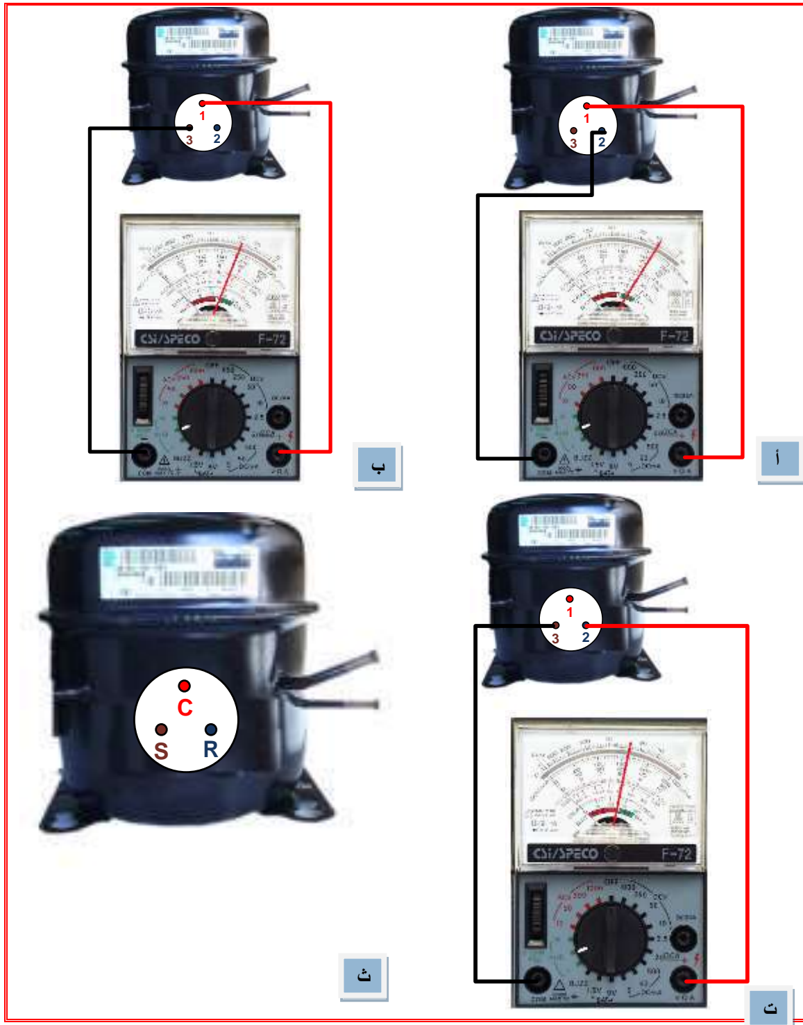
شكل 7-7 طريقة تحديد أطراف ضاغط الثلاجة
