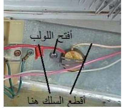
أ - فتح المسيطر ب- فحص المسيطر ج- ربط المسيطر بعد فحصه أو تبديله شكل 8-19 طريقة فحص المسيطر على مسخن إذابة الجليد وتبديله
