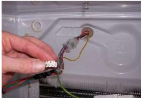
ب- انزع نقطة توصيل التيار الكهربائي
