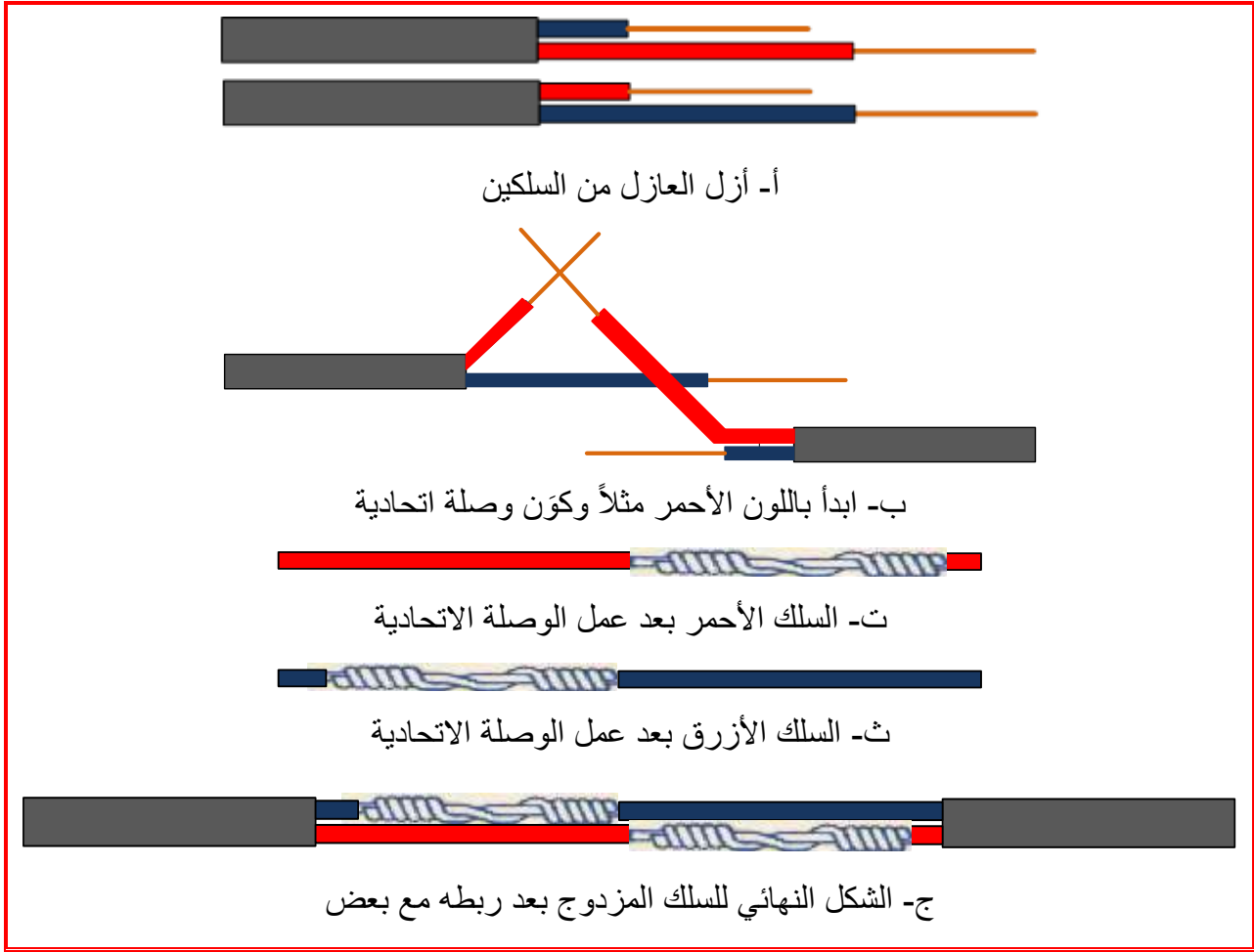
شكل 5-8 عمل وصلة مستقيمة لقابلو ثنائي الأسلاك
