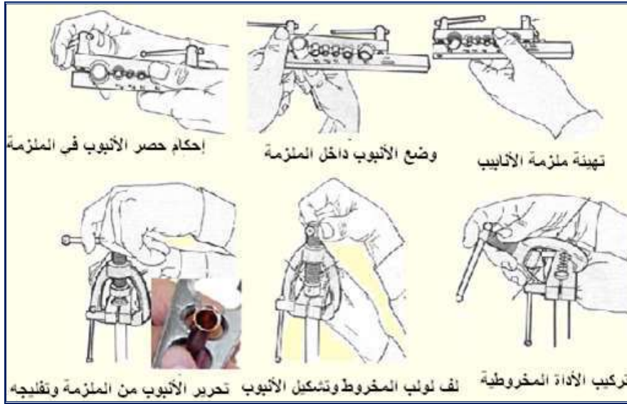
شكل 2-17 طريقة تفلج الأنابيب
