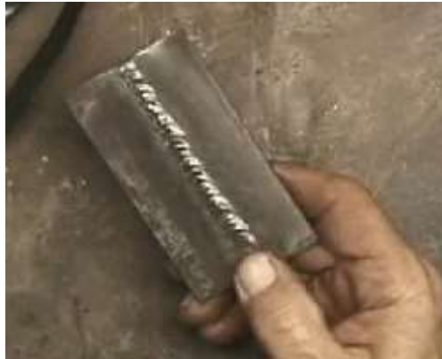
ذ- القطعتان بعد لحامهما مع بعض شكل 4-8 لحام قطعتي فولاذ برؤوس متقابلة بسلك اللحام
