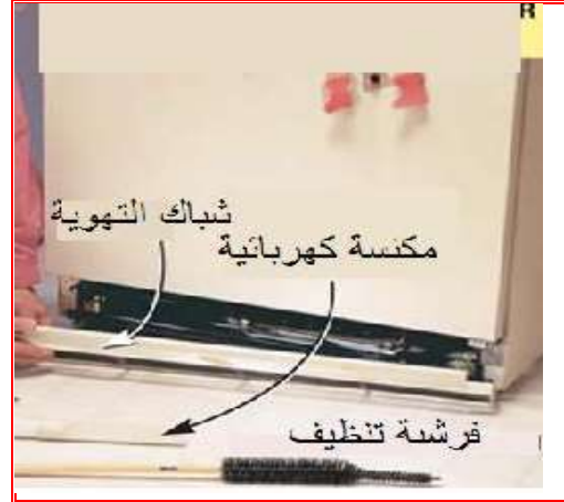
أ- فتح شباك التهوية في مقدمة الثلاجة ب - فتح الغطاء الخلفي للثلاجة شكل 7-14 تنظيف المكثف المبرد بالهواء القسري
