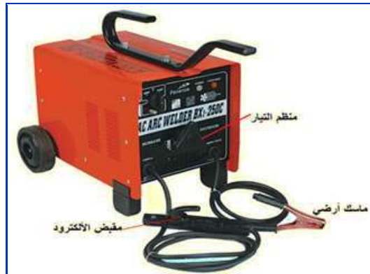
شكل 4-10 ماكينة لحام القوس الكهربائي
