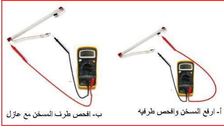
شكل 8-34 طريقة فحص المسخن الكهربائي لماكينة صنع الثلج
