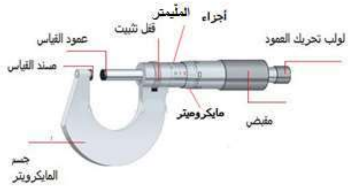
شكل 14-1 مكونات المايكرومتر
