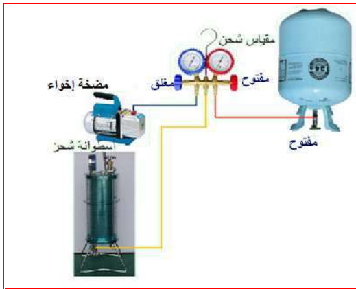
شكل 7-37 طريقة شحن أسطوانة الشحن
