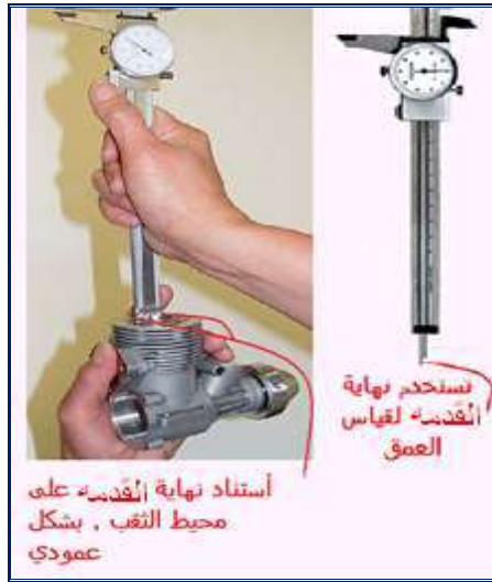
شكل 12-1 قياس العمق بواسطة القدمة
