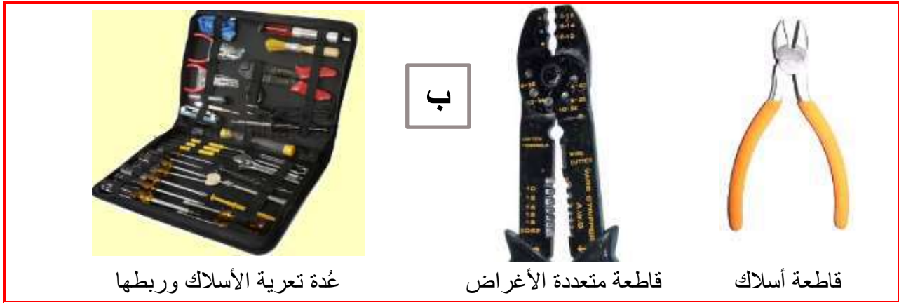
شكل 1-5 العُدّد المستعملة في تعرية الأسلاك الكهربائية (ب)
