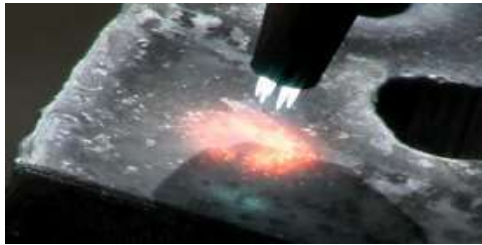
ب- استمرار التسخين وبداية انصهار المعدن
