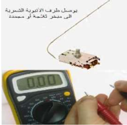
ح- استعمال المقياس متعدد الأغراض للفحص
