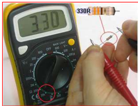
شكل 6-11 طريقة قياس المقاومة، لاحظ مؤشر المقياس
