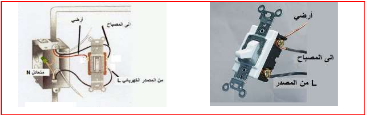
شكل 5-15 طريقة ربط مفتاح ذي ممر واحد
