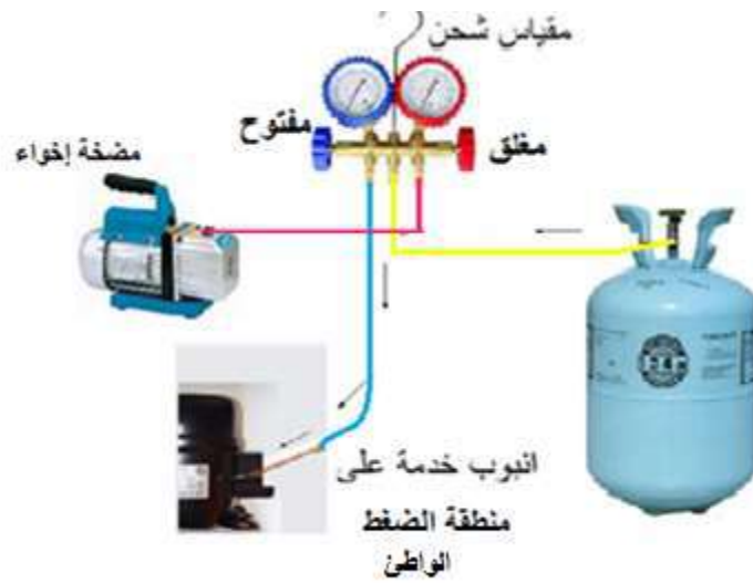
شكل 7-34 ربط مضخة الإخواء في الدورة عند الشحن عن طريق صمام خدمة (شحن غاز عند الضغط الواطي، الأسطوانة في وضعها الطبيعي)
