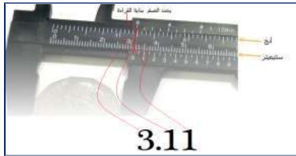
شكل 9-1 طريقة قياس الأقطار الخارجية
