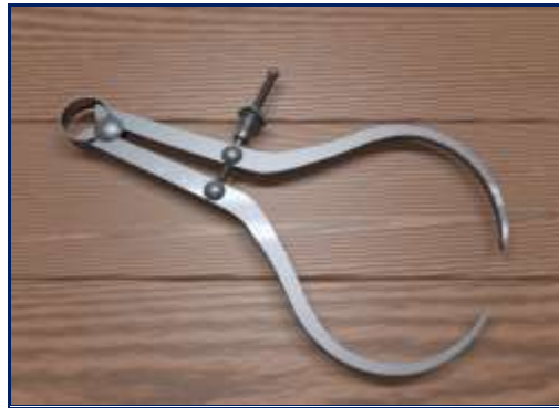
شكل 1-3 الفرجال الخارجي ، يستعمل لنقل الأبعاد الخارجية
