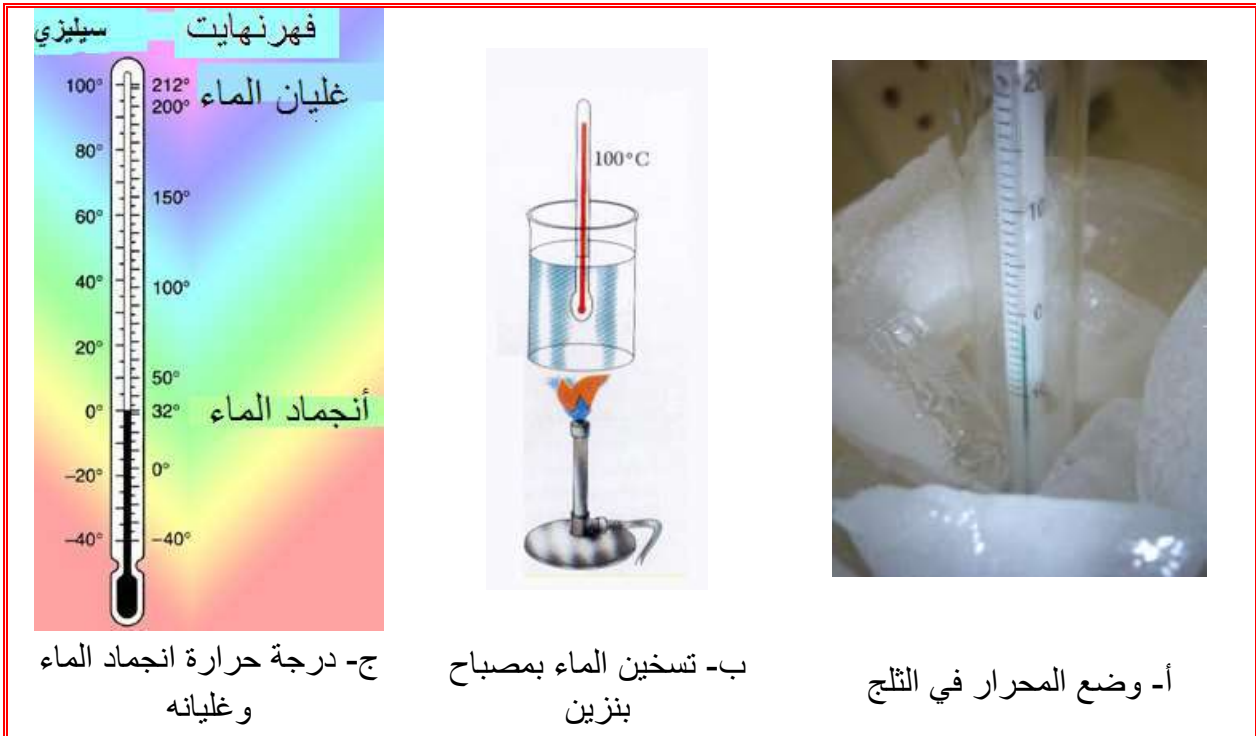
شكل 6-28 قياس درجتا حرارة انجماد الماء المقطر وجليانه
