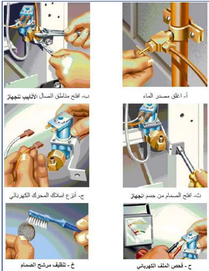
شكل 29-8 طريقة صيانة صمام ماء صناعة الثلج
