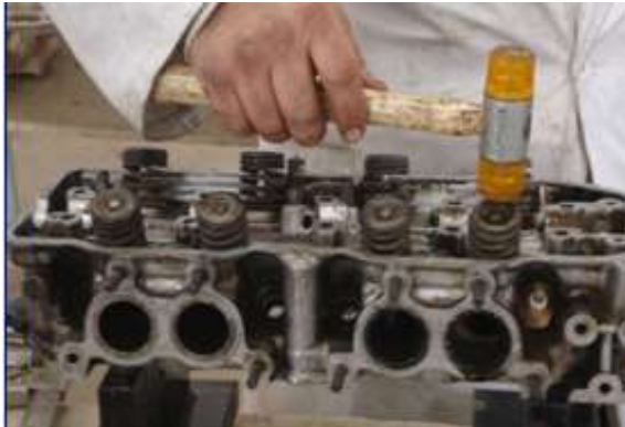
شكل ( 187 ) الطرق بالمطرقة بلاستيكية
