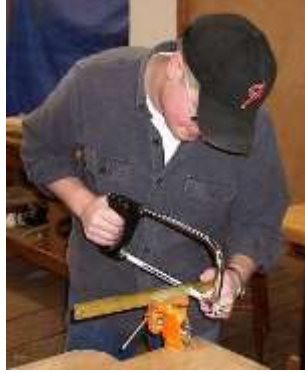
الشكل ( 85 ) طريقة استعمال المنشار .
