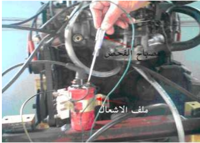
شكل (279) فحص الملف الابتدائي باستخدام مصباح الفحص
