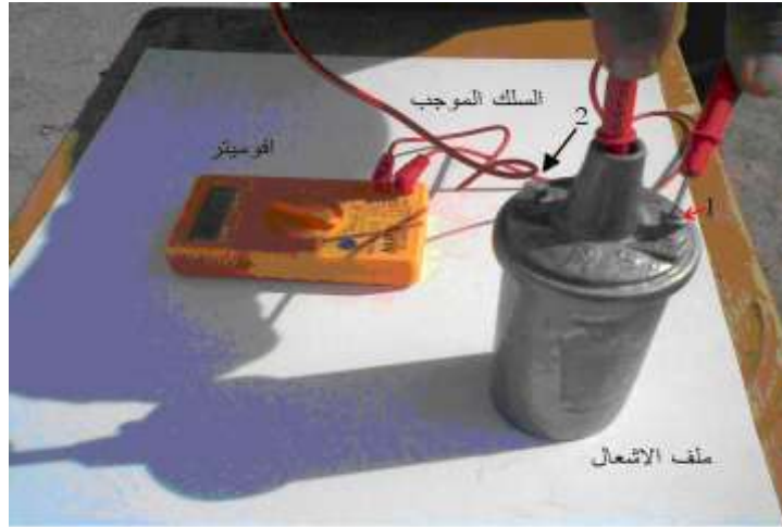
شكل (281) فحص وقياس مقاومة الملف الثانوي لملف الإشعال
