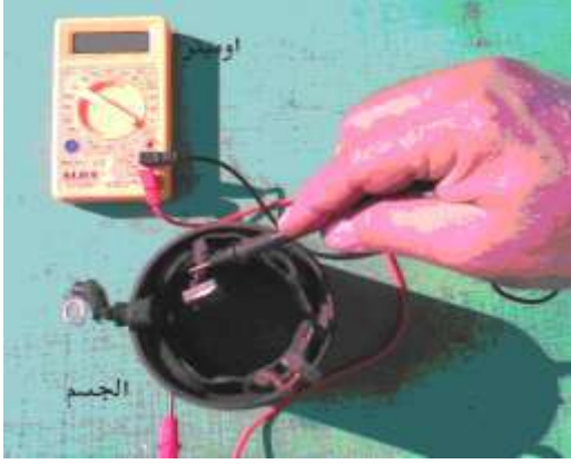
شكل (348) طريقة فحص التوصيل الأرضي
