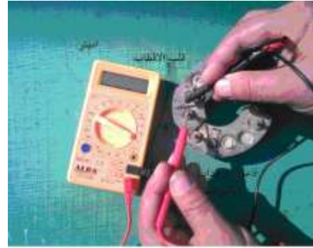
شكل (321) فحص الموحدات (الدايودات) شكل (322) قلب الأقطاب لفحص الموحدات
