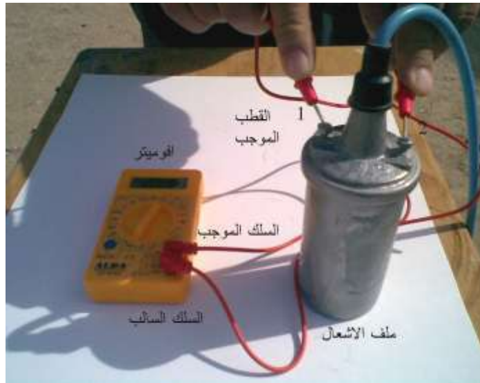
شكل (280) قياس مقاومة الملف الابتدائي بأستخدام جهاز الأفوميتر
