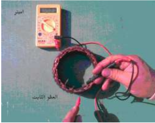
شكل (320) التأكد من عدم وجود اتصال أرضي بين الملفات وجسم العضو الثابت
