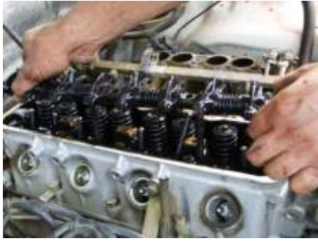
شكل (155) اخراج الأذرع المتأرجحة
