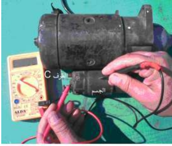
شكل (342) فحص ملف التثبيت
