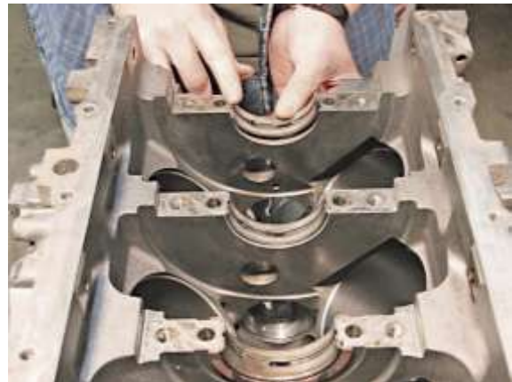
شكل (226) تثبيت سبيكة الكراسي
