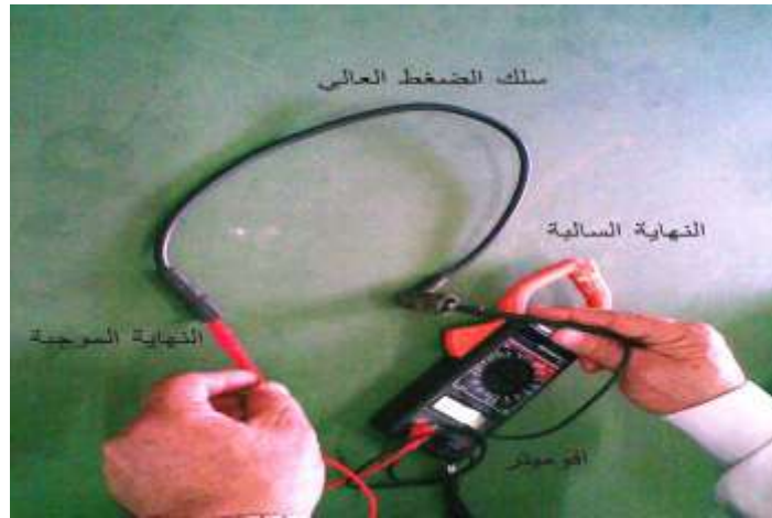
شكل (282) فحص وقياس مقاومة أسلاك الضغط العالي
