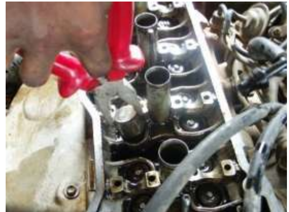
شكل (195) وضع اعمدة الدوافع الهيدروليكية
