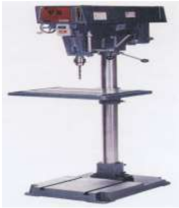
الشكل ( 97 ) مثقب كهربائي مثبت على الارض .
