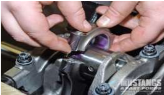
شكل (203) رفع الكراسي من ذراع التوصيل
