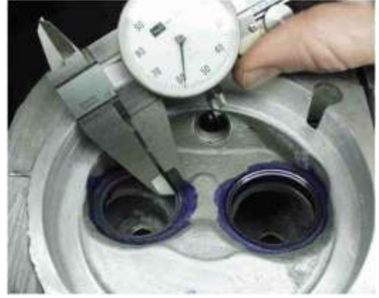
شكل (180) قياس ارتفاع قاعدة الصمام
