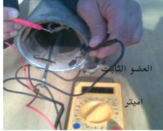
شكل (307) فحص العضو الثابت للتأكد من الاتصال بين الملفات
