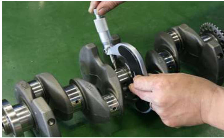
شكل ( 216 ) فحص استدارة المحور الثابت لعمود المرفق
