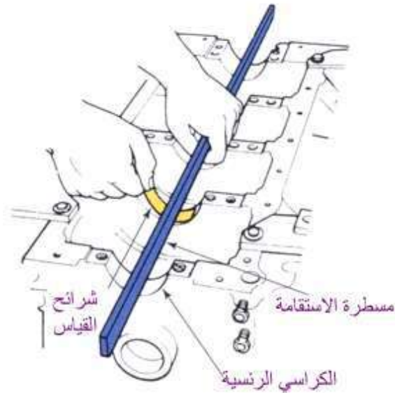
شكل (215) قياس استقامة كراسي الرئيسية كتلة الأسطوانات
