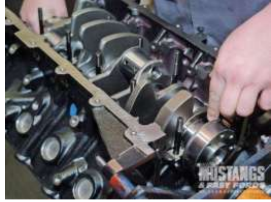
شكل (228) وضع عمود المرفق
