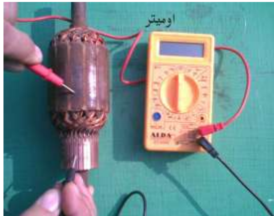
شكل (343) فحص عضو الاستنتاج
