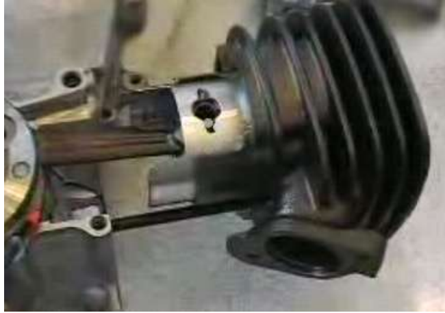
شكل ( 257 ) سحب كتلة الأسطوانة من المحرك
