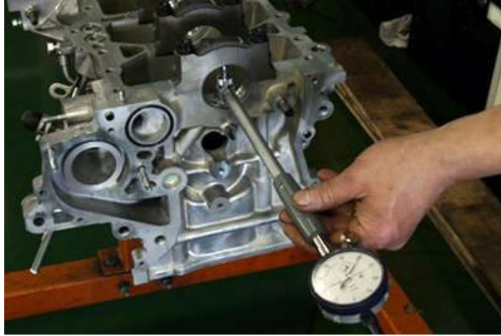
شكل (225) قياس قطر المحاور
