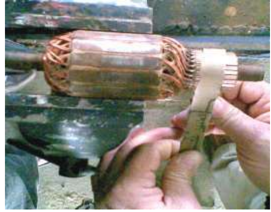
شكل (345) تنظيف عضو التوحيد
