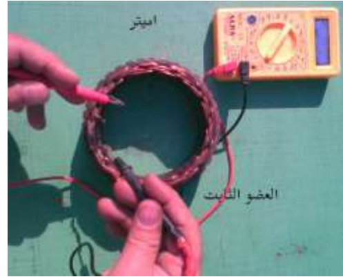
شكل (319) فحص العضو الثابت بواسطة الأوميتر للتأكد من الأتصال بين الملفات
