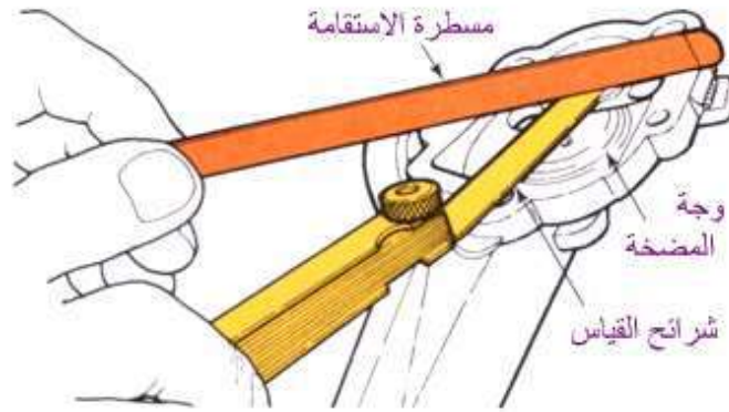
شكل (250) فحص استقامة وجه المضخة
