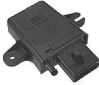
شكل (270) حساس الضغط المطلق للمدخل
