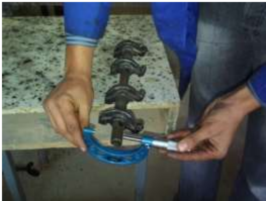
شكل (191) قياس قطر عمود المتأرجح
