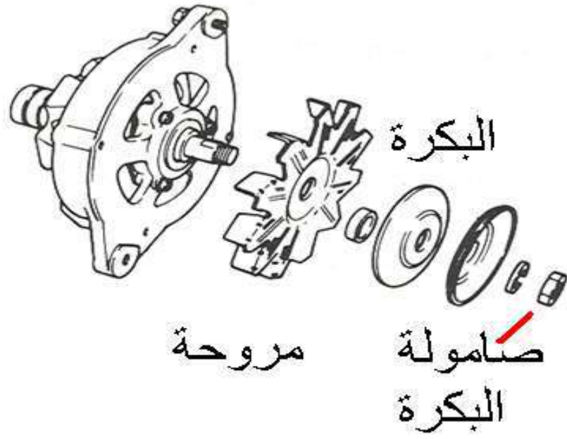
شكل (312) ترتيب الأجزاء للعضو الدوار
