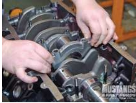
شكل (205) رفع المحاور الرئيسية لعمود المرفق
