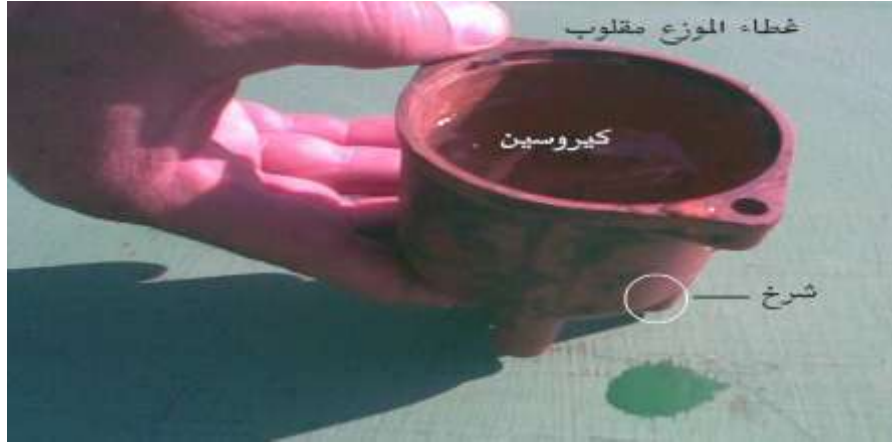
شكل (285) فحص الغطاء باستخدام الكيروسين
