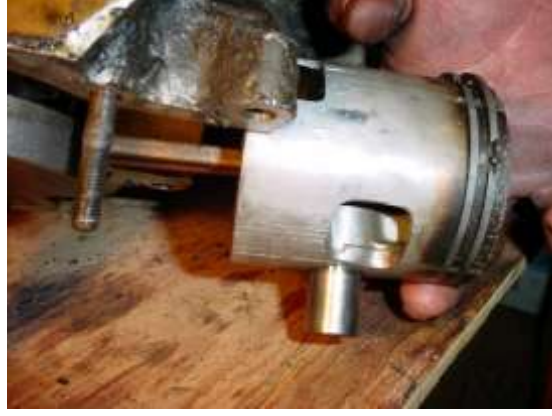
شكل (258) أخرج محور المكبس من ذراع التوصيل
