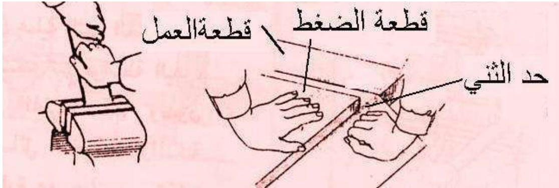
الشكل (111) طريقة الحني باليد .
