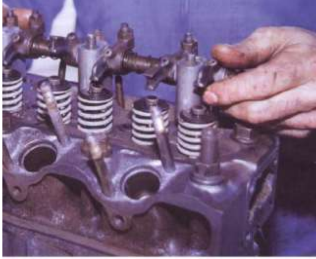
شكل (197) وضع عمود المتأرجحة
