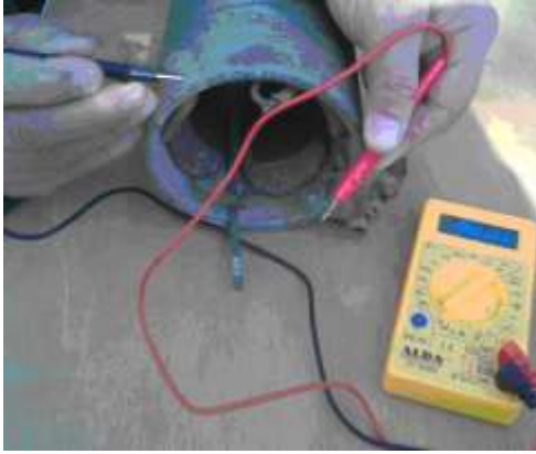
شكل (308) فحص العضو الثابت للتأكد من عدم وجود اتصال بين الملفات وجسم العضو الثابت
