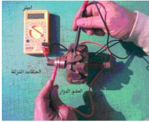
شكل (316) فحص العضو الدوار للتأكد من عدم وجود اتصال بين الحلقات والجسم
