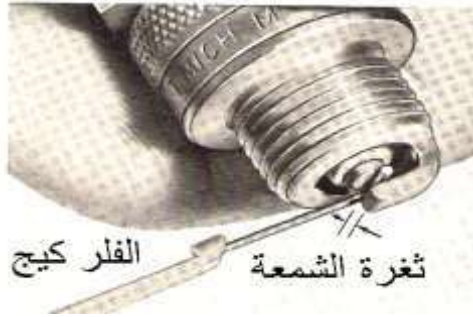
شكل (287) إستخدام المقياس في تحديد مقدار ثغرة شمعة الإشعال.
