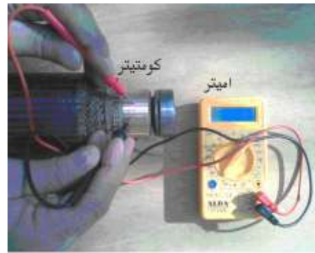
شكل (303) فحص الموحد للتأكد من عدم وجود اتصال بين القطع النحاسية
