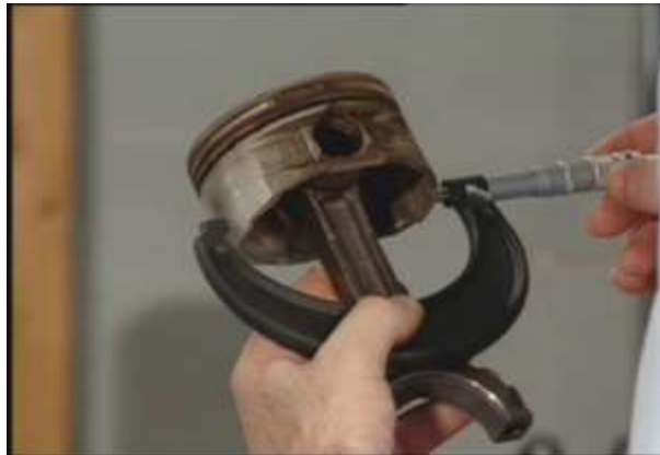
شكل (219) قياس التآكل في قطر المكبس
