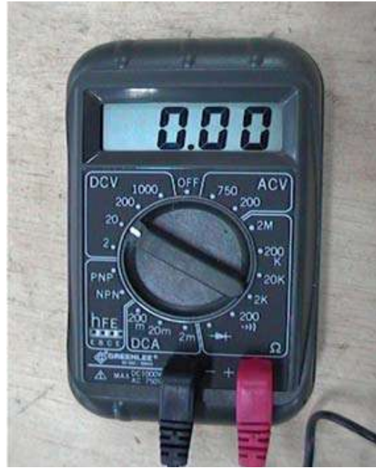
شكل (354) تهيئه الفولتميتر
