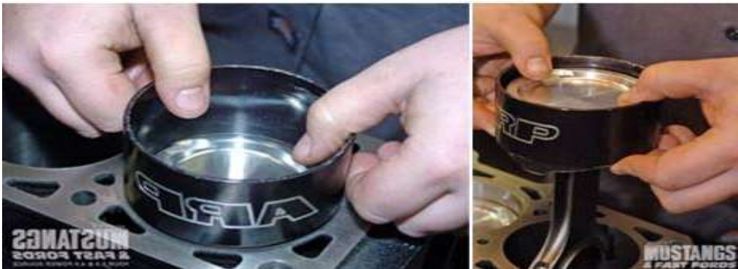
شكل ( 238 ) أ لة حصر حلقات المكبس
