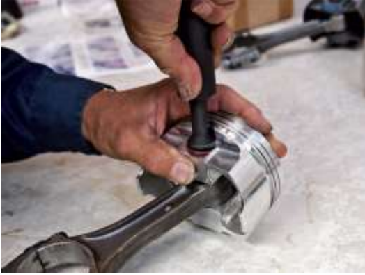
شكل (209) أخراج محور المكبس
