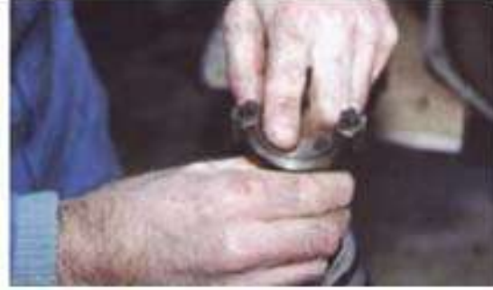
شكل (204) نزع الكراسي لذرع التوصيل
