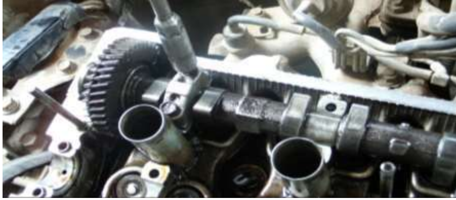
شكل (153) فتح الأغطية لعمود الحدبات
