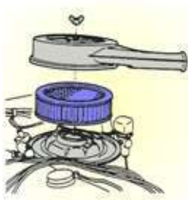
شكل (148) فتح مصفي الهواء
