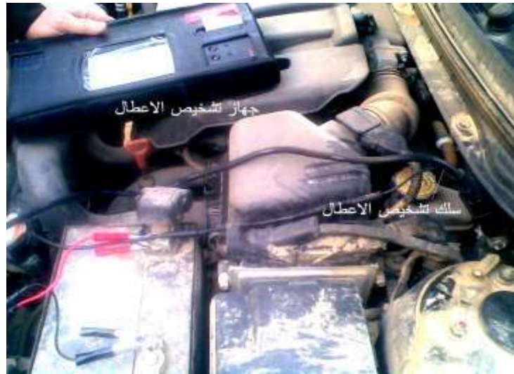
شكل (297) ربط جهاز تشخيص الأعطال
