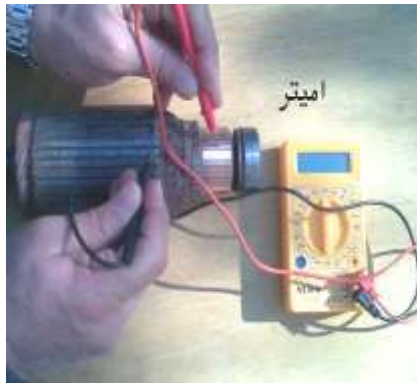
شكل (304) فحص العضو الدوار والتأكد من عدم وجود اتصال بين القطع النحاسية والجسم
