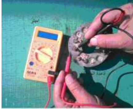
شكل (321) فحص الموحدات (الدايودات) شكل (322) قلب الأقطاب لفحص الموحدات
