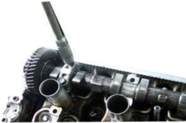
شكل (196) وضع عمود الحذبات
