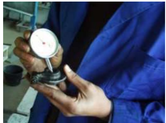
شكل ( 190 ) قياس قطر الذراع المتأرجحة
