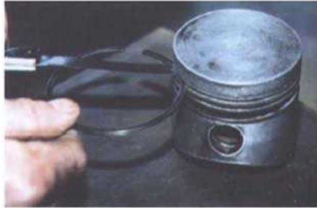
شكل ( 220 ) قياس زيادة الخلووص الجانبي لمجاري حلقات المكبس
