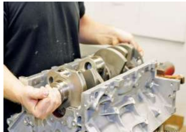
شكل (206) اخراج عمود المرفق
