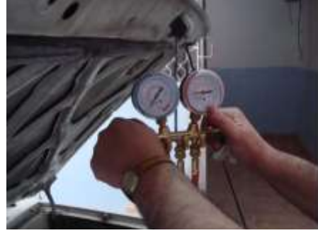
شكل رقم (406) طريقة قفل الصمامين
