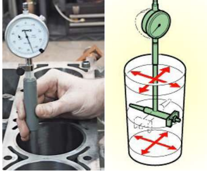
شكل (212) قياس الأتساع في قطر الأسطوانة
