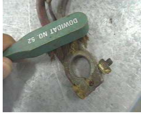
شكل (364) تنظيف أطراف توصيل البطارية شكل (365) تنظيف سطح البطارية
