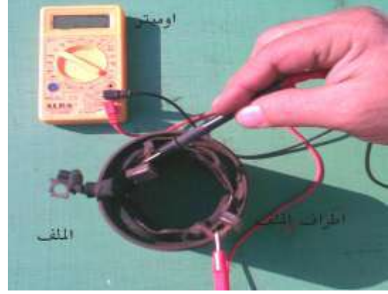
شكل (347) طريقة فحص التوصيل لملف بادئ الحركة
