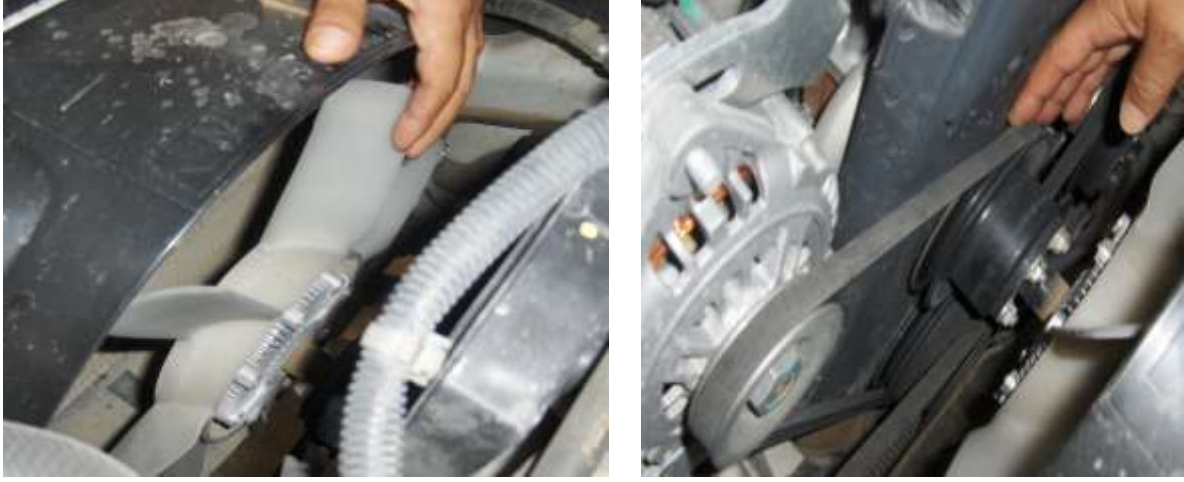
الشكل ( 10 ) فحص الأحزمة الناقلية للحركة .
