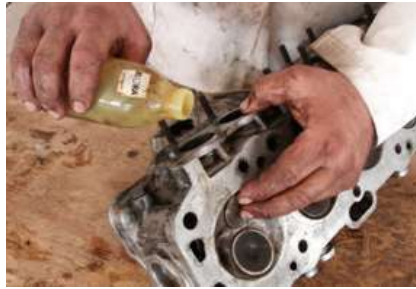
شكل (185) سكب النفط الأبيض في غطاء الأسطوانة
