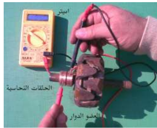
شكل (315) فحص العضو الدوار للتأكد من الأتصال بين الحلقات
