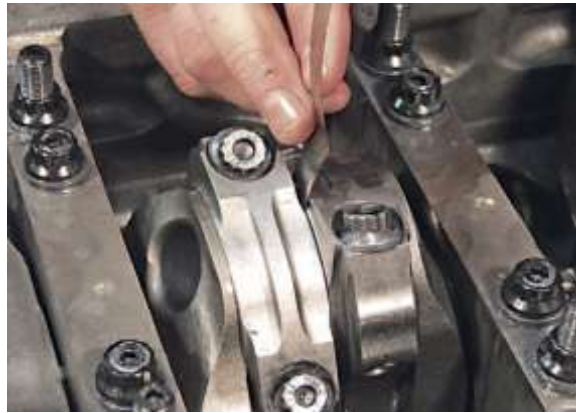
شكل (218) قياس الخلوص الجانبي لعمود المرفق
