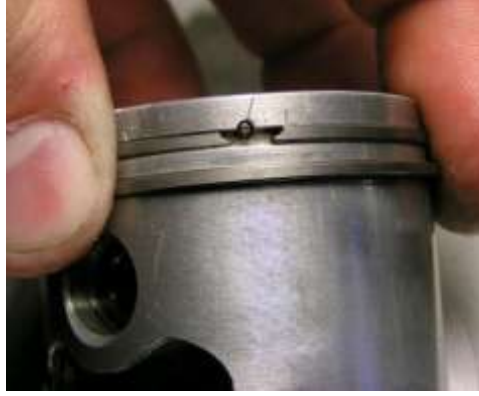
شكل ( 260 ) اختلاف جهة ثغرة الحلقات
