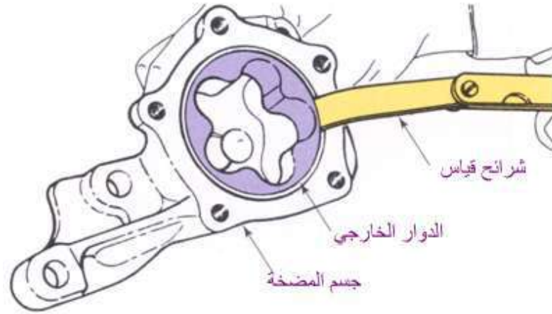
شكل (246) فحص الخلوص الدوار الخارجي وجسم المضخة
