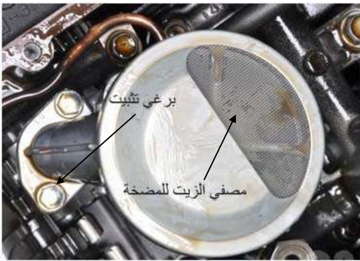
شكل ( 200 ) فتح مضخة الزيت
