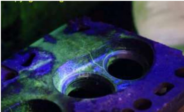
شكل (168) فحص الغطاء بالأشعة السينية
