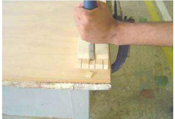
8. استخدم إزميل مشطوف قياس 12 ملم لتفريغ الأجزاء المستهلكة .
