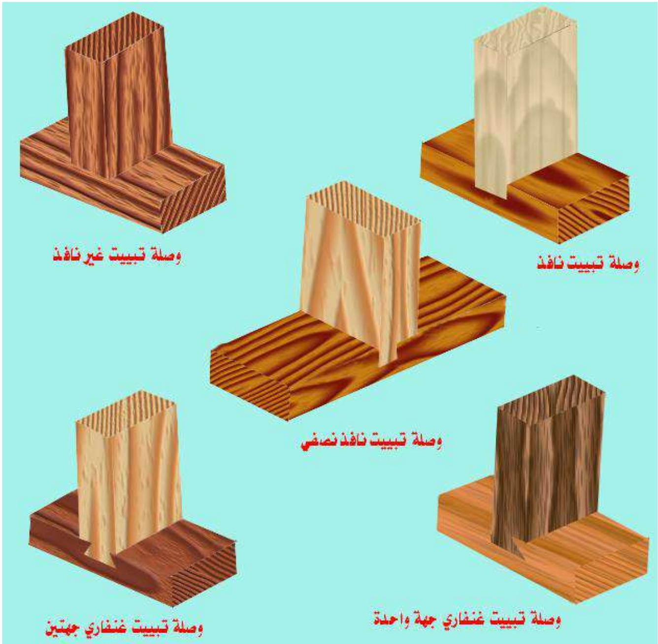
شكل رقم (1- 4) يبين انواع وصلات التبييت
