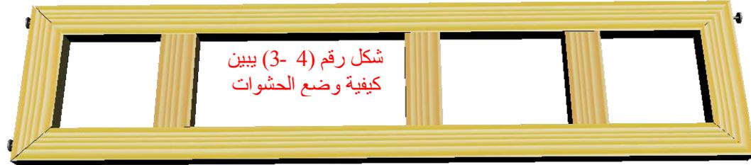
شكل رقم (4 - 3) يبين كيفية وضع الحشوات
