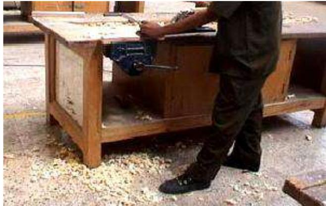
شكل رقم (2- 69) يبين كيفية مسك الرنذة عند بدأ المسح
