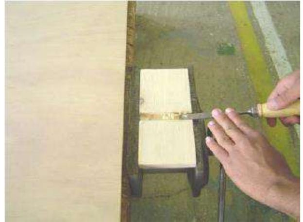
7. استخدم أزميل مشطوف قياس 12 ملم لتفريغ منطقة التثبيت .
