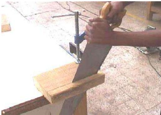
شكل رقم (2 - 37) يوضح طريقة نشر قطعة خشب
