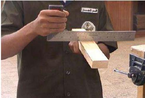
شكل (2-70) يبين كيفية ضبط استواء الأسطح بالزاوية
