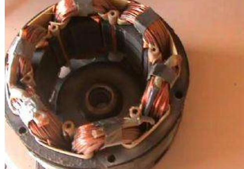
13- ملفات المحرك الكهربائي
