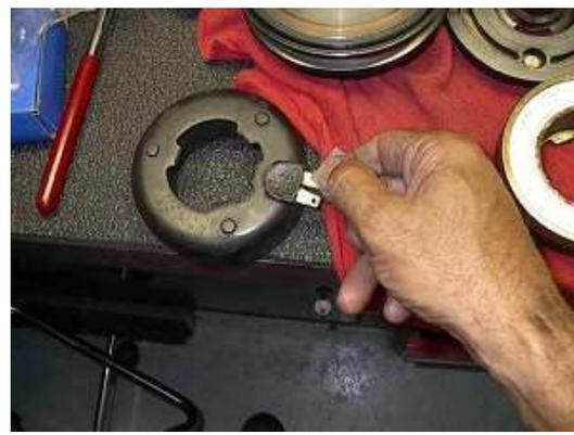
17- نظف أطراف ملف المغناطيس الكهربائي
