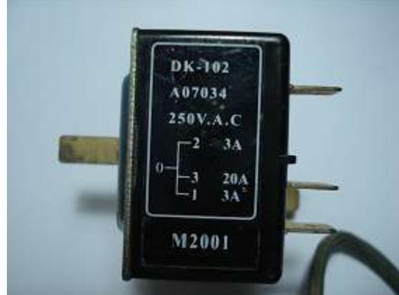
2- مفتاح انتقائي لمكيف بسرعتين، إذ إن النقطتين 1 و2 هي للمروحة، لأن التيار الأقصى المسموح به هو 3 أمبير، في حين أن النقطة 3 مخصصة للضاغط، لأن التيار الأقصى المسموح به هو 20 أمبير. ويلاحظ من الشكل إن النقطة 4 خالية من نقطة التوصيل
