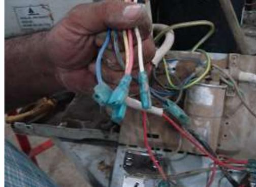
8- إسحب الأسلاك الكهربائية لمحرك المروحة
