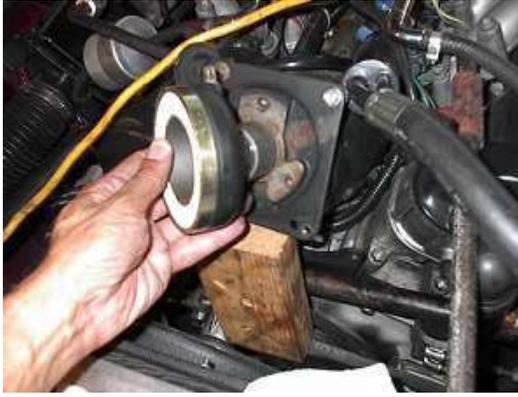
14 - ارفع المغناطيس الكهربائي من مكانه
