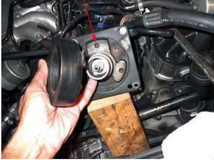
2- أرجع المغناطيس الكهربائي إلى مكانه.
