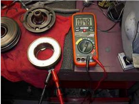
18- افحص صلاح ملف المغناطيس الكهربائي
