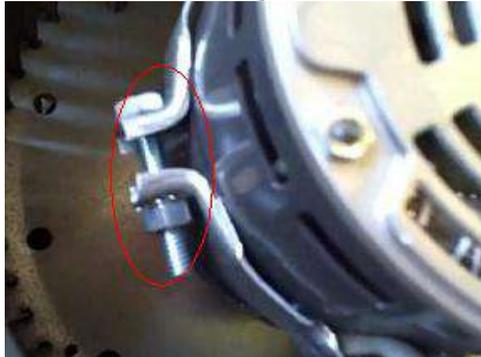
10- لولب تثبيت المحرك الكهربائي بالقاعدة
