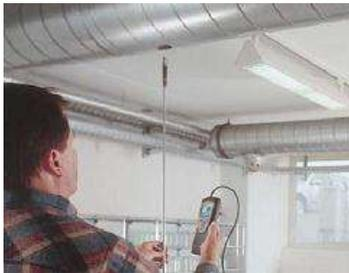
4- قياس سرعة الهواء خلال مجرى الهواء
