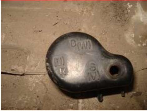
2- غطاء التوصيلات الكهربائية وأشرت عليه أطراف الربط
