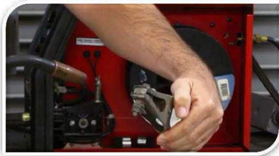
شكل 2-10 توصيل قطبي التيار الكهربائي
