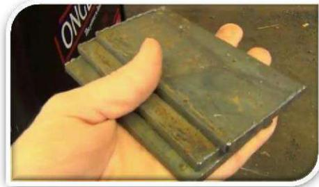
2. اقطع قطعاً من الفولاذ الكربوني قياس  $80 \times 30 \times 60$  mm بواسطة المقص الهيدروليكي أو الكهربائي مراعي السلامة المهنية عند العمل بعد التخطيط بواسطة المسطرة والشنكار.
