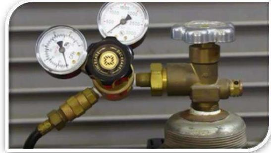
شكل 2-9 ربط منظم الغاز بجهاز التغذية
