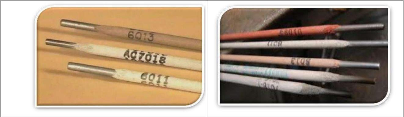
شكل 1-3 بعض أقطاب اللحام من الفولاذ منخفض الكربون والفولاذ منخفض السبك حسب نظام
