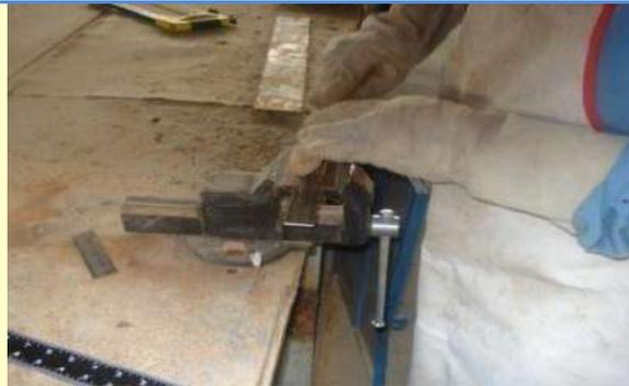
3. نظف قطعتين التمرين من الصدا بالفرشاة السلكية لتأمين التوصيل الجيد للتيار الكهربائي القوس الكهربائي بين القطعة وسلك اللحام.
