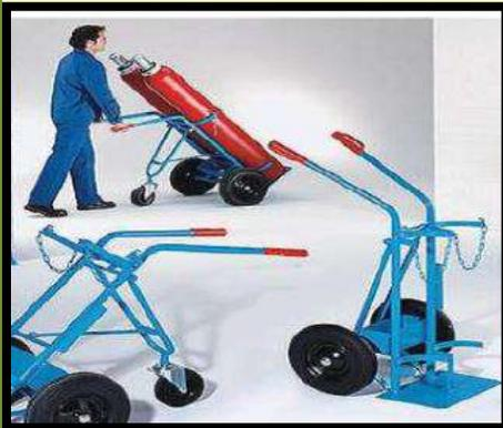
17. لايجوز استعمال الرافعات الكهربائية والتي تستعمل معدات الرفع المغناطيسية لنقل الاسطوانات ولا يتم سحب الاسطوانات على ارضية الورش وانما يجب دحرجتها بهدوء وتفادي سقوطها وارتطامها باخرى بقوة في عمليات النقل.
