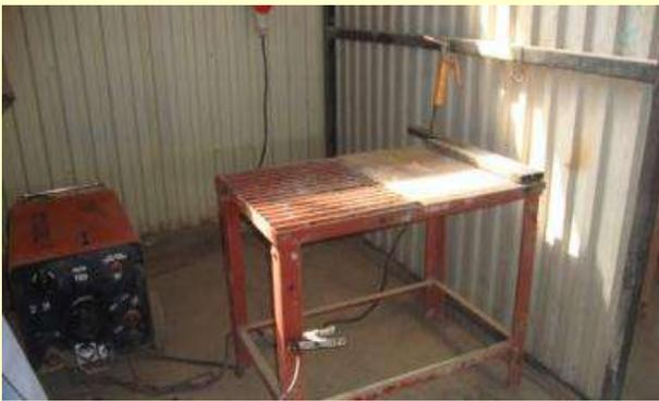
7. ضع سلك اللحام (Electrode) في مقبض اللحام الذي يكون بمثابة القطب الموجب والتأكد من ربط منضدة العمل بالقطب السالب بشكل جيد وذلك للتأكد من عدم تسرب الشحنات الكهربائية منه.
