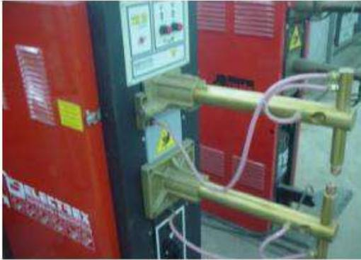
5. اضبط مفتاح التشغيل على التيار المناسب بحسب سمك الصفائح ونوعية المعدن والزمن  $0,45 \text{ sec}$  ثانية
