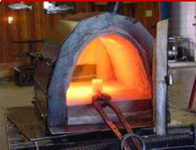
2. الكور أو فرن تسخين المعدن : وهو حسب مامتوافر من الوقود السائل - الغازي - الكهربائي، وبدرجات الحرارة المطلوبة.
