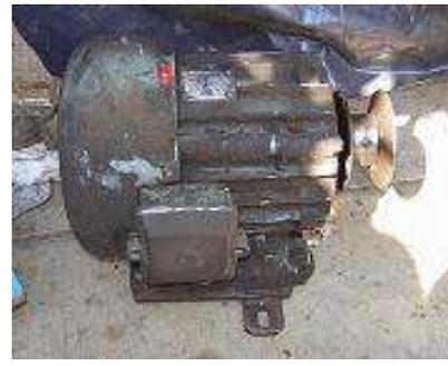
1- المحرك الكهربائي قبل التنظيف
