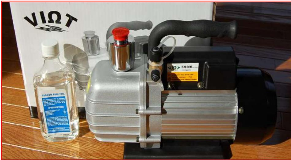
شكل 1-5 بعض من أدوات التفريغ وإزالة الرطوبة
