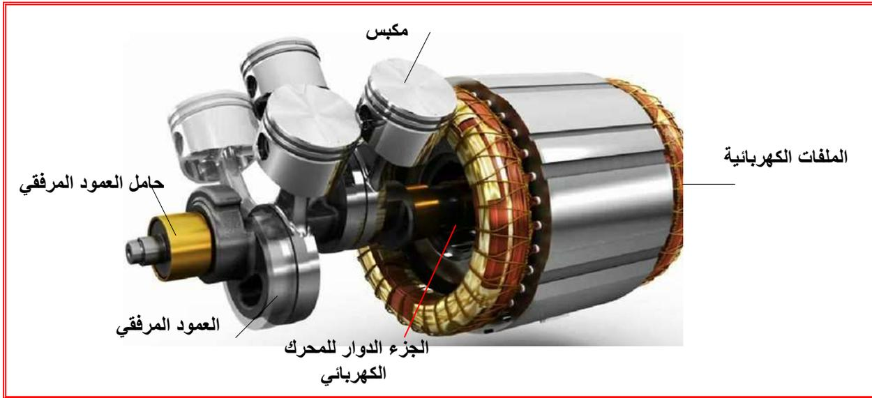
شكل 2-3 ربط العمود المرفقي بالجزء الدوار للمحرك الكهربائي
