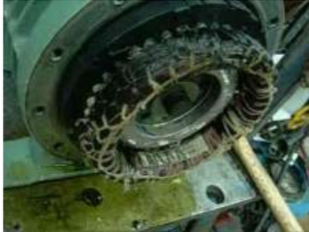
8-الملف الكهربائي لمحرك الضاغط
