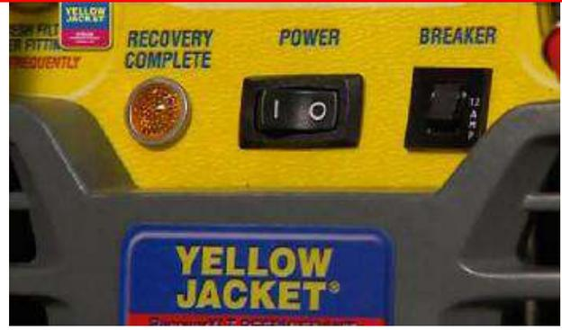
17- أطفئ التيار الكهربائي عن المجموعة
