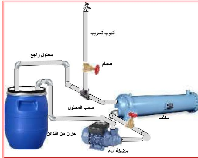
شكل 3-20 شبكة الأنابيب لتنظيف المكثف المبرد بالماء باستخدام مضخة ماء
