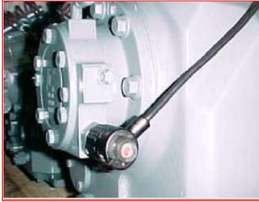
شكل 10-4 ربط قاطع وقاية انخفاض ضغط الزيت بالضاغط
