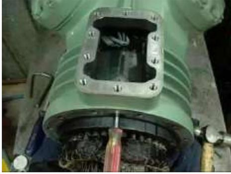
12- إزالة الخابور الذي يثبت الملف الكهربائي
