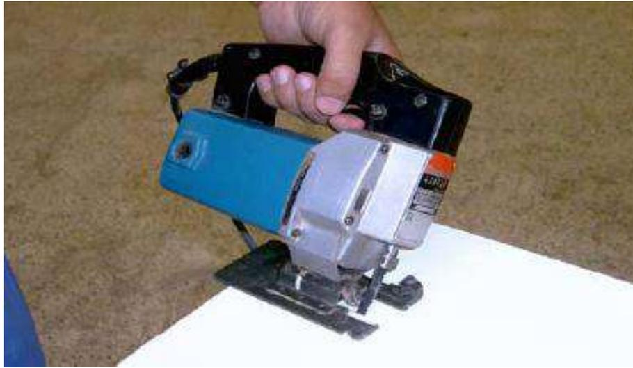
شكل (2 - 15) يوضح كيفية تنفيذ النشر المائل
