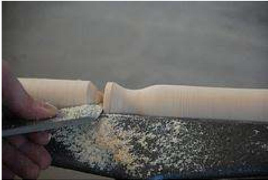
شكل (1 - 106) يوضح عمل الأزميل ذو الحد المائل
