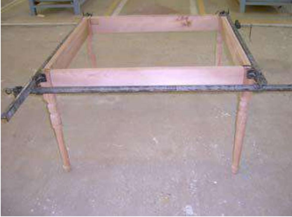
شكل (3 - 86) يوضح تجميع الطاولة وربطها بالمرابط
