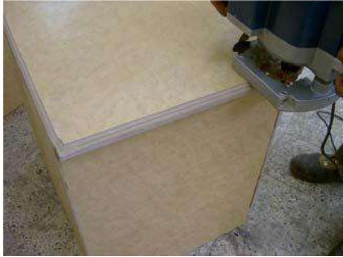
**شكل (3 - 63) يوضح استعمال الفريزة الكهربائية لعمل الحلية**
