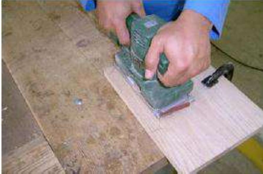
شكل (2 - 61) يوضح عملية التنعيم بجهاز الصنفرة
