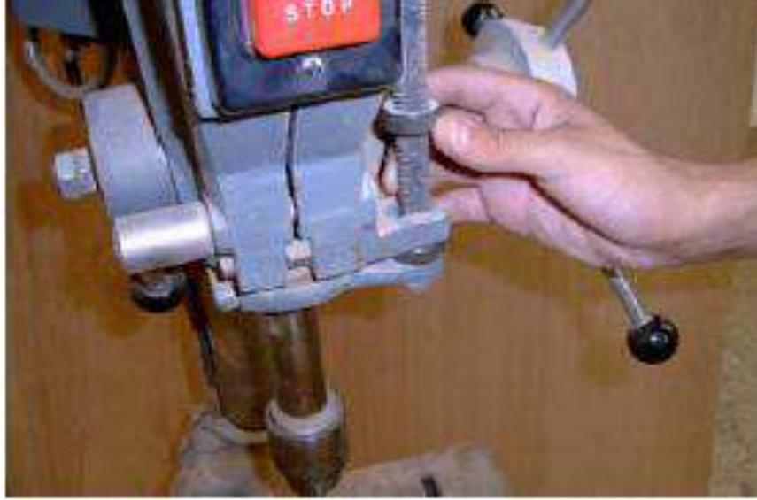
شكل (1 - 78) يوضح كيفية ضبط عمق الثقب بواسطة محدد العمق
