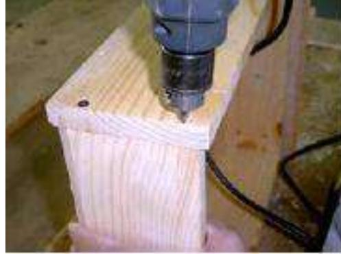
شكل (3 - 46) يوضح عملية تجميع أجزاء الجرار بالبراغي
