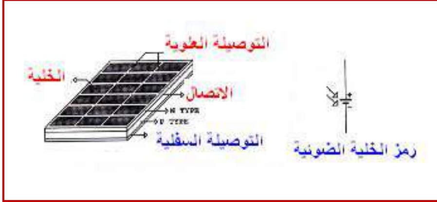
الشكل ( 1 – 2 ) تركيب الخلية الضوئية ورموزها
