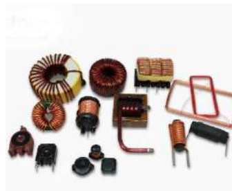
الشكل (5-4) ملف ذو قلب من مسحوق حديدي
