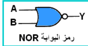
الشكل ( 7 - 9 ) رمز البوابة NOR وجدول الحقيقة
