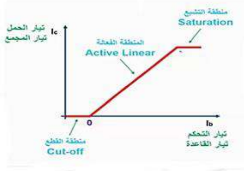
الشكل ( 6 - 7 ) نقطتي القطع والتوصيل للترانزستور
