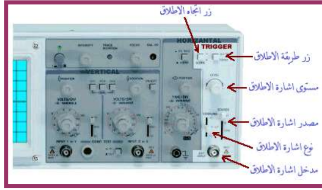
الشكل ( 1 - 16 ) مفاتيح الاطلاق لراسم الاشارة
