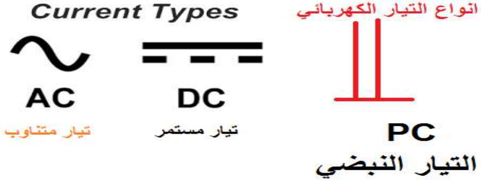
الشكل ( 1 - 9 ) اشارة التيار المستمر والمتناوب والنبضي
