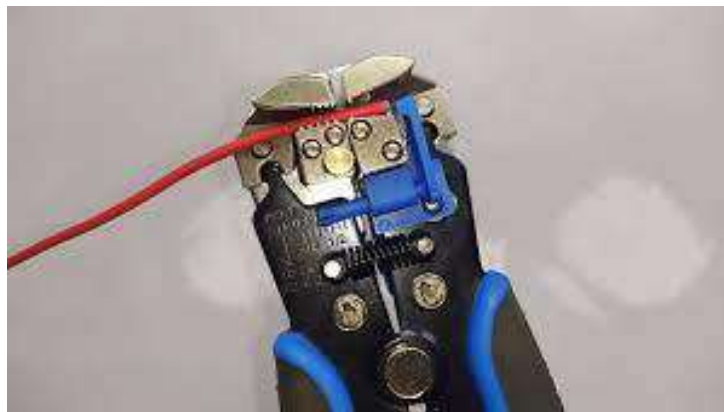
الشكل ( 1 - 25 ) أنواع مختلفة من الأسلاك ، و أداة قشط الأسلاك
