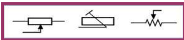
الشكل (2 - 11) رموز واشكال المقاومة المتغيرة
