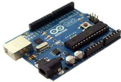
الشكل (7 - 11) يوضح لوح الـاردوينو
