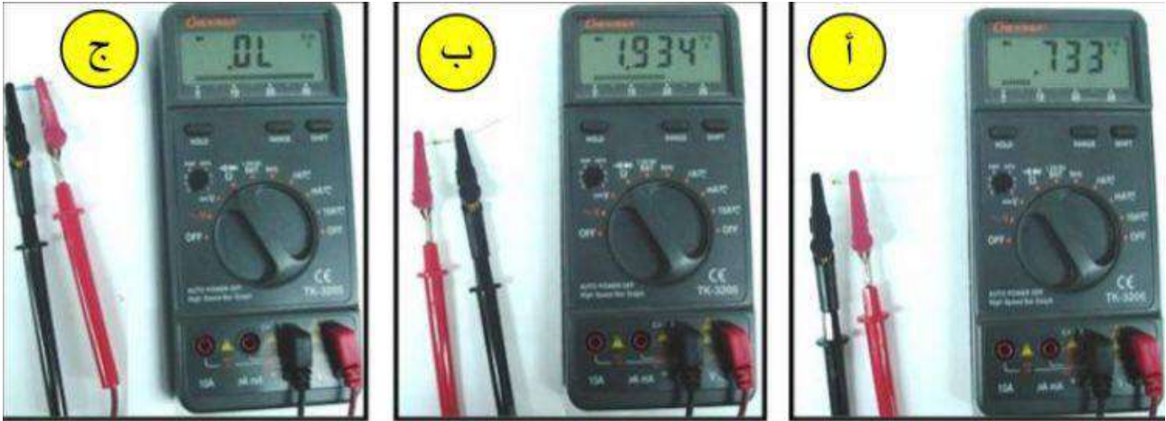
الشكل رقم ( 5 - 6 ) فحص ثنائي الزينر
