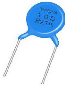
الشكل (2-13) مقاومة جهديه
