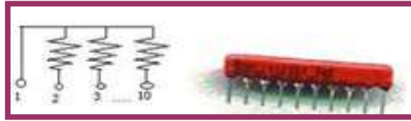
الشكل (2 - 8) المقاومة الشبكية
