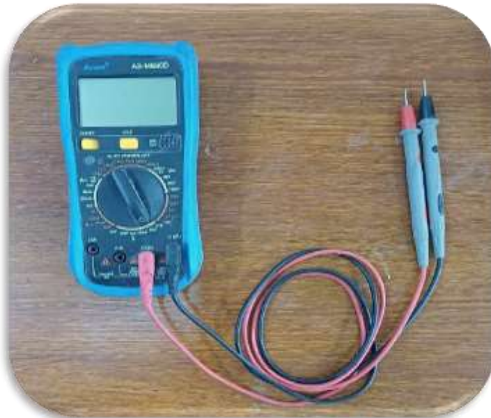
جهاز قياس التيار والجهد والمقاومة (Avo meter)
