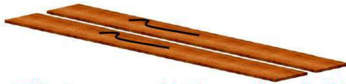
شكل (1 - 41) يوضح كيفية تحديد وجه وجوانب القائمتين
