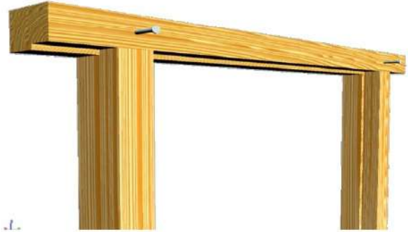
شكل (1 - 11 أ) يبين كيفية تجميع الإطار
