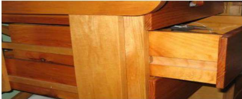
شكل (5 - 22) يبين السلك الخشبية لحرية الجرار
