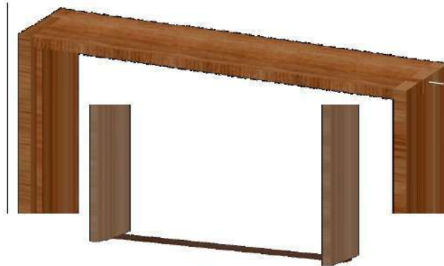
شكل (1 - 48) يبين كيفية تركيب العارضة الرأسية مع القائمتين وتثبيت القائمتين من الأسفل
