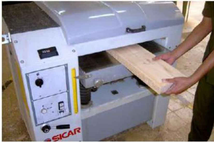
شكل (1 - 4) يبين كيفية ضبط السمك
