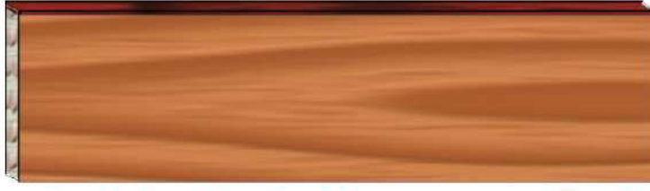
شكل (3 - 7) يبين كيفية وضع القبلمة لحافة الجنب أو القواطع
