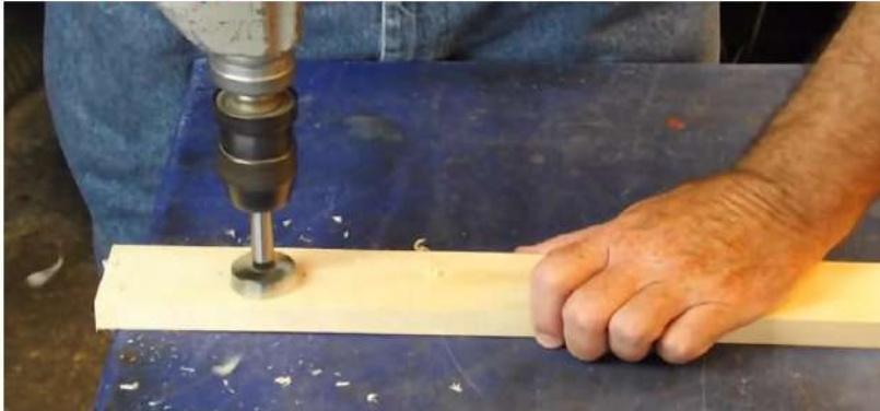
الشكل (5 - 8) يبين لنا كيفية عمل ثقب المفصلات
