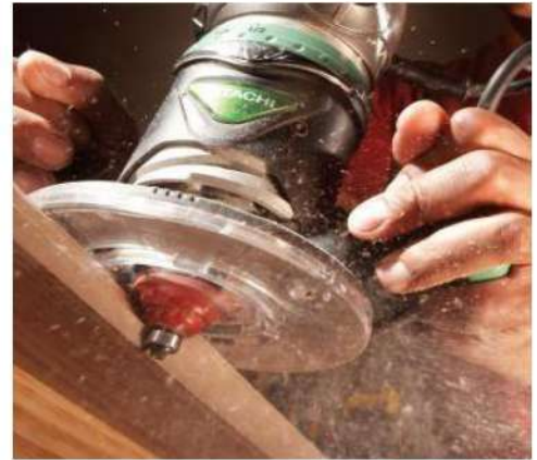
شكل (2 - 14) يبين رأس الحلية وحركة الماكينة
