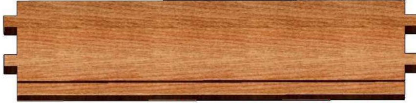
شكل (1 - 46) يبين شكل العارضة الرأسية بعد استخراج الألسن
