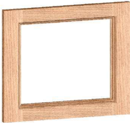
شكل (2 - 15) يبين شكل الحلية النهائي على وجه الباب
