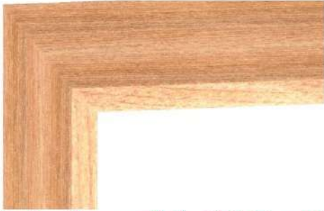
شكل (2 - 3) يبين كيفية اتصال الرؤوس على زاوية 45
