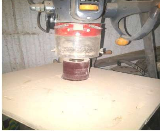
شكل (4 - 15) يبين اسطوانة التنعيم مثبتة في المثقاب العمودي
