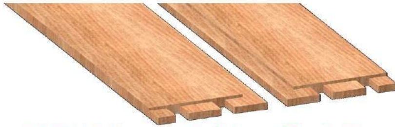
شكل (1 - 47) يبين شكل القائمتين بعد عمل الدكة (الركبة)
