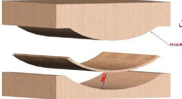
شكل (2 - 26) يبين قالب الباب الدائري وشكل الباب بعد الكبس
